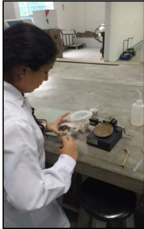
Figura 28: Ensayo realizado en laboratorio de la UCV- Plasticidad del suelo
