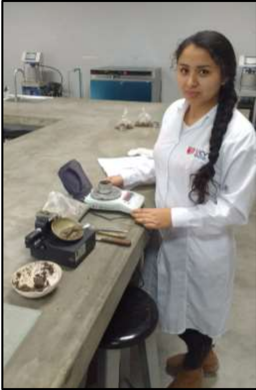
Figura 27: Ensayo realizado en laboratorio de la UCV- Plasticidad del suelo
