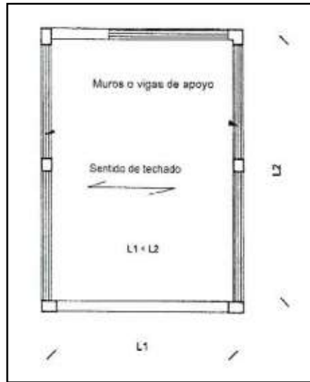
Figura 10: Sentido de techado
