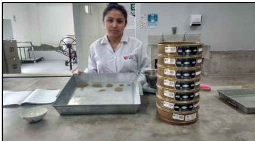
Figura 26: Ensayo realizado en laboratorio de la UCV- Análisis Granulométrico
