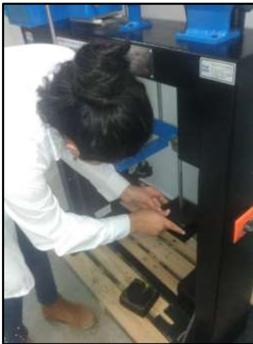
Figura 29: Ensayo realizado en laboratorio de la UCV- Corte Directo
