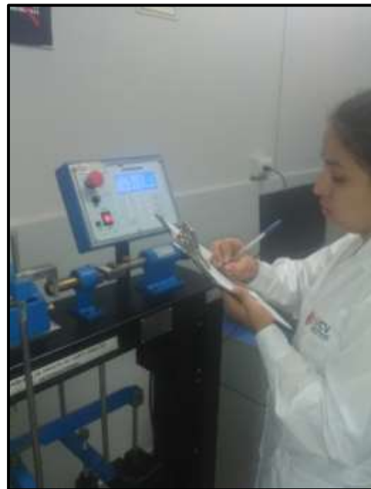
Figura 30: Ensayo realizado en laboratorio de la UCV - Registrando datos Corte Directo
