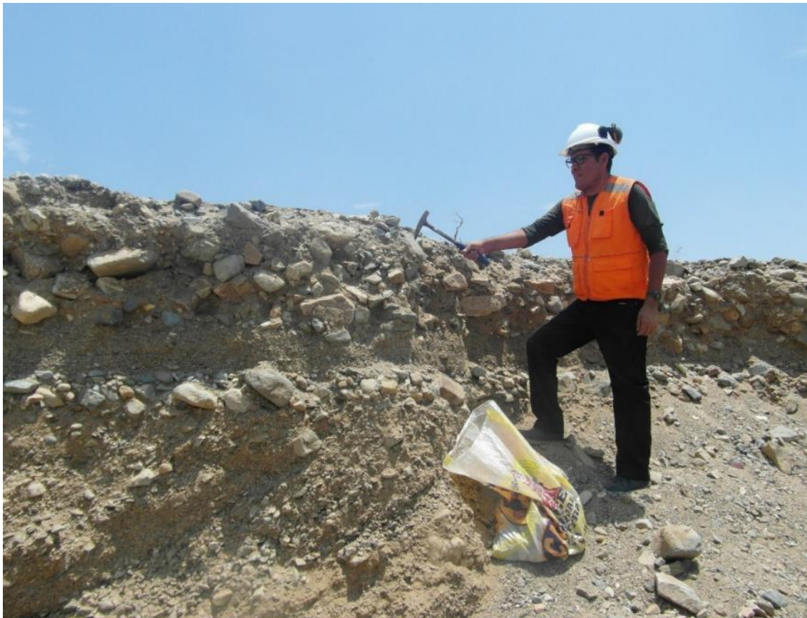
Figura 6: Sacado de muestras por estratos de las trincheras en la cantera R.B, Ferreñafe.
