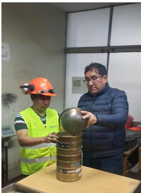
Ensayo de lab. para Análisis Granulométrico de los agregados del concreto celular
