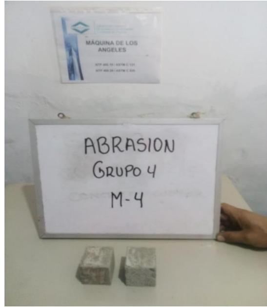
Ensayo de Desgaste mecánico de la M4 (Maquina Los Ángeles)
