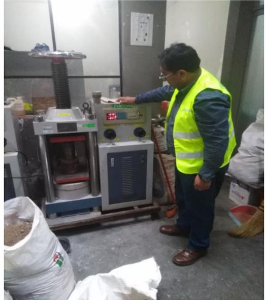
Ensayos de Resistencia a la compresión
