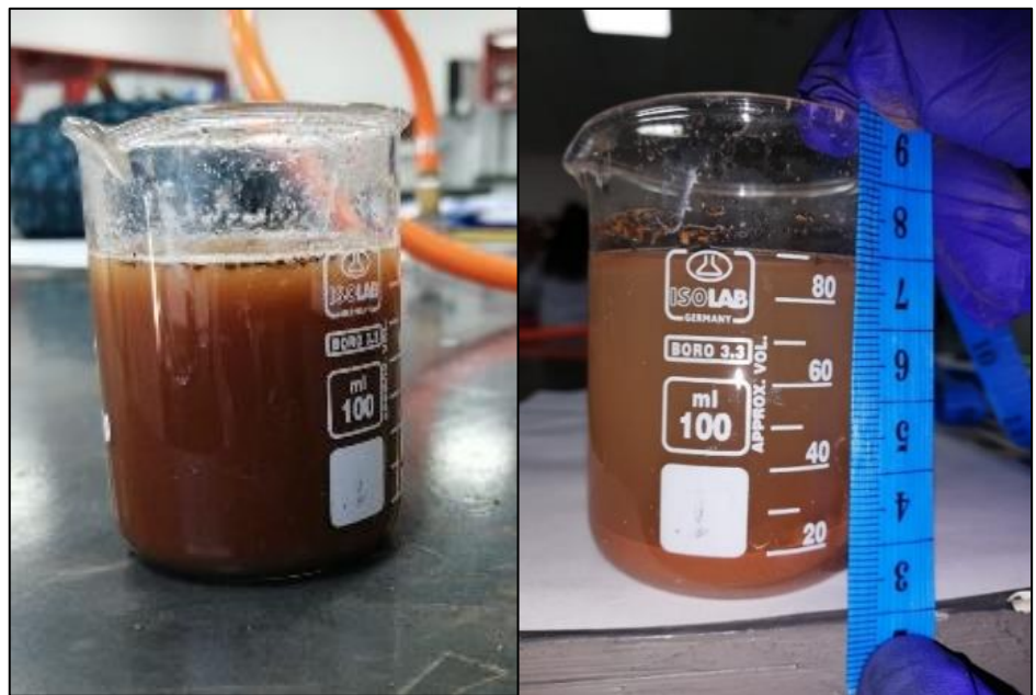
Figura 10 Determinación de proporción de arena, limo y arcilla Fuente: Panel fotográfico
