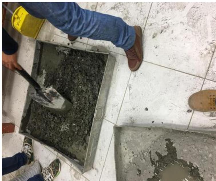
**Imagen N°3:** en esta imagen se aprecia el proceso de ensayo de SLUM, para vigas.
