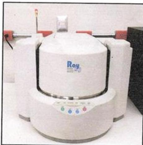
FIGURA 2. FOTOGRAFÍA DEL EQUIPO DE FLUORESCENCIA DE RAYOS X
