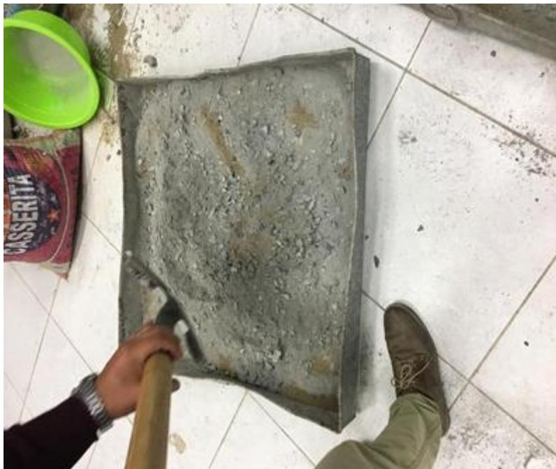
**Imagen N°4: En esta otra imagen apreciamos el proceso de mezclado con la ayuda de una palana como herramienta de trabajo.**
