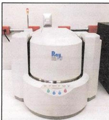
FIGURA 2. FOTOGRAFÍA DEL EQUIPO DE FLUORESCENCIA DE RAYOS X
