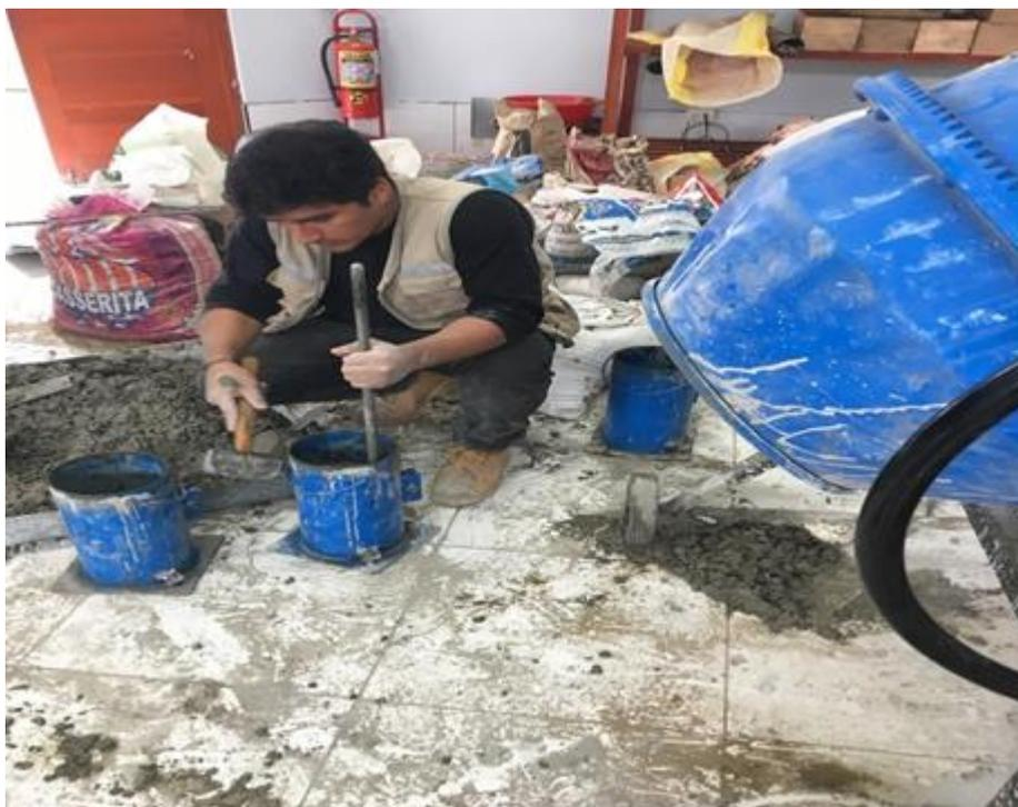
**Imagen N°9:** en esta imagen apreciamos algunos de nuestras probetas ya listas. Luego de la cual pasara por un proceso de curado donde permanecerán sumergida dentro del agua por el tiempo que requiera.
