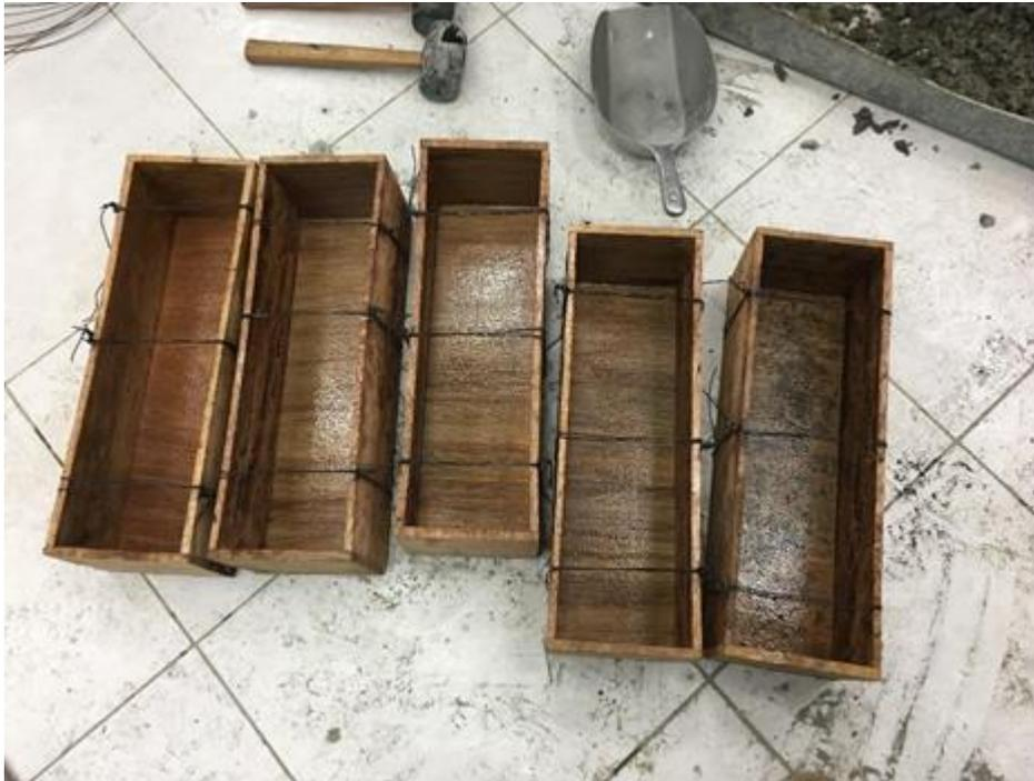
**Imagen N°6: A igual que en la probeta, se procede a vaciar el concreto y el chuseado se realiza cada tres capas y con 25 chuseadas por cada capa.**
