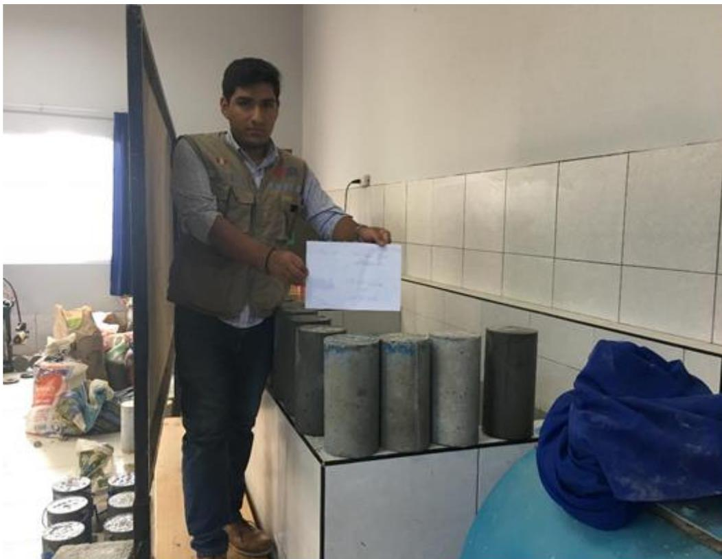
**Imagen N°10:** pesado de probeta.
