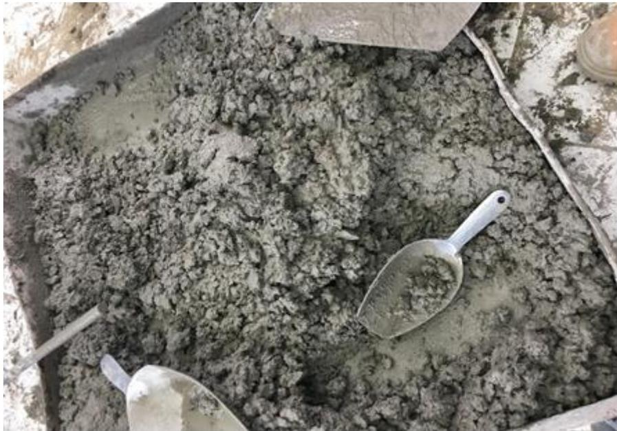
**Imagen N°6:** en esta imagen se aprecia el proceso de ensayo de SLUM, En la cual se aprecia el llenado y chuseado por cada nivel la cual se realiza en tres niveles, este es un ensayo de prueba de consistencia que consiste en compactar una muestra de concreto fresco en un molde cónico, midiendo el asiento o descenso de la mezcla luego de desmoldarlo.
