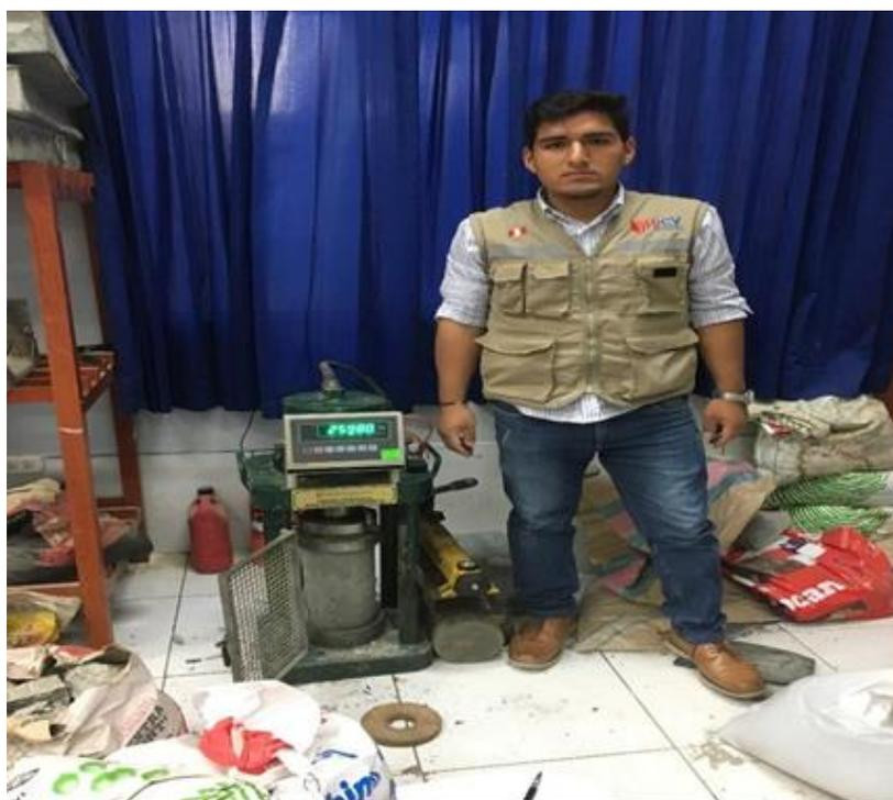
**Imagen N°13: proceso de rompimiento de probeta por carga (resistencia a la compresión).**
