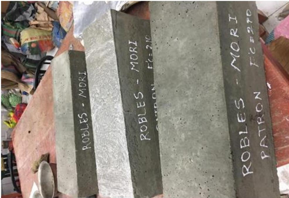
**Imagen N°12: luego de este proceso se procede a sumergir al agua para su respectivo curado por el tiempo que requiera para luego sacar y realizar el proceso de ensayo que continúa.**
