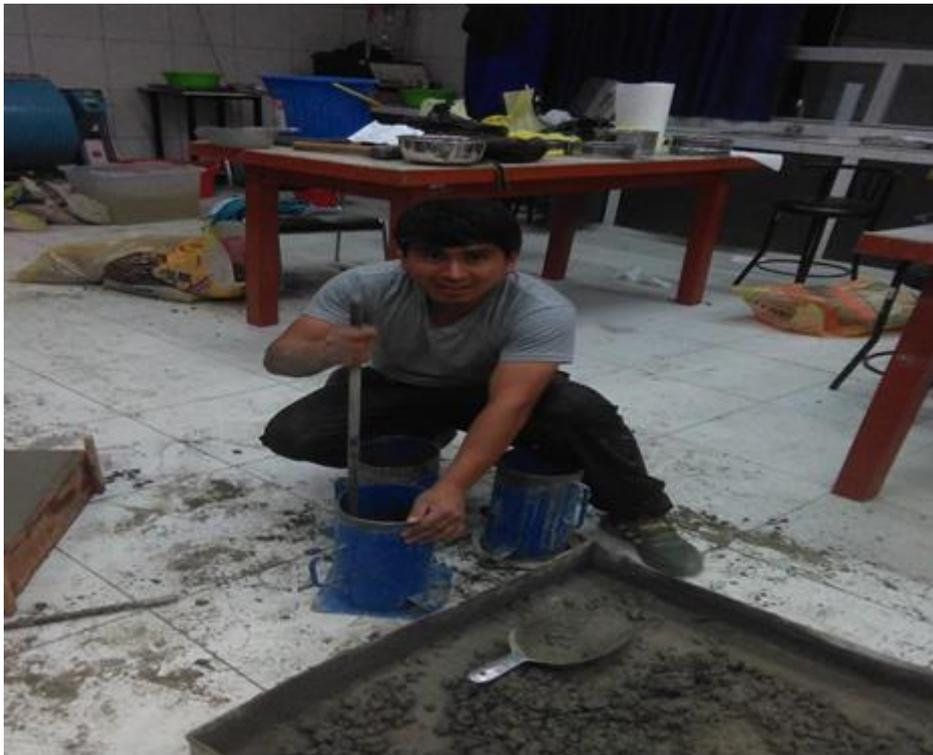
**Imagen N°7:** en esta imagen podemos apreciar ya el vaciado de concreto para probeta, pero cabe mencionar que antes del vaciado de concreto los moldes previamente han sido ligeramente pasadas con petróleo en el arte interior para su fácil desencofrado.
