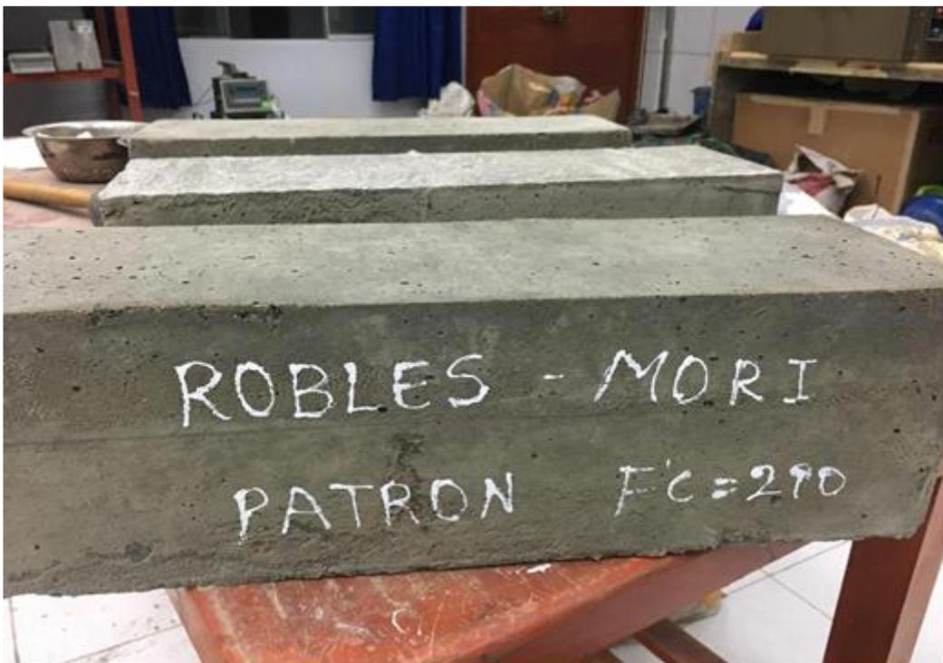
**Imagen N°13:** luego del curado la vigueta se saca del agua y se deja secar para luego continuar con las medidas necesarias para que posteriormente sea sometida a una carga de flexión a continuación en las imágenes vemos dicho proceso.
