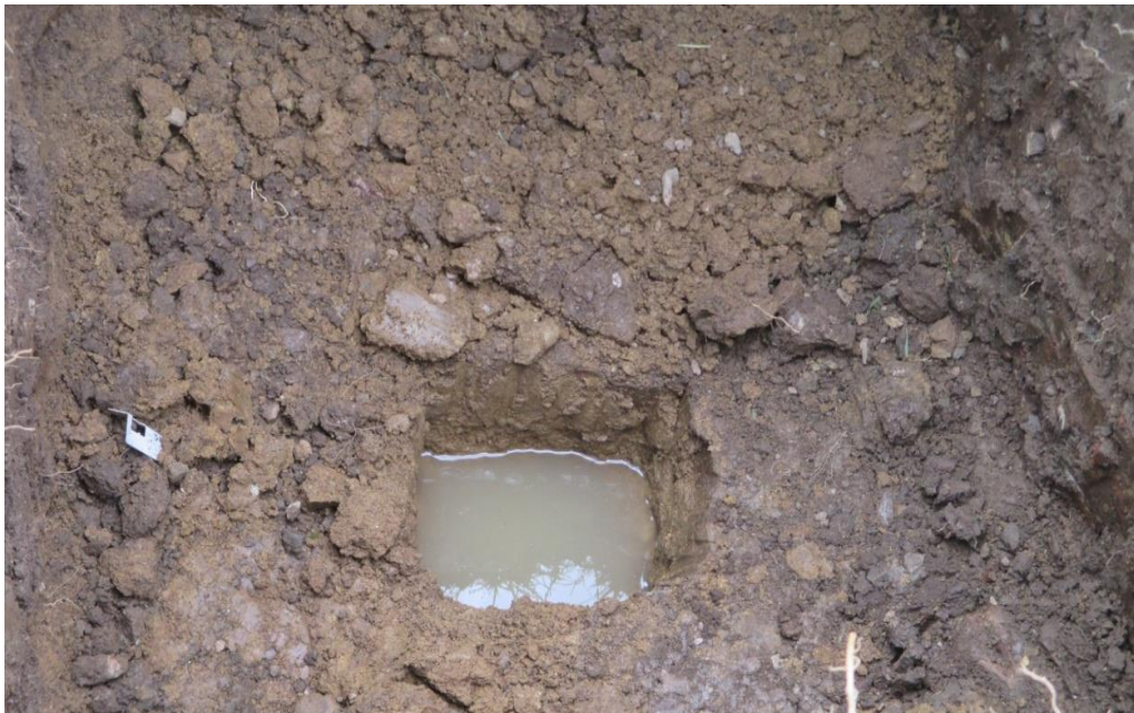
Figura N° 11. Controlando el tiempo de infiltración del agua en el pozo de percolación
