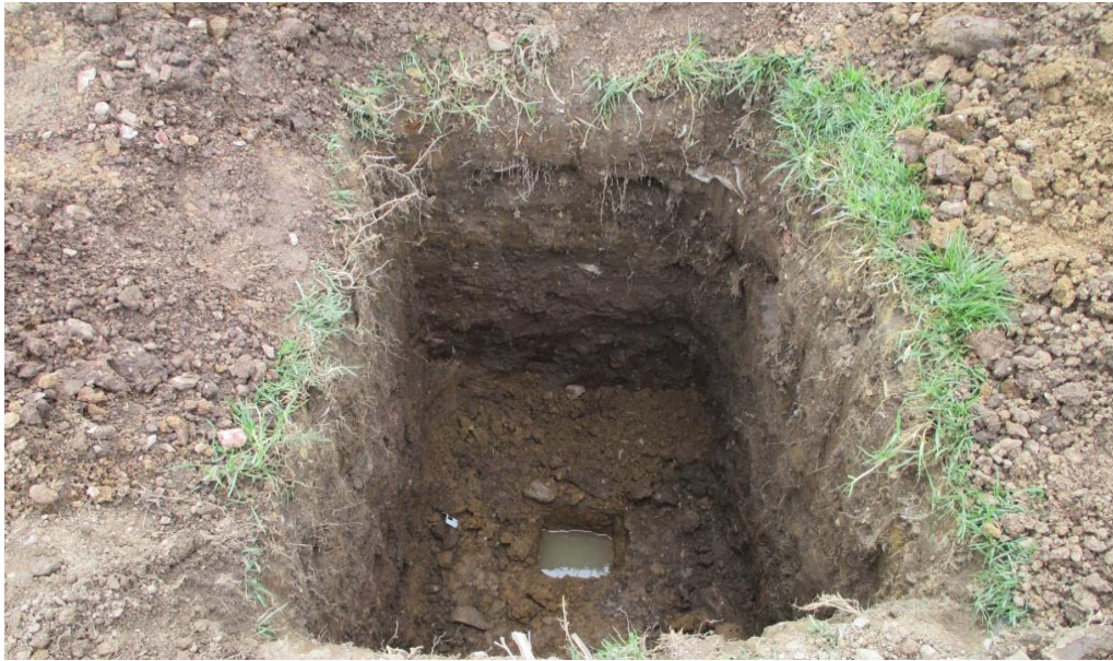
Figura N° 10. Pozo de percolación con 30 x 30 cm de profundidad y de ancho
