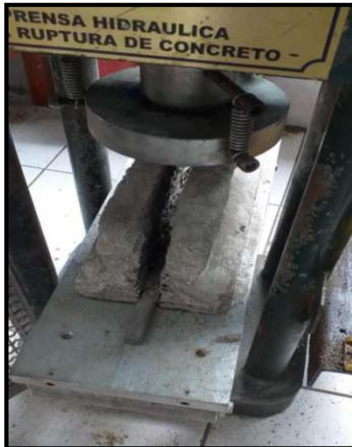
**Fotografía 10:** *Resultado de la Ensayo a Tracción de la vigüeta prefabricada de concreto.*
