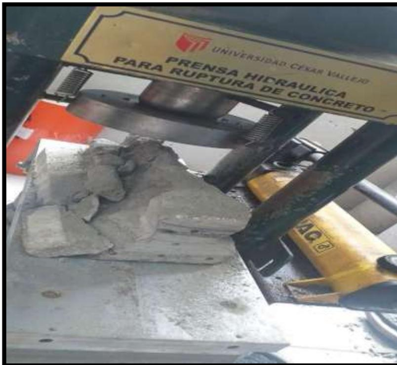
**Fotografía 08:** *Resultado de la Ensayo a Compresión de la Vigueta prefabricada, está en forma de reloj de arena.*
