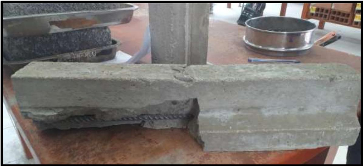
**Fotografía 11:** *Resultado de la Ensayo a Flexión de la vigueta in situ de concreto.*
