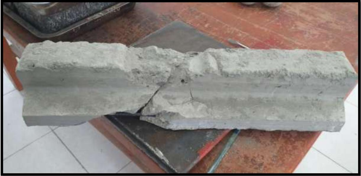
**Fotografía 11:** *Resultado de la Ensayo a Flexión de la vigueta prefabricada de concreto.*
