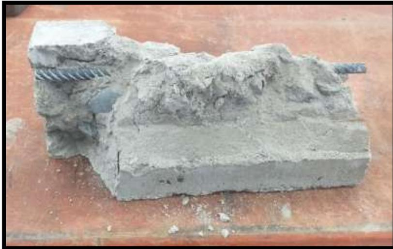
**Fotografía 09:** *Resultado de la Ensayo a Compresión de la Vigüeta de Concreto In Situ., forma reloj de arena.*
