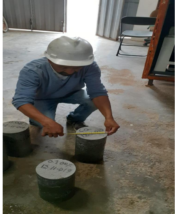
Medición del diámetro de los testigos para su cálculo
