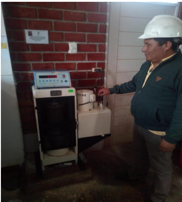
Rotura de los testigos con la prensa hidráulica
