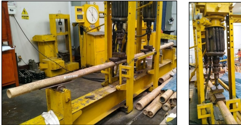
Figura 20: Ensayo de flexión estática
