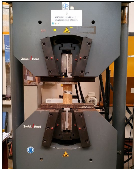
Figura 11: Ensayo de compresión paralela a la fibra
