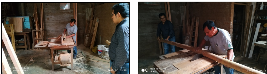
Figura 9: Corte y preparación de las probetas
