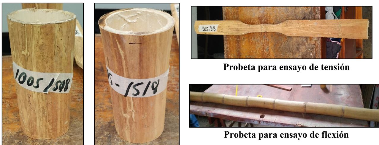
Probetas para ensayos de compresión y corte
