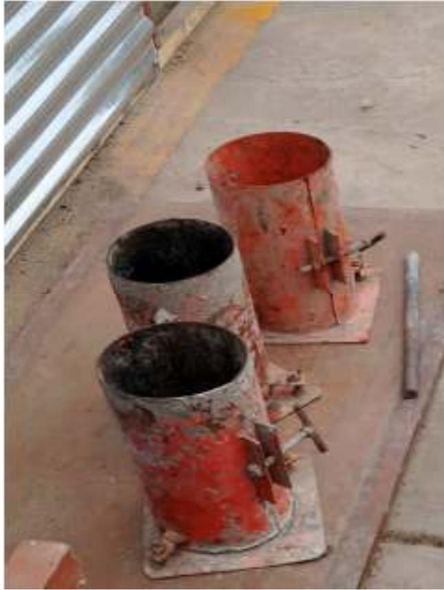
*Ilustración 19 Probeta de concreto estándar - Fuente propia*
