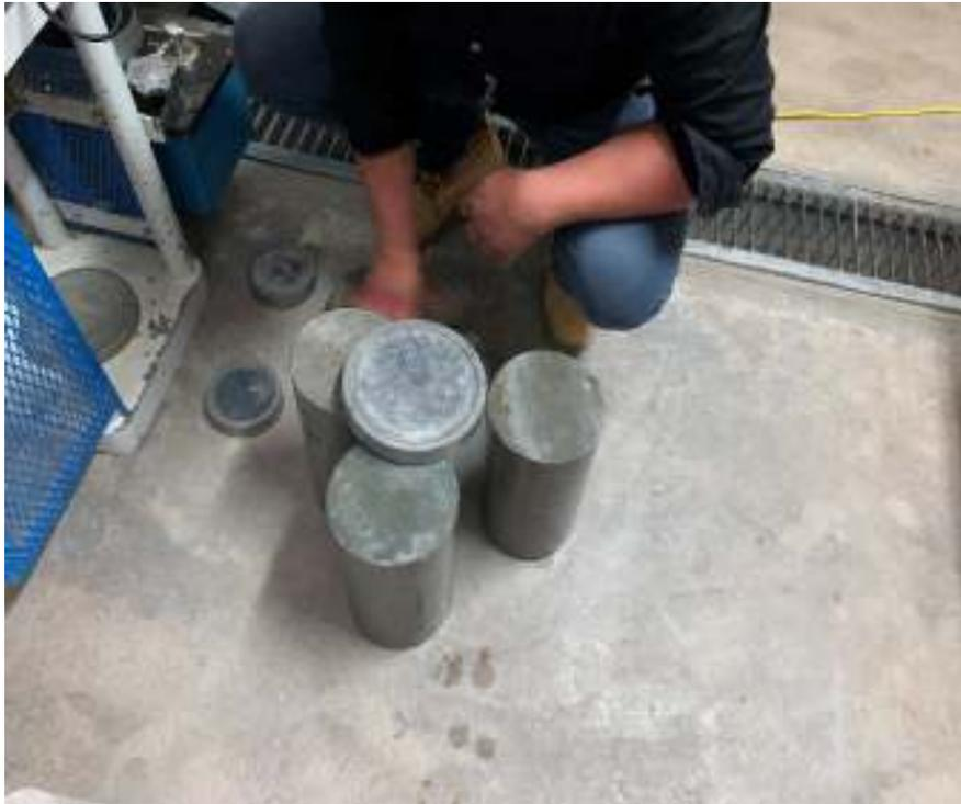
*Ilustración 4 Testigo de curados a 28 días - Fuente propia*
