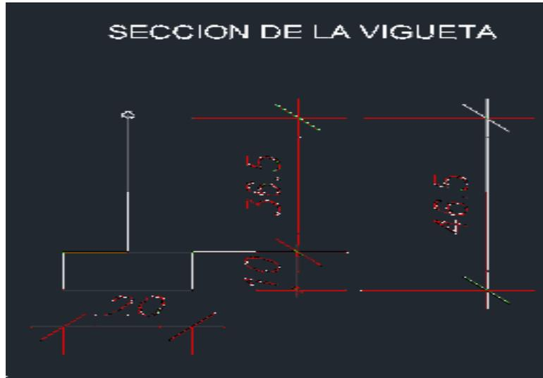
Ilustración 23 Sección de la vigueta de diseño - Fuente propia
