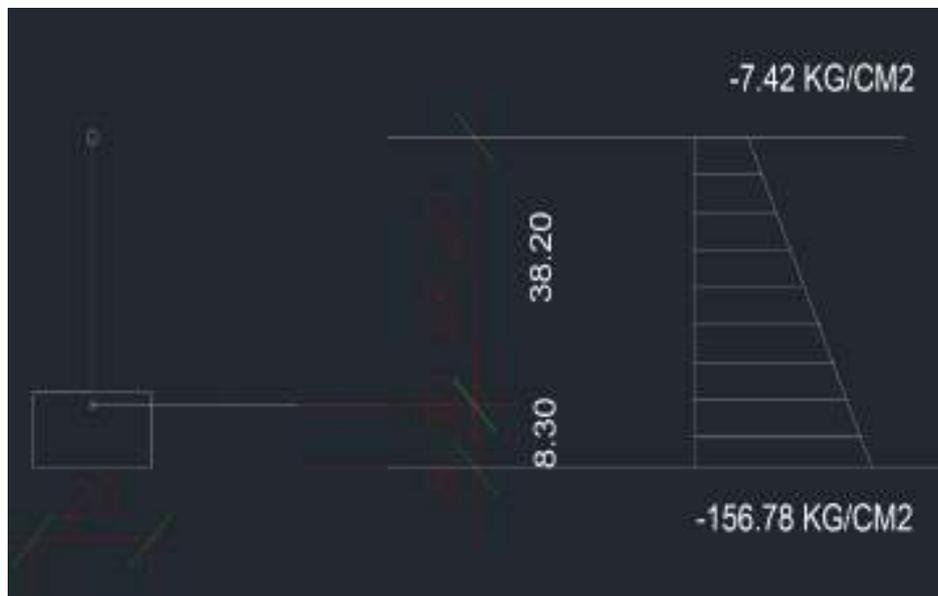
*Ilustración 25 diagrama de esfuerzos de la vigueta simple, bajo la influencia del preesfuerzo - Fuente propia*
