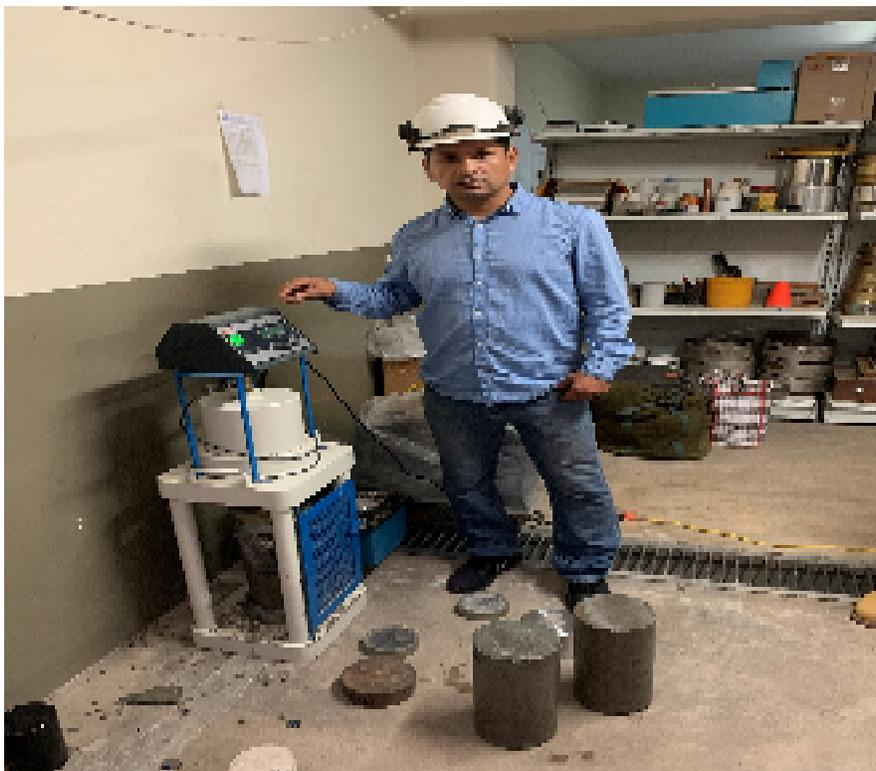
*Ilustración 5 Muestra de rotura a compresión - Fuente propia*
