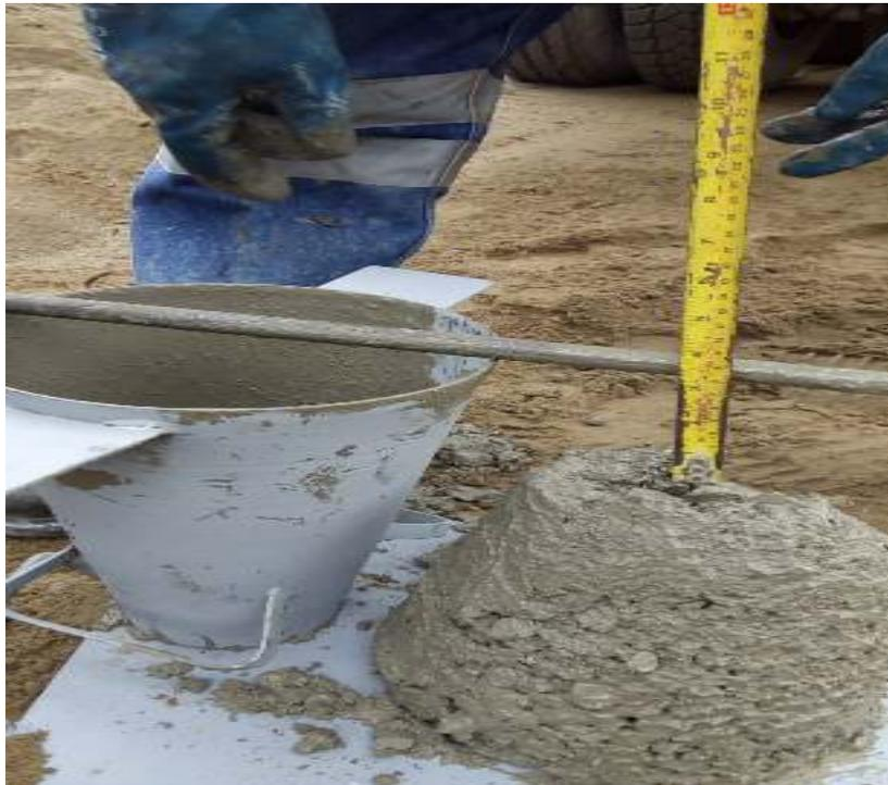
*Ilustración 3 Prueba de slump - Fuente propia*
