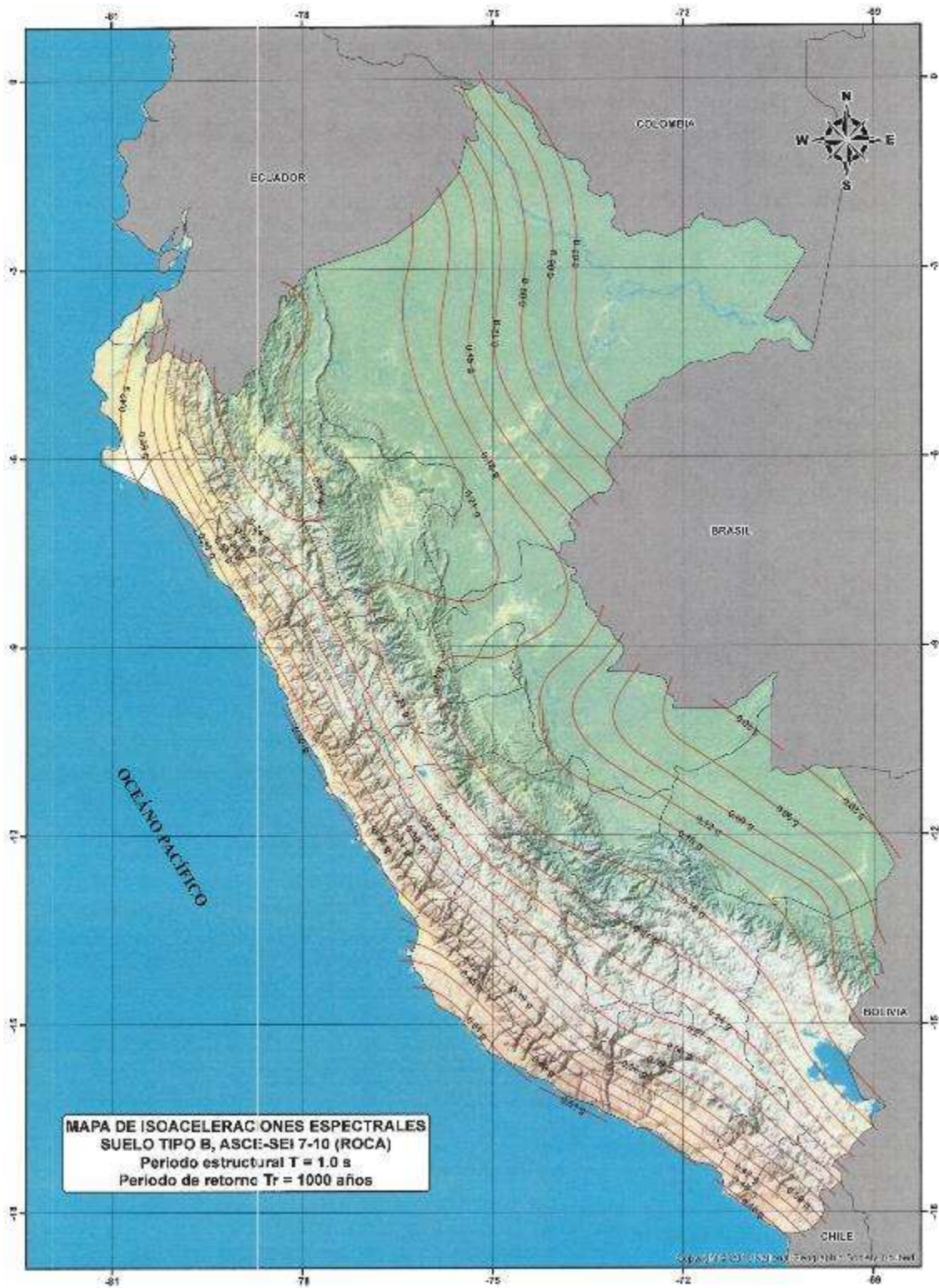
Figura N° 115: Isoaceleraciones con T=1 seg para T_{\text{retorno}}=1000 años
