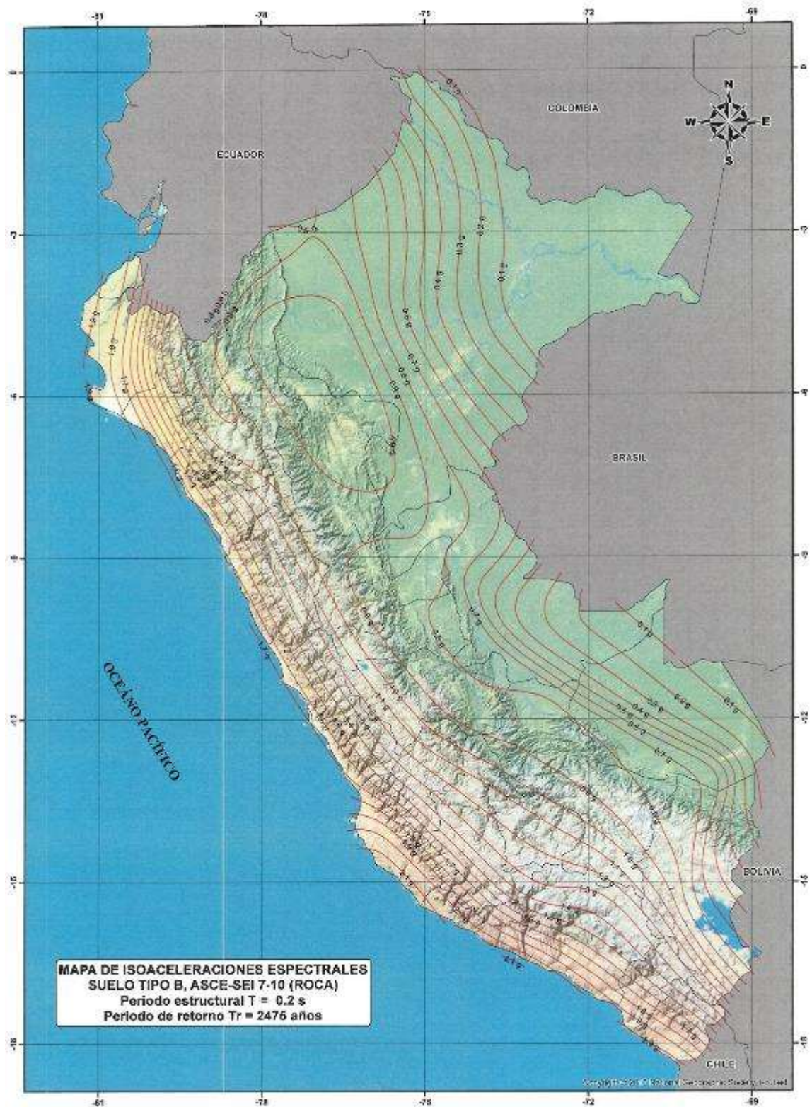
Figura N° 116: Isoaceleraciones con T=0.2 seg para T_{\text{retorno}}=2475 años
