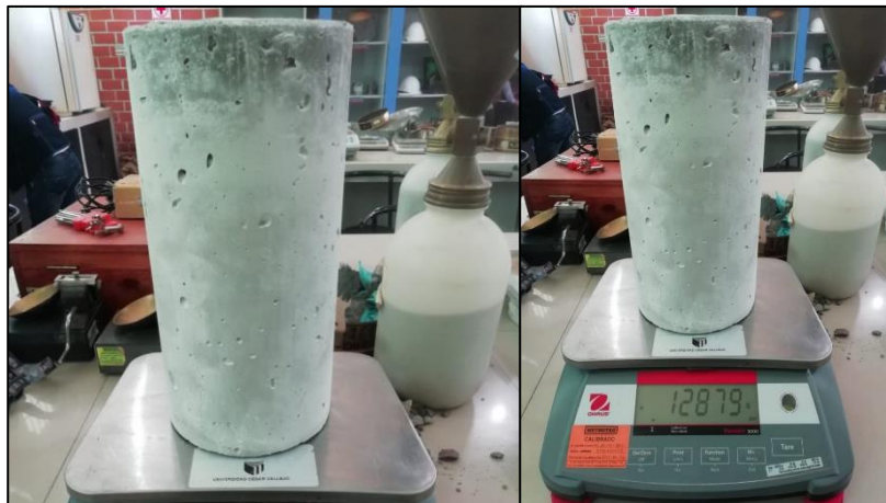
Figura 43. Muestra, peso y rotura (28 días) – Probeta patrón 08
