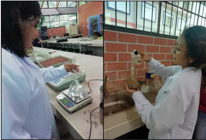
Figura 26. Pesamos la Fiola, agregamos el material y el agua
