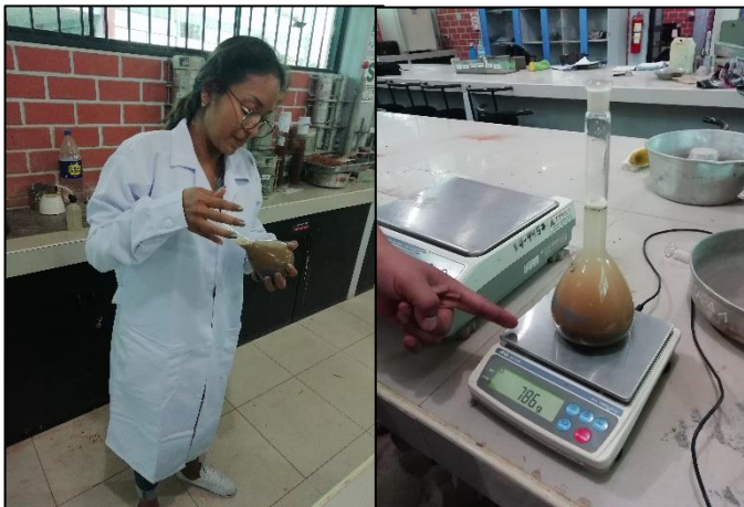
Figura 27. Mezclando el material en la Fiola y tomando nota de su peso
