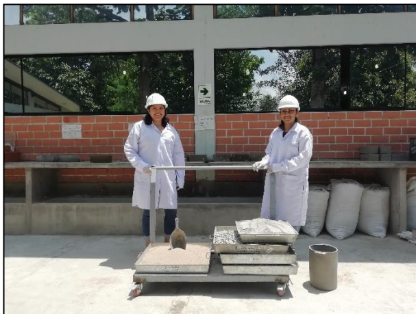
Figura 29. Materiales con sus respectivos pesos para el diseño patrón de concreto f'c = 210 \text{Kg/cm}^2
