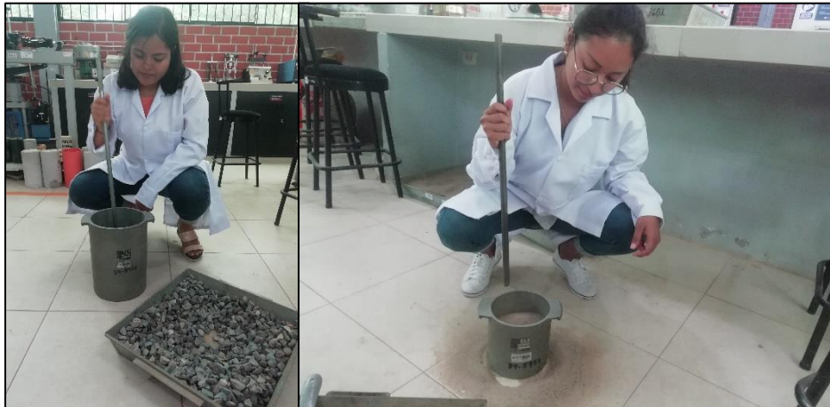
Figura 20. Peso Unitario Compactado de los agregados
