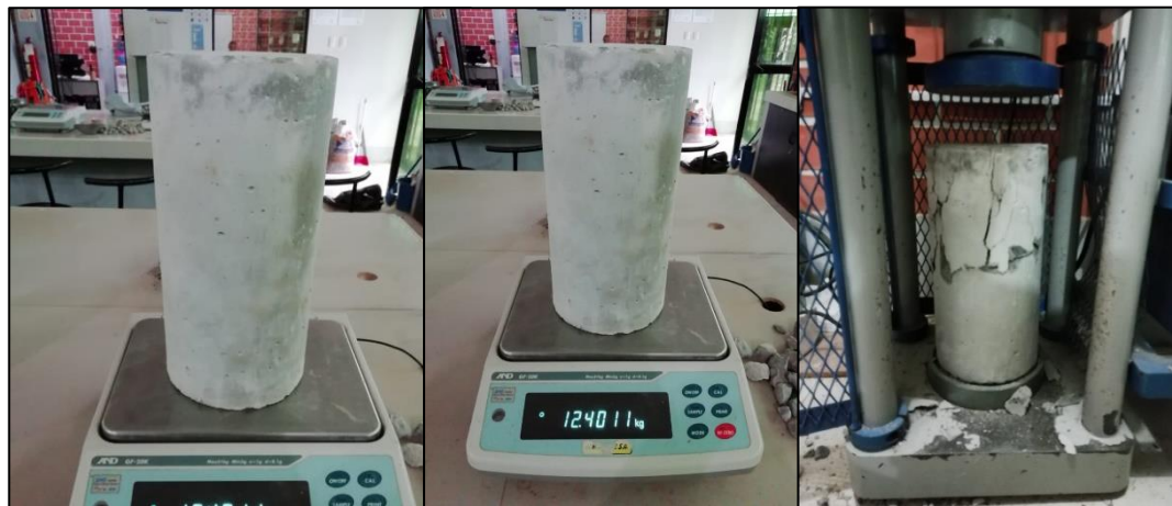
Figura 39. Muestra, peso y rotura (14 días) – Probeta patrón 04
