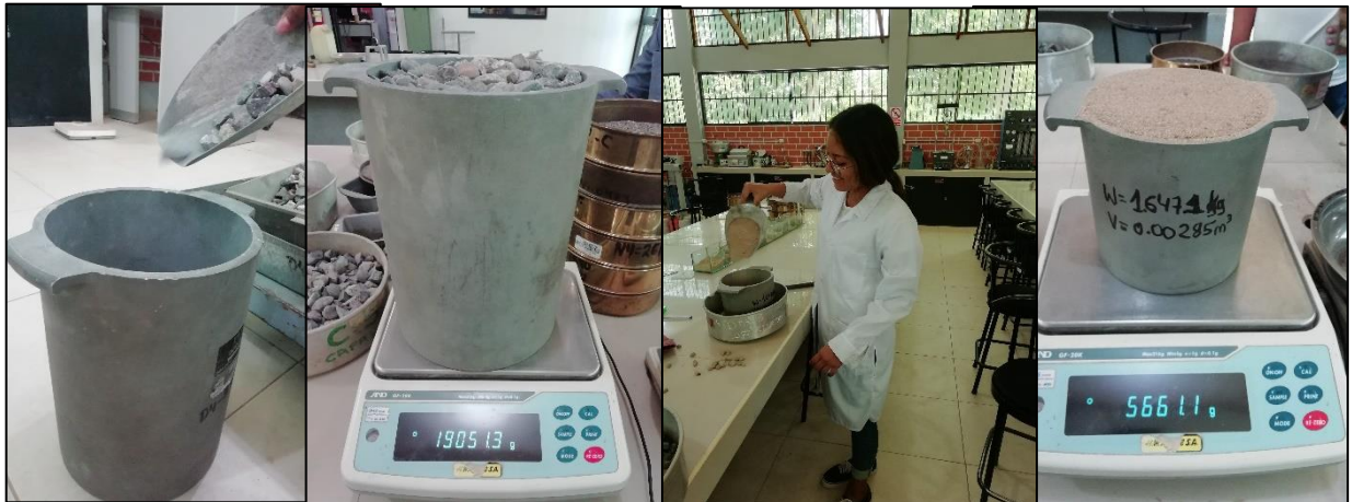
Figura 19. Peso Unitario Suelto de los agregados
