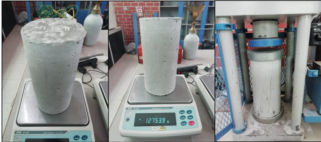
Figura 38. Muestra, peso y rotura (07 días) - Probeta patrón 03
