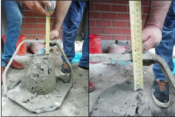
Figura 30. Ensayo Slump en un rango de 3" a 4"
