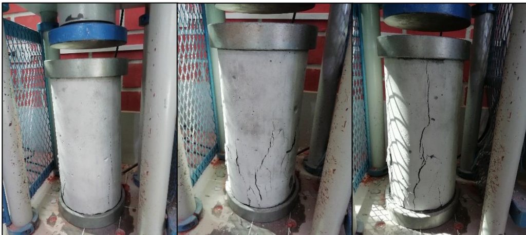
Figura 45. Rotura (7 días al 4% de bacterias) – Probeta 10,11 y12
