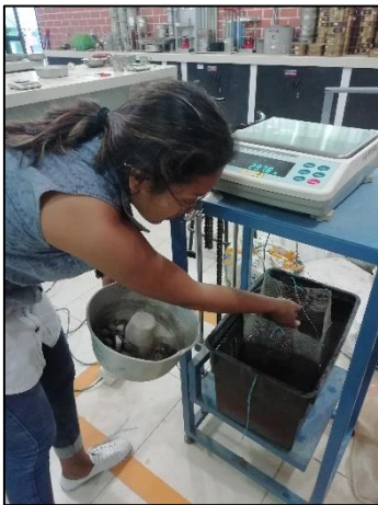
Figura 22. Colocación de material en la canastilla de la Balanza de flotabilidad
