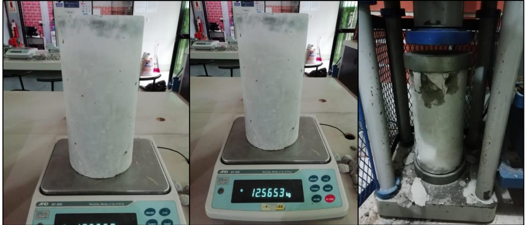
Figura 41. Muestra, peso y rotura (14 días) – Probeta patrón 06
