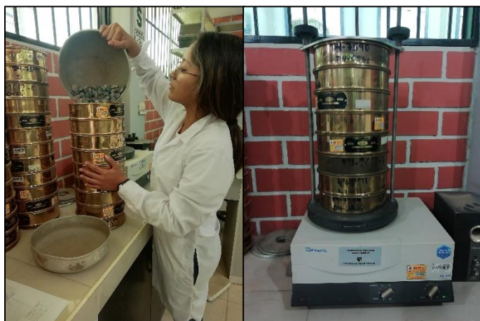
Figura 18. Colocación de material en el tamizador
