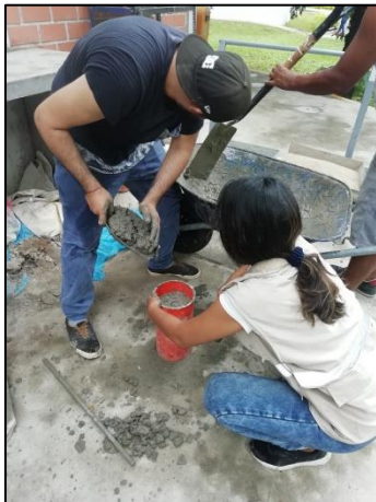
Figura 31. Colocación del concreto en los moldes cilíndricos (probetas)
