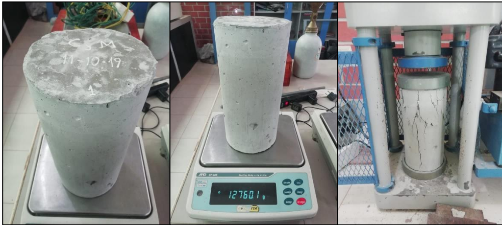
Figura 36. Muestra, peso y rotura (07 días) – Probeta patrón 01
