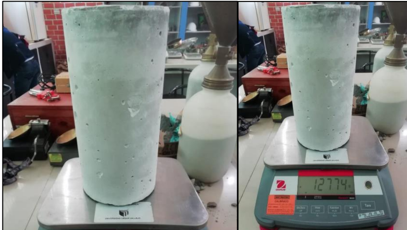
Figura 44. Muestra, peso y rotura (28 días) – Probeta patrón 09
