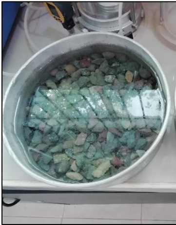
Figura 21. Saturación de Agregado grueso
