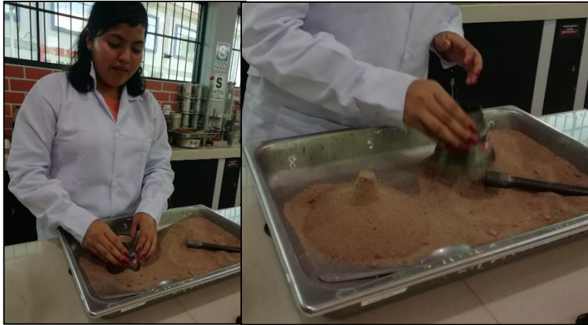
Figura 25. Extracción del Cono de absorción
