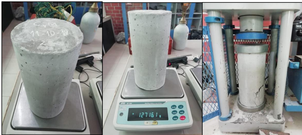
Figura 37. Muestra, Peso y rotura (07 días) - Probeta patrón 02
