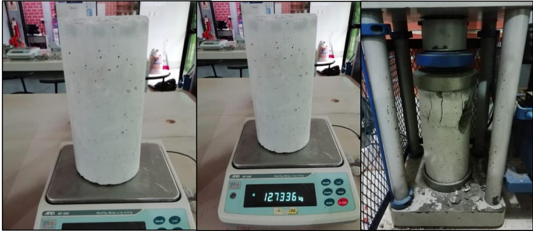
Figura 40. Muestra, peso y rotura (14 días) – Probeta patrón 05
