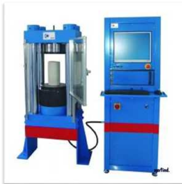
Figura 5. Máquina universal utilizada para el ensayo de compresión.
