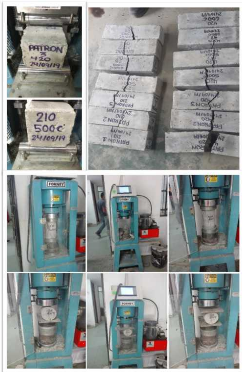
Figura 17. Ensayos de Compresión, Tracción y Flexo Tracción a Probetas Cilíndricas y Vigas de Concreto f'c=210\text{kg/cm}^2 y f'c=420\text{kg/cm}^2 .
