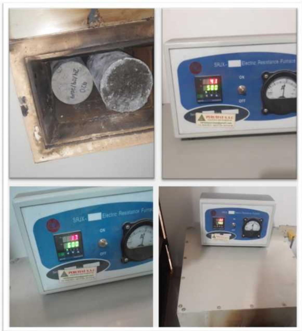
Figura 15. Quemado de probetas y vigas.
