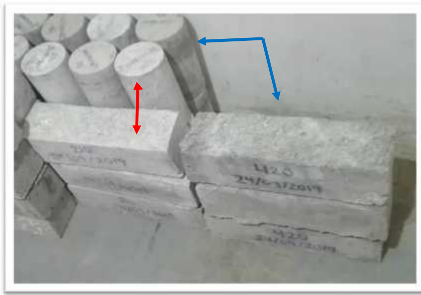
Figura 16. Vigas y probetas luego de temperatura de 500°C.
