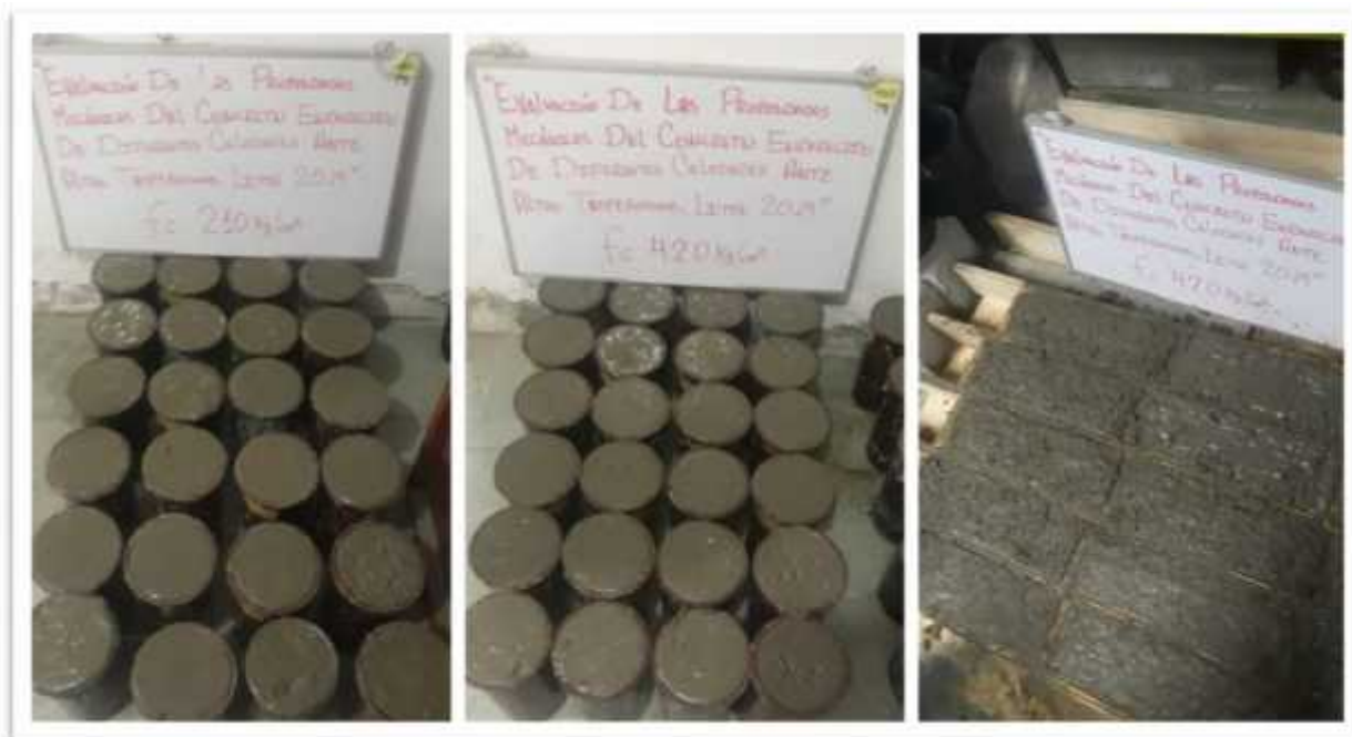
Figura 13. Fabricación de probetas cilíndricas y vigas de concreto de f'c=420\text{kg/cm}^2 y f'c=210\text{kg/cm}^2
