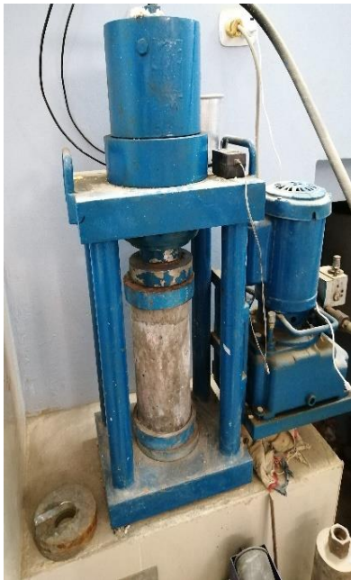
Figura 17: rotura de probetas de diseño f'c=280\text{kg/cm}^2 y f'c=350\text{kg/cm}^2 con aditivo tiempo de curado 7 días
