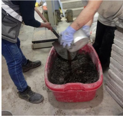
Figura 11: elaboración de diseño de mezcla f'c=280\text{kg/cm}^2
