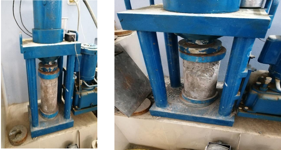
Figura 19: rotura de probetas de diseño f'c=280\text{kg/cm}^2 y f'c=350\text{kg/cm}^2 con aditivo tiempo de curado 28 días
