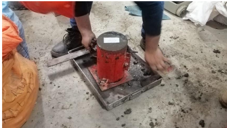
Figura 12: vertido de mezcla en probetas f'c=280\text{kg/cm}^2
