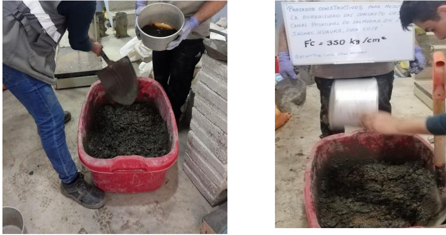
Figura 14: elaboración de diseño de mezcla f'_c=350\text{kg/cm}^2
