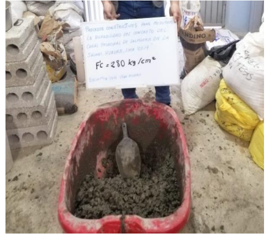
Figura 11: elaboración de diseño de mezcla f'c=280\text{kg/cm}^2
