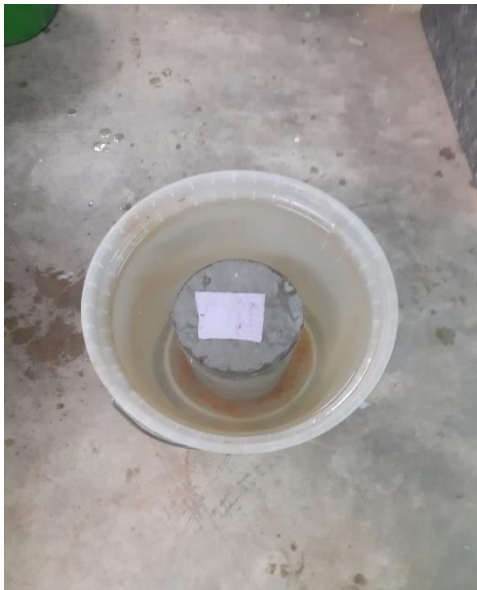
Figura 22: Inmersión de la muestra en agua durante 5 hrs. Luego se procede al secado natural y pesaje de la muestra.
