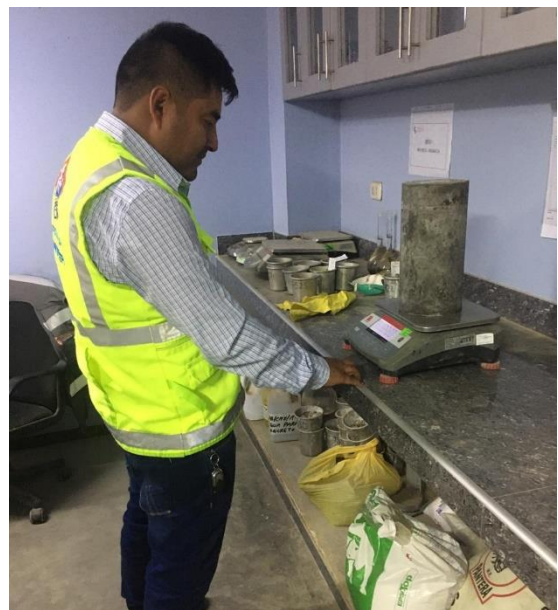
Figura 20: Secado al horno de la muestra a 100^{\circ}\text{C} durante 24 hrs. y determinación del peso seco.
