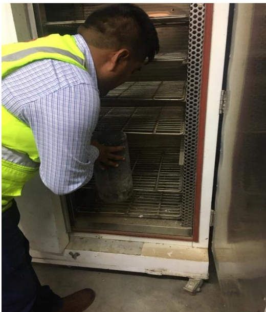
Figura 20: Secado al horno de la muestra a 100^{\circ}\text{C} durante 24 hrs. y determinación del peso seco.
