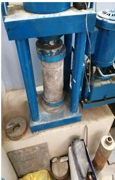
Figura 18: rotura de probetas de diseño f'c=280\text{kg/cm}^2 y f'c=350\text{kg/cm}^2 con aditivo tiempo de curado 14 días
