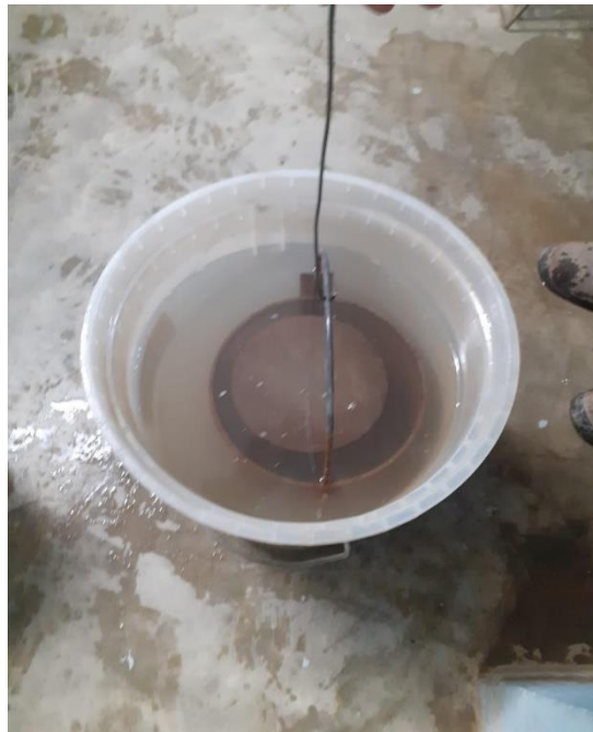
Figura 23: Medición de peso aparente en muestra sumergida.
