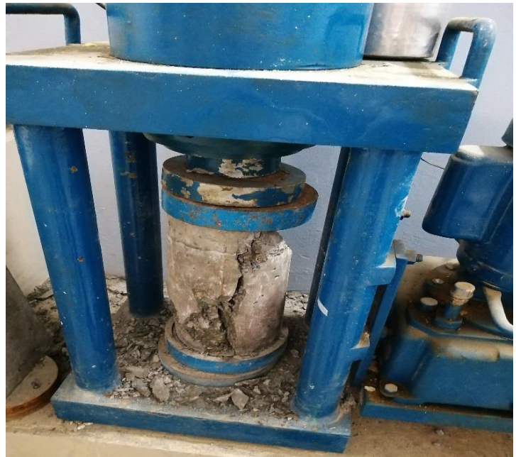
Figura 17: rotura de probetas de diseño f'c=280\text{kg/cm}^2 y f'c=350\text{kg/cm}^2 con aditivo tiempo de curado 7 días
