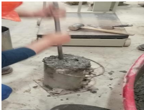
Figura 15: vertido de mezcla en probetas f'_c=350\text{kg/cm}^2
