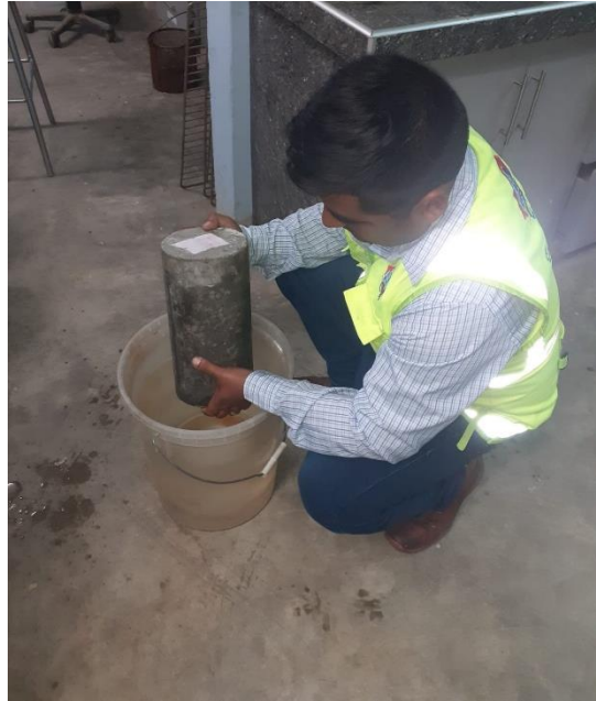
Figura 21: Inmersión de la muestra en agua a temperatura de 21°C por 48 hrs. Luego se procede al secado y pesaje de la muestra.
