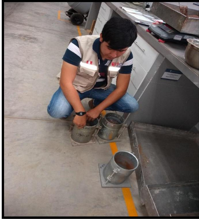
Moldes de CBR con los estratos listos para la colocación del DIAL (Marcador), que mide la expansión de la muestra en el agua.
