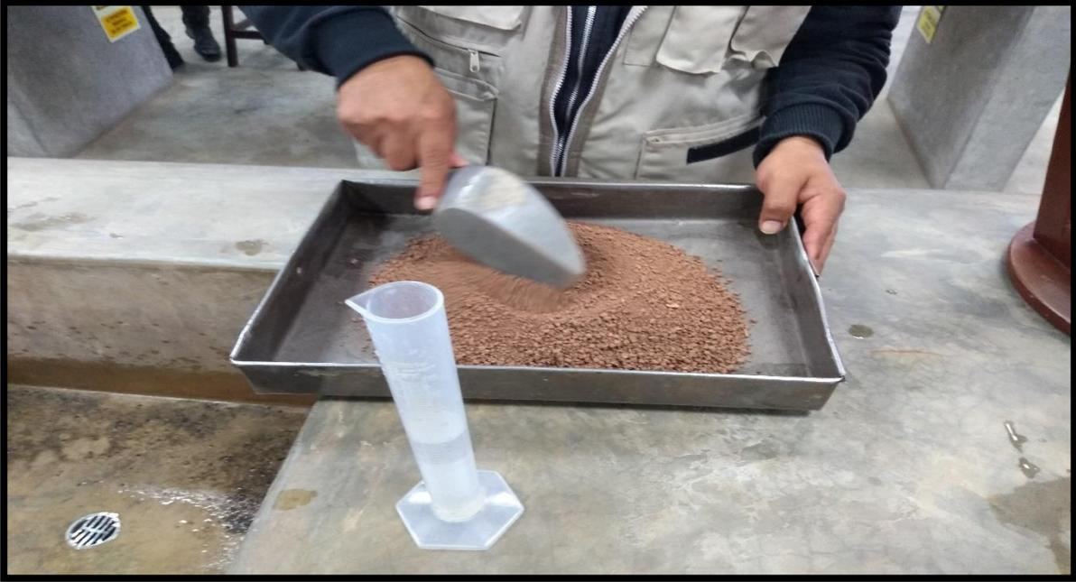
Ensayo de Proctor Modificado
