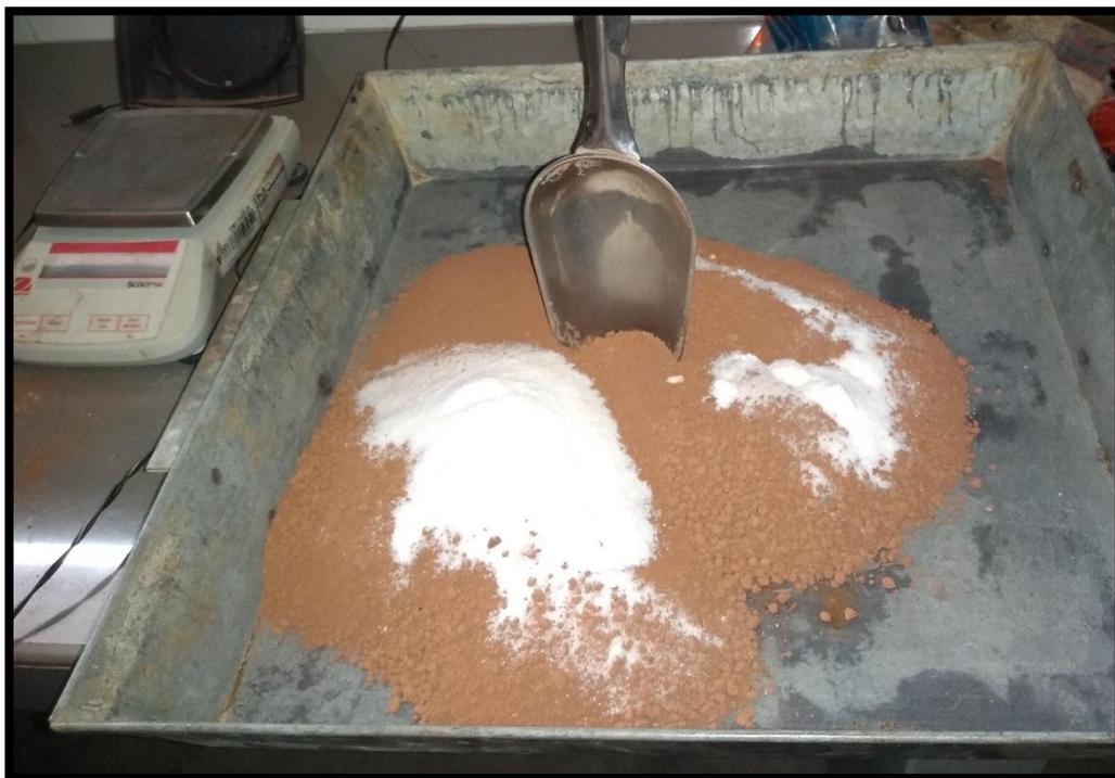
Procedemos a agregar agua al material dosificado con sal, para realizar el ensayo Proctor.
