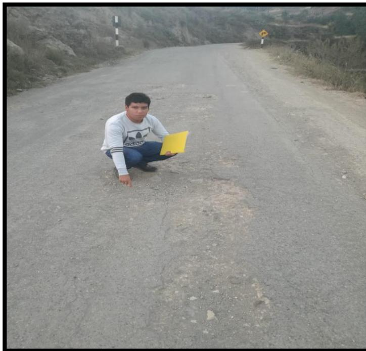
Se puede visualizar al investigador realizando la prueba de la bola In Situ, la cual le permite predecir si el suelo a investigar posee presencia de material arcilloso.
