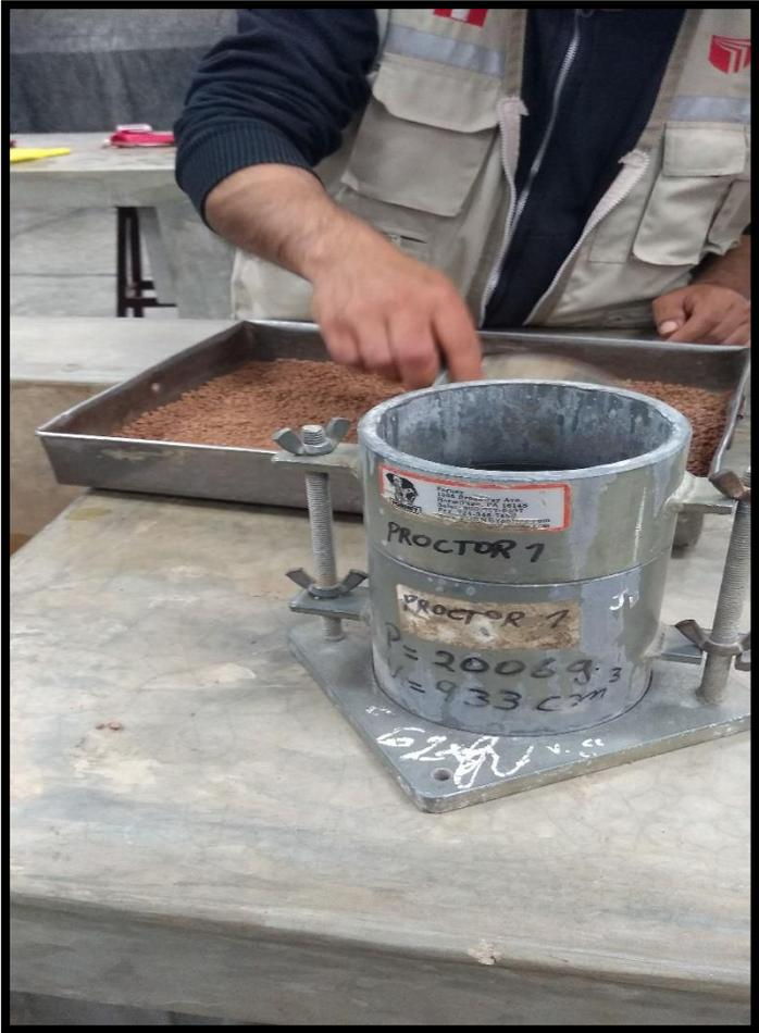
Resultado del ensayo proctor para luego poder obtener un estrato del interior de la muestra para saber su contenido de humedad. (Calicata A y B)
