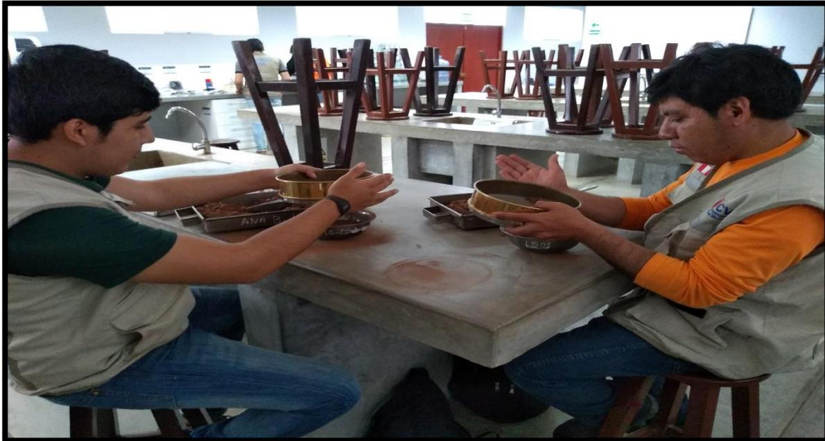
Se procede a mezclar el cloruro de sodio de manera homogénea con el material seco, para realizar el ensayo de Proctor modificado.
