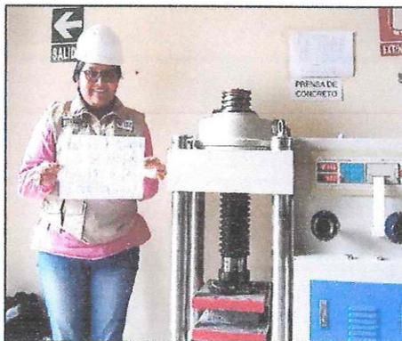
**Figura N°49:** Rotura a compresión de las 3 muestras de los adoquines incorporando el 1.5% de fibra de coco a los 28 días.
