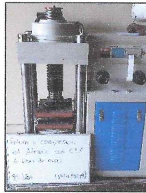
**Figura N°46:** Rotura a compresión de las 3 muestras de los adoquines incorporando el 0.5% de fibra de coco a los 28 días.
