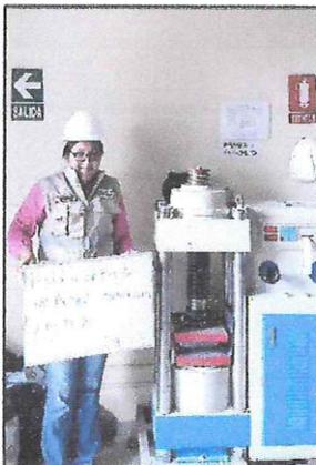
**Figura N°43:** Rotura a compresión de las 3 muestras de los adoquines convencionales a los 28 días.
