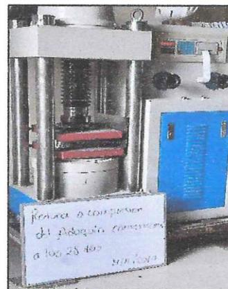
**Figura N°44:** Rotura a compresión de las 3 muestras del adoquín convencional a los 28 días.
