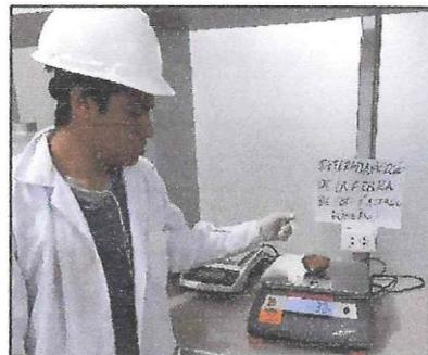
**Figura N°02:** Contenido de Humedad – Peso de la tara + fibra de coco húmedo y seco (secado al horno)
