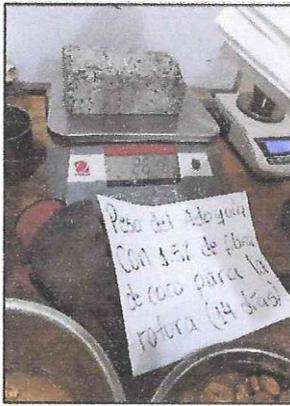
**Figura N°41:** Peso de las 3 muestras de los adoquines incorporando el 1.5% de fibra de coco a los 14 días.
