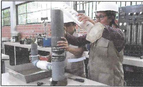
**Figura N°51:** Ensayo de permeabilidad con tres porcentajes de fibra de coco a los 28 días.
