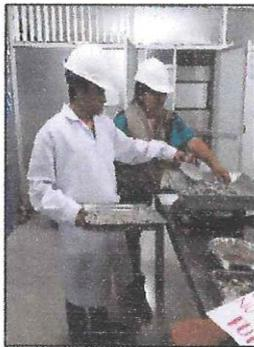
**Figura N°19:** *Peso de los materiales a utilizar para el diseño de mezcla (cemento + agregado fino + agregado grueso + agua + fibra de coco en porcentajes efectuados)*
