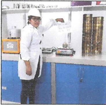
**Figura N°17:** *Ensayo del Peso Especifico del Agregado Fino – Peso de la fiola + muestra de 500 gr. + peso del agua, para luego ser secado al horno.*
