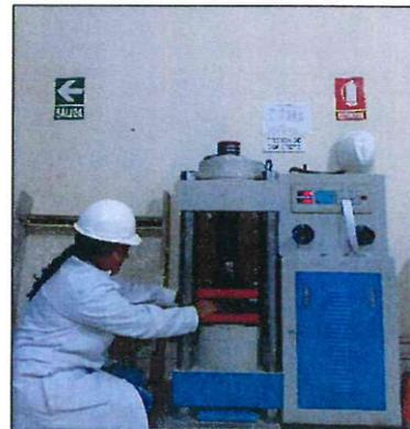
**Figura N°28:** *Rotura a compresión de las 3 muestras del adoquín convencional durante los 7 días.*
