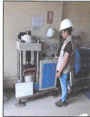
**Figura N°42:** Rotura a compresión de las 3 muestras de los adoquines incorporando el 1.5% de fibra de coco a los 14 días.
