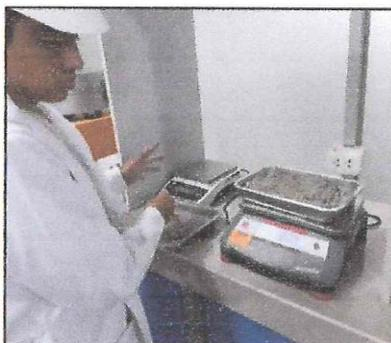
**Figura N°13:** Ensayo de Absorción – Peso del agregado fino a 1200 gr. y a 1800 gr. para la saturación y Peso del agregado grueso a 1500 gr. y a 3000 gr. para la saturación, para luego ser lavado y secado al horno.
