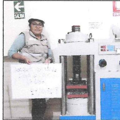
**Figura N°34:** Rotura a compresión de las 3 muestras del adoquín incorporando el 1.5% de fibra de coco a los 7 días.
