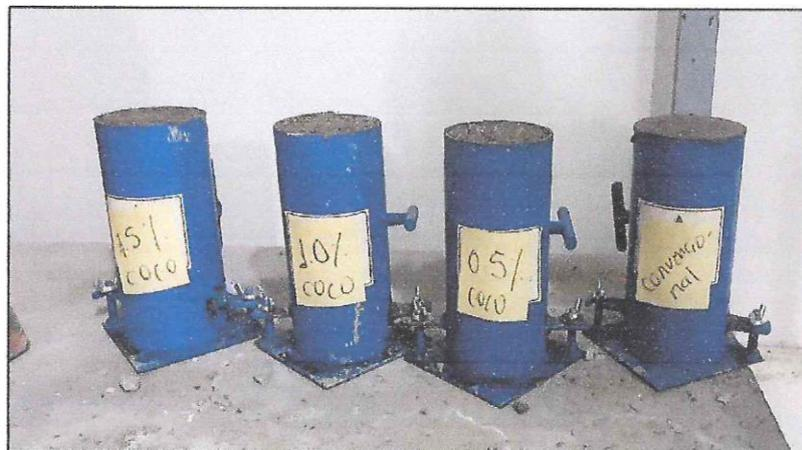
**Figura N°26:** Culminación de los probetas testigo convencionales y probetas testigo con incorporación de fibra de coco al 0.5%, 1.0% y al 1.5% para el respectivo ensayo de permeabilidad.
