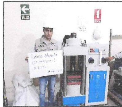
**Figura N°36:** Rotura a compresión de las 3 muestras del adoquín convencional a los 14 días.
