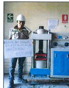
**Figura N°30:** *Rotura a compresión de las 3 muestras del adoquín incorporando el 0.5% de fibra de coco a los 7 días.*
