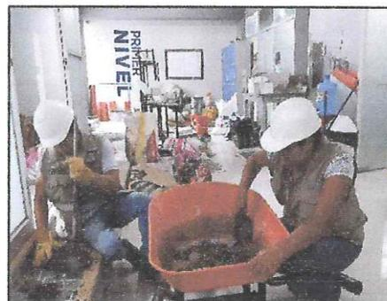
**Figura N°22:** *Diseño de mezcla para el adoquín permeable incorporando el 0.5% de fibra de coco*
