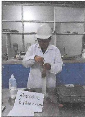
**Figura N°07:** *Ensayo de Absorción – incorporación de la fibra de coco de 10 gr. cada uno en 3 probetas con agua destilada de 500 ml. (la fibra de coco estará puesta en agua destilada durante 3 días)*
