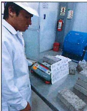
**Figura N°31:** *Peso de las 3 muestras de los adoquines incorporando el 1.0% de fibra de coco a los 7 días.*
