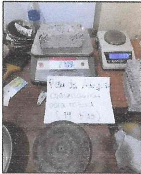
**Figura N°35:** Peso de las 3 muestras de los adoquines convencionales a los 14 días.
