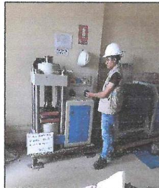
**Figura N°38:** Rotura a compresión de las 3 muestras de los adoquines incorporando el 0.5% de fibra de coco a los 14 días.
