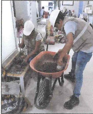
**Figura N°23:** Diseño de mezcla para el adoquín permeable incorporando el 1.0% de fibra de coco
