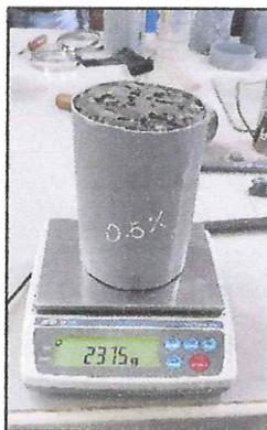
**Figura N°53:** Peso inicial de 2290 gr. y peso final de 2375 gr. de ensayo de permeabilidad con 0.5% de fibra de coco a los 28 días.
