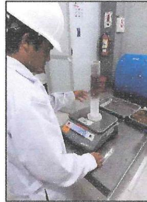
**Figura N°08:** *Ensayo de Absorción – Peso de la probeta + fibra de coco de 10gr. para cada probeta (3 probetas) – se pesarán las 3 probetas por 3 días.*
