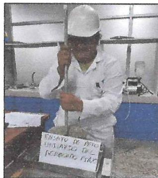
**Figura N°16:** Peso Unitario del agregado fino y agregado grueso – Llenado de la muestra al recipiente con compactación de 25 golpes en 3 capas, para luego ser pesada.
