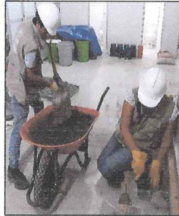
**Figura N°24:** Diseño de mezcla para el adoquín permeable incorporando el 1.5% de fibra de coco
