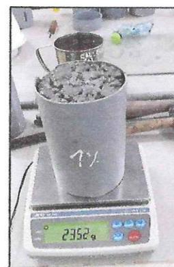
**Figura N°54:** Peso inicial de 2283 gr. y peso final de 2352 gr. de ensayo de permeabilidad con 1.0% de fibra de coco a los 28 días.
