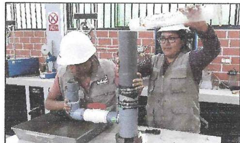
**Figura N°52:** Ensayo de permeabilidad con tres porcentajes de fibra de coco a los 28 días.
