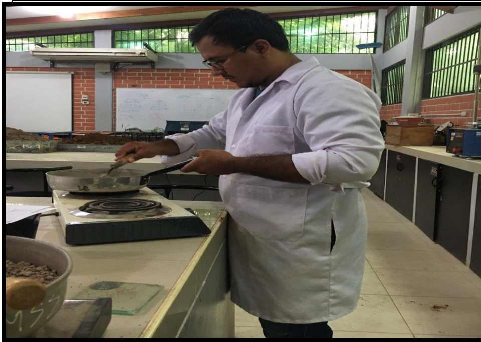
(foto N° 7) En la imagen podemos observar al tesista secando la muestra una cantidad determinada para hacer la granulometría respectiva.
