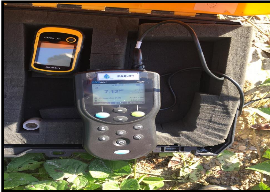
(foto N° 3) En la imagen podemos apreciar los resultados que nos mostró el equipo especial Ph y la temperatura del agua servida que se va directamente al rio cumbaza en la Localidad de San Antonio .
