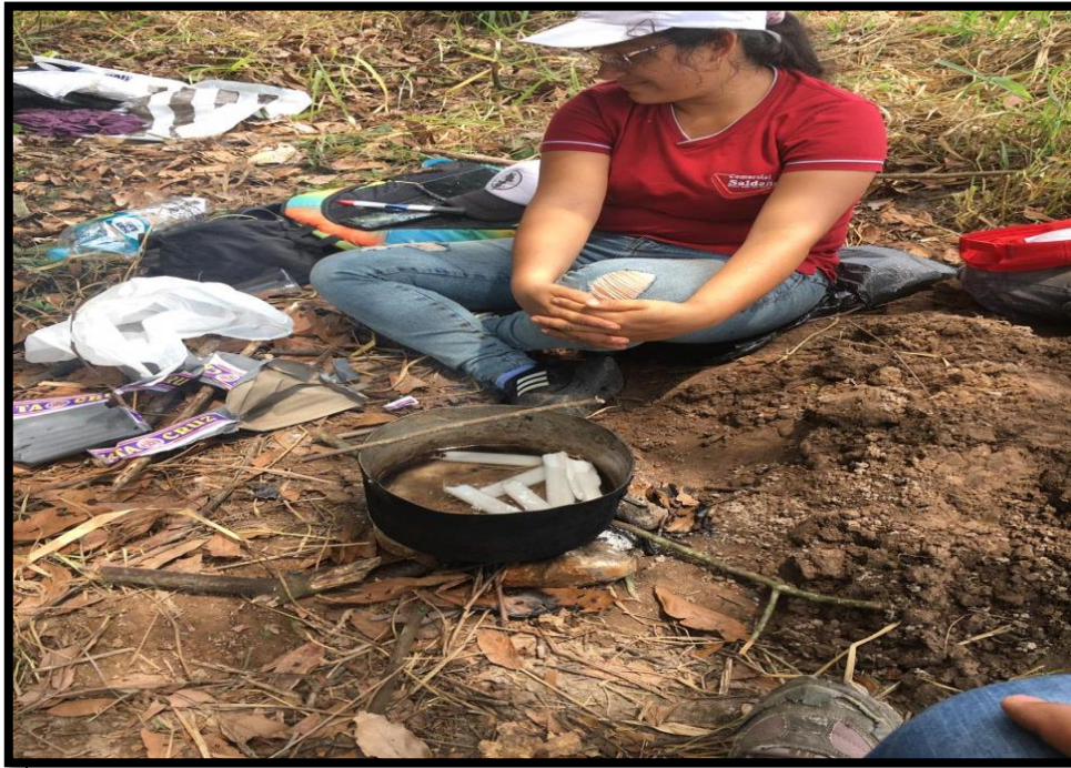
(foto N° 5) En la imagen podemos observar el derretimiento de las velas para colocarlo en el cubo con el fin de que este mantenga su humedad inicial y realizar la prueba de corte directa en el laboratorio de la Universidad Cesar Vallejo.
