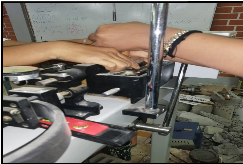
(foto N° 10) En la imagen podemos observar el colocando de la muestra respectiva en el equipo de corte directo, ya estando este equilibrado, después de ello se coloca agua destilada y se dejó por 24 horas.
