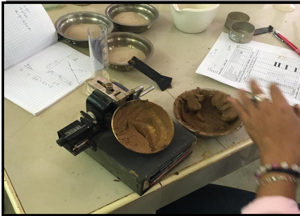
(foto N° 8) En la imagen podemos observar al tesista realizar el ensayo de limite liquido en el equipo de Casagrande, esto se lleva a cabo teniendo en cuenta el número de golpes y la cantidad de agua destilada
