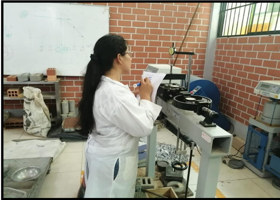
(foto N°9) En la imagen podemos observar la toma de datos en el dial para el desplazamiento lateral en mm y el esfuerzo de corte kg/cm 2 después de las 24 horas en el equipo de corte directo
