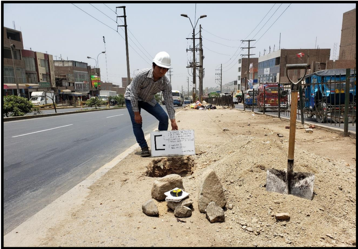
Muestras sacadas por estratos para ensayos de mecánica de suelos.
