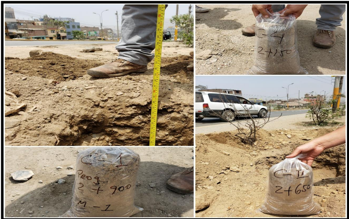
Muestras sacadas por estratos para ensayos de mecánica de suelos.
