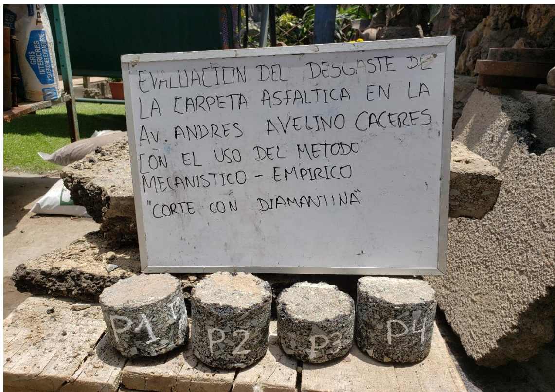
Muestras extraídas In situ por perforadora diamantina
