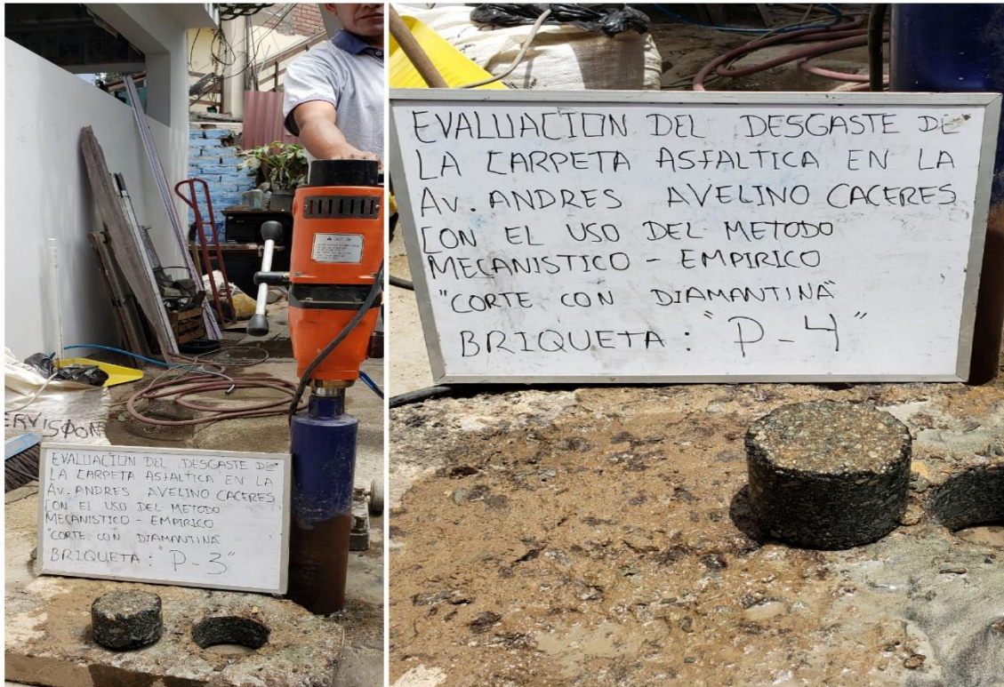
Muestras extraídas In situ por perforadora diamantina
