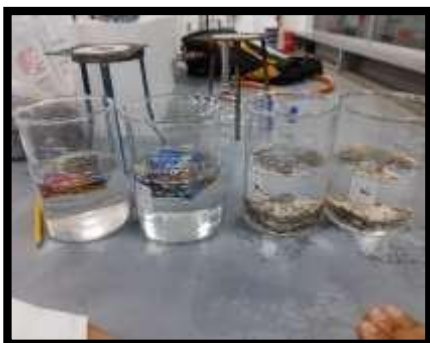
FIGURA 15: Ensayo de capacidad de absorción de agua del PET, HDPE y PP.
