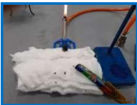
FIGURA 14. Ensayo U194 vertical de inflamabilidad a muestra de ecolamina.
