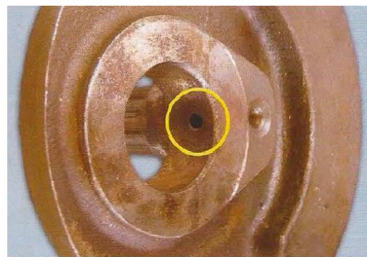
Detalle de orificio de lubricación del cigüeñal
