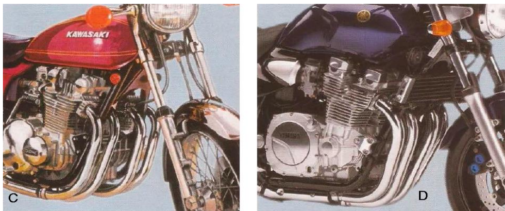
Figura 14: C- Motor con refrigeración de aire directo; D- Motor con refrigeración de aire y aceite
