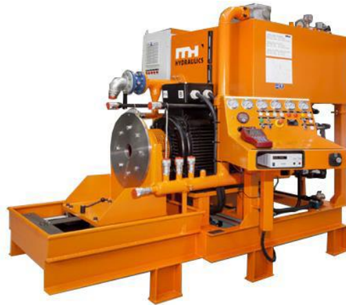
Figura 1. Banco de Pruebas para Bombas.
