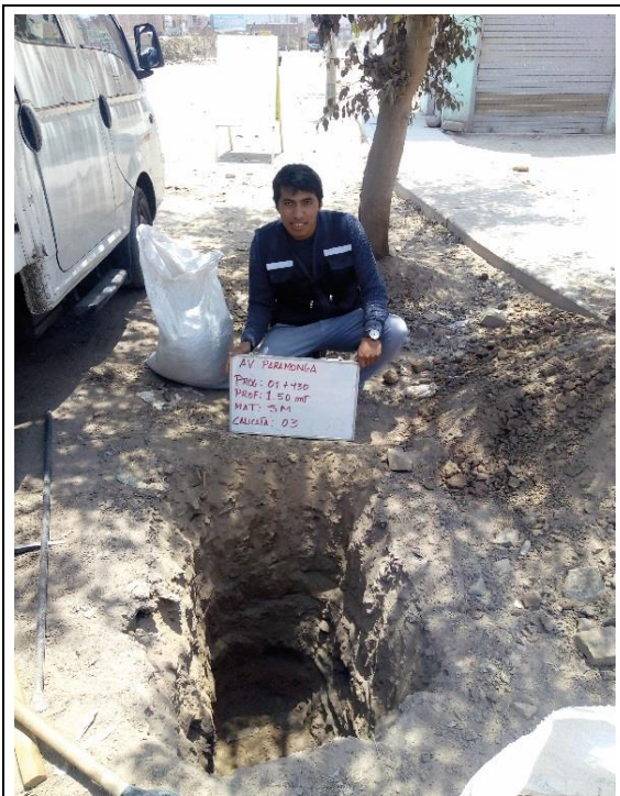
Calicata 03 : Hasta 1.50 m de profundidad presenta suelo de un solo extracto de clasificación SUCS – CL.
