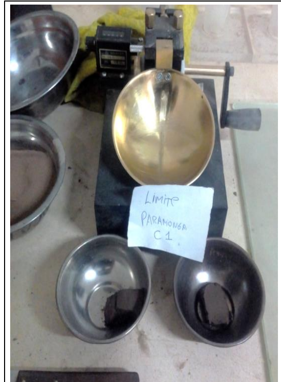
Límite Líquido: Ensayo del Límite líquido para las tres calicatas empleando la Copa de Casagrande.
