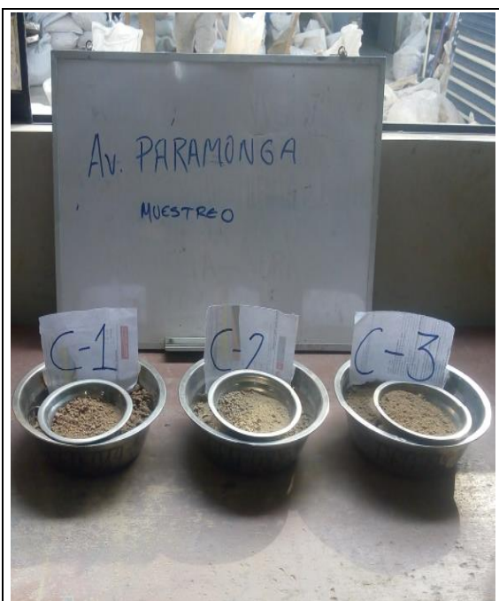
Granulometría - calicata 03: Muestras seleccionados por cuarteamiento que será pesada e introducida en horno para proceder el lavado por la malla N° 200 y volver secar las partículas retenidas en dicha malla.
