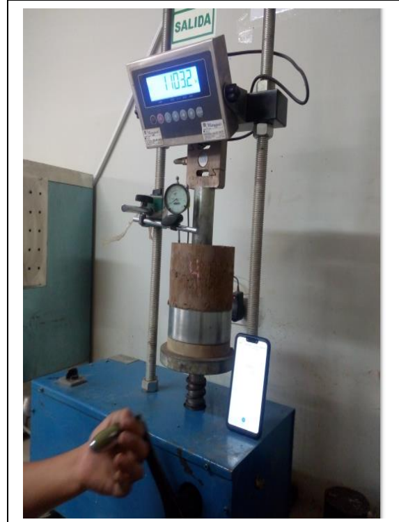
Ensayo CBR del suelo desfavorable (C-2) con Polímero AggreBind más agua: De acuerdo al dicho ensayo se procederá al diseño de pavimentos aplicando el AggreBind.
