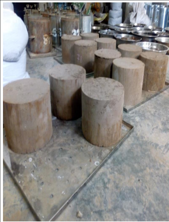
Curado de los moldes AggreBind a temperatura ambiente: El curado se realiza retirando la muestra del molde.
