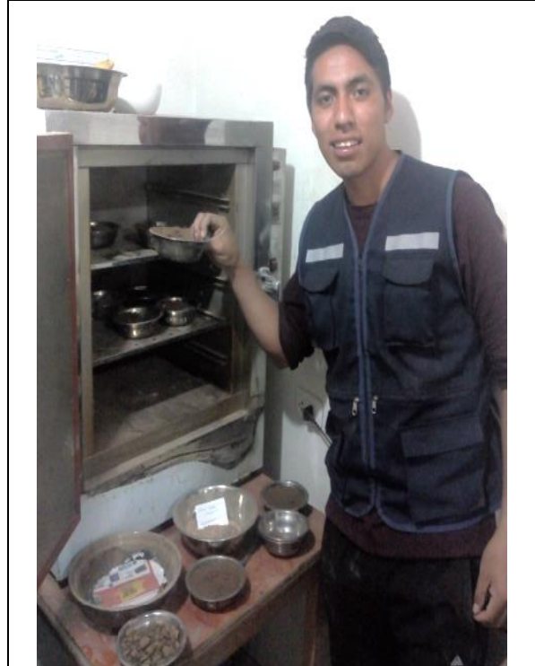
Secado en horno de la muestra obtenida del ensayo proctor modificado, con fines de calcular el OMC y la MDS
