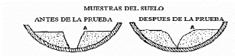
Figura 3. Ensayo Límite Líquido – Ranurado de muestra de suelo en copa de casa grande
