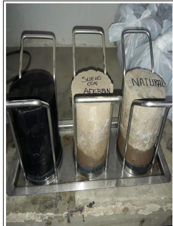
Ensayo de Capilaridad del suelo natural, con estabilizante AggreBind y sellante AggreBind.
