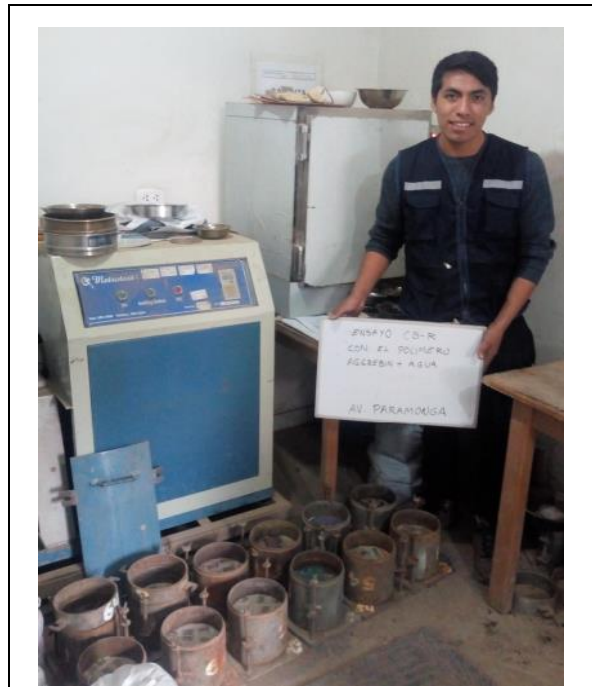
Total de Moldes (12) realizadas aplicando el AggreBind para determinar la dosificación óptima.
