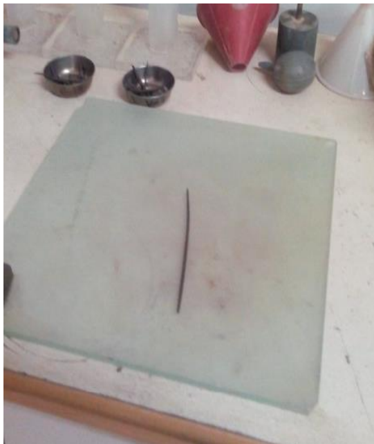
Límite Plástico: Ensayo del límite plástico para las tres muestras de suelo en cada calicata, empleando superficie de vidrio esmerilado
