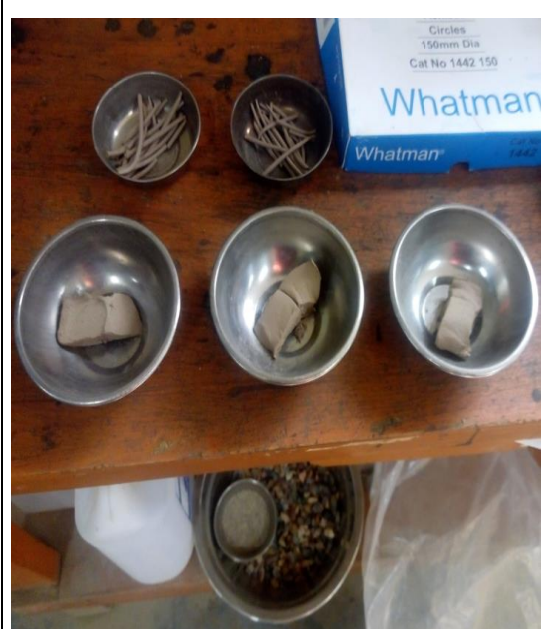
Límite Líquido y Límite Plástico: Muestras secas de límites que serán pesadas después del ensayo para obtener el contenido de humedad y luego calcular el Índice de plasticidad.
