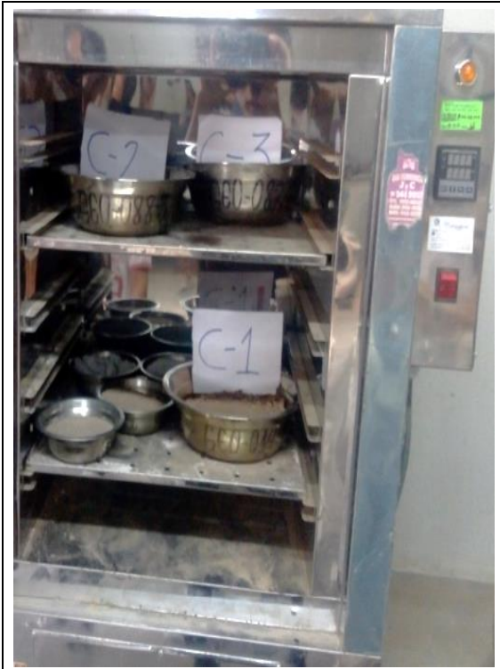
Contenido de Humedad Inicial: Muestra de suelo de las tres calicatas pesadas y sometidas al secado en horno para volver pesarlos y calcular su Contenido de Humedad inicial.
