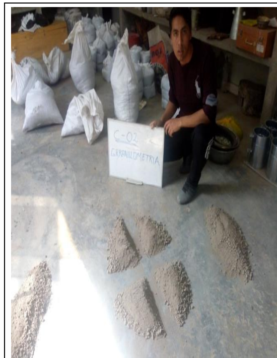
Granulometría - calicata 02: Cuarteamiento de muestra.
