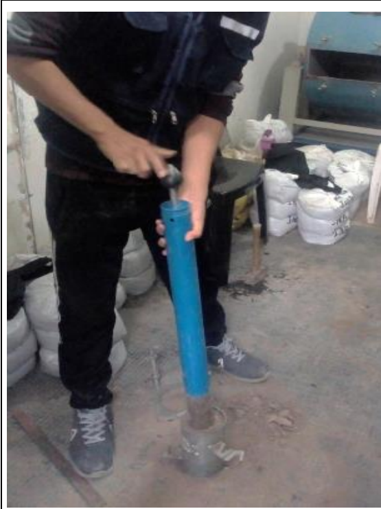
Proctor Modificado: Ensayo proctor modificado por el método A, con 3 kilos de muestra de suelo, de 5 capas de 25 golpes de acuerdo al MTC – E 115.
