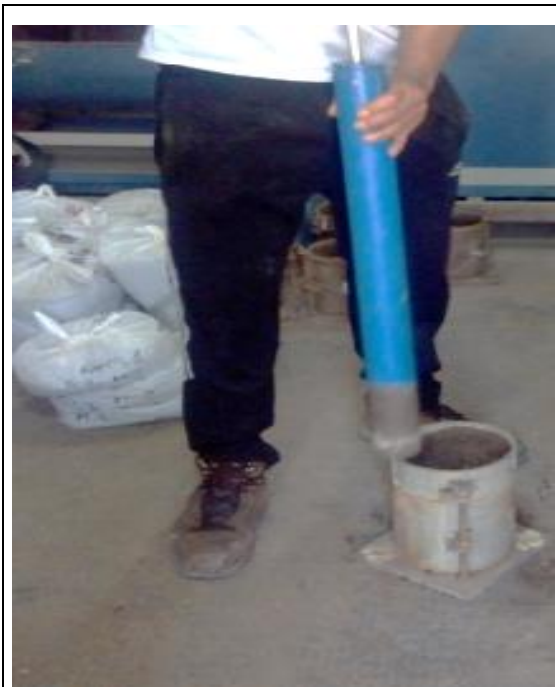
Proceso de chancado a muestra CBR con AggreBind utilizando distintas dosificaciones y 6kg de muestra de suelo con 5 capas de 12, 25 y 56 golpes.
