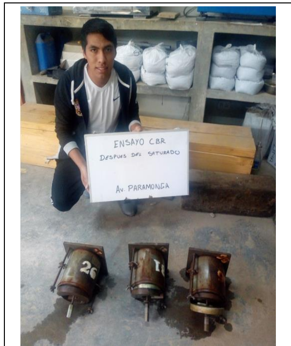
Moldes con muestras después de del proceso de saturado por 24 horas para tomar lectura de su deformación atreves del dial.
