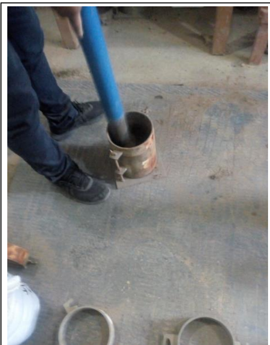
Proceso de ensayo CBR Natural del Suelo: con muestra de 6 kg, de 5 capas, para moldes de 12, 25 y 56 golpes.
