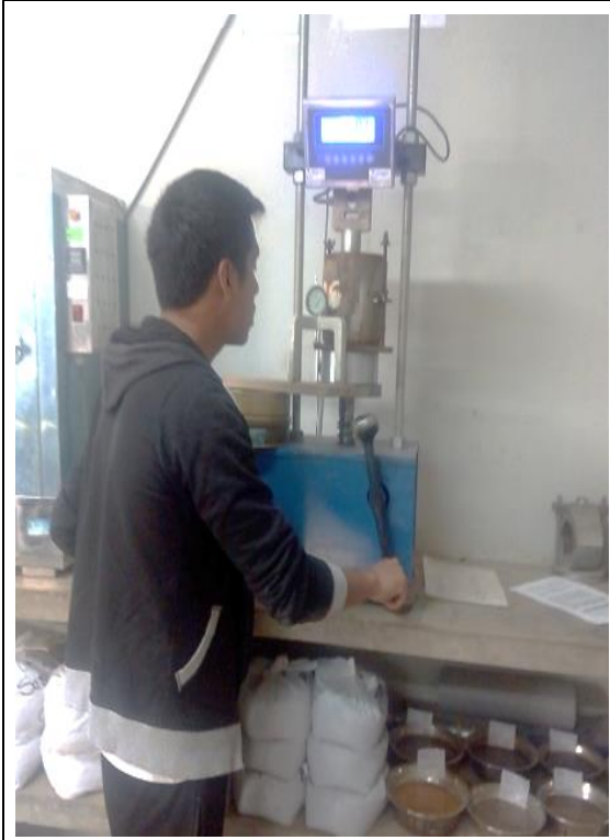
Ensayo CBR Natural del suelo para muestras de tres calicatas, a través de la prensa CBR, donde se toma lectura de cada penetración por tiempos establecidos. Con fines de determinar el suelo de la calicata más desfavorable.
