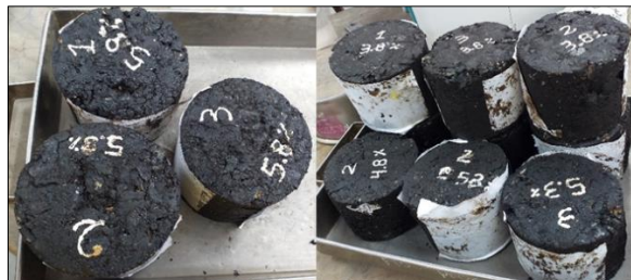
Figura N° 18: Briquetas convencionales (muestra patrón) ensayadas.
