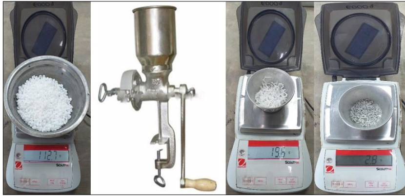
Figura N° 19: Molido para trituración del polímero SBS
