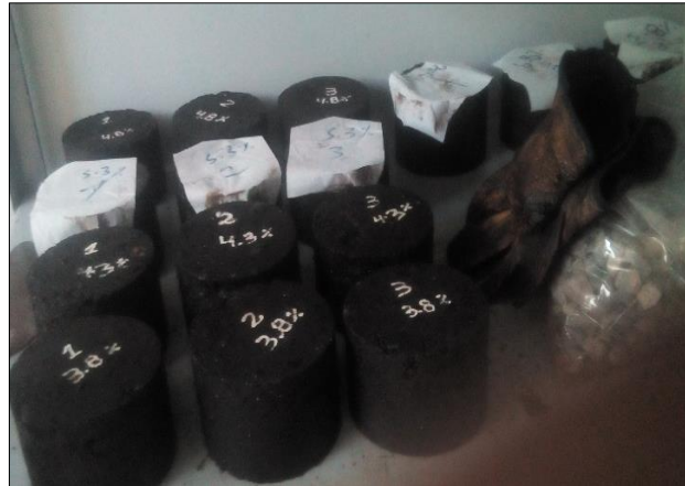
Figura N° 10: Reposo de las briquetas convencionales (muestra patrón) por un periodo de 24 horas.
