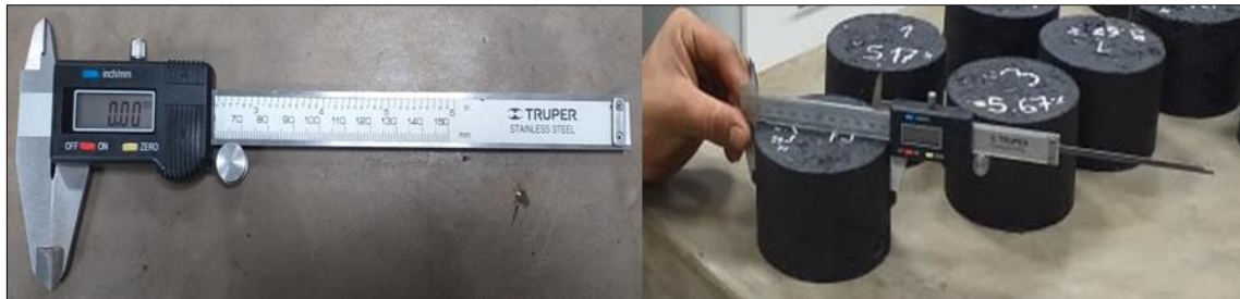
Figura N° 11: Registro de dimensiones con el calibrador vernier digital .
