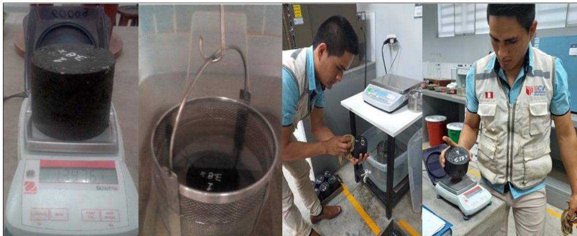
Figura N° 12: Registro de los pesos: M_s , M_{SUM} y M_{SSS}
