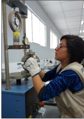
Figura N° 16: Colocar la mordaza en la prensa Marshall.
