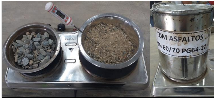
Figura N° 4: Calentar los materiales en la estufa
