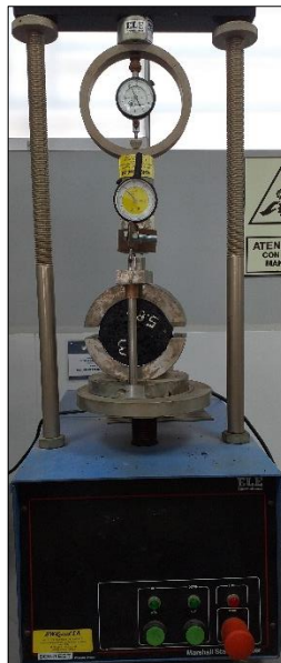
Figura N° 17: Ensayo de las briquetas en la prensa Marshall.
