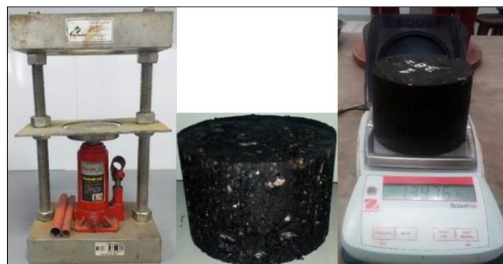
Figura N° 9: Extracción de las briquetas y registro de su peso.
