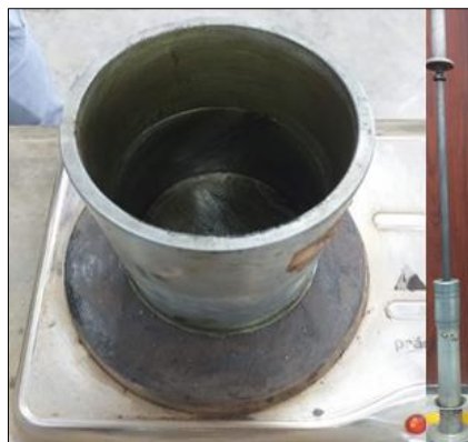
Figura N° 6: calentar el molde y martillo Marshall
