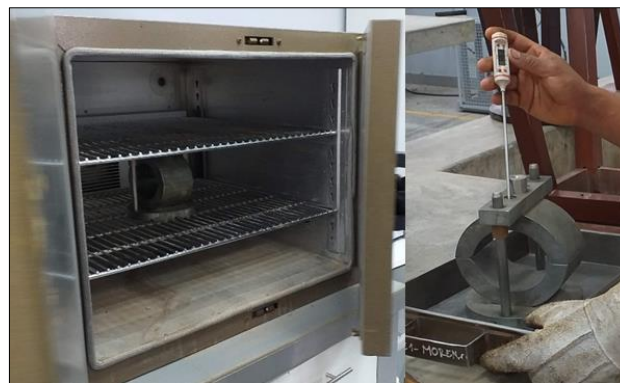
Figura N° 14: Calentar el cabezal de rotura (mordaza Marshall).
