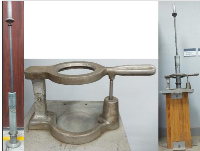
Figura N° 12: Martillo y pedestal de compactación
