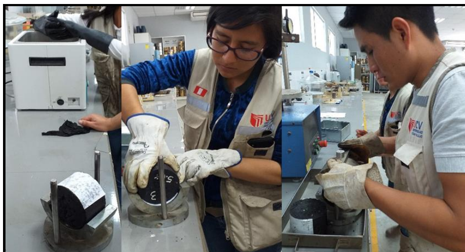
Figura N° 15: Colocar las briquetas en la mordaza Marshall.
