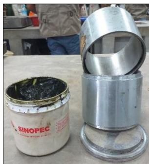
Figura N° 10: Grasa y molde Marshall
