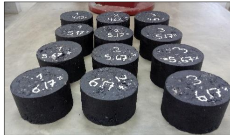
Figura N° 20: Reposo de las briquetas modificadas (muestra experimental) por un periodo de 24 horas.
