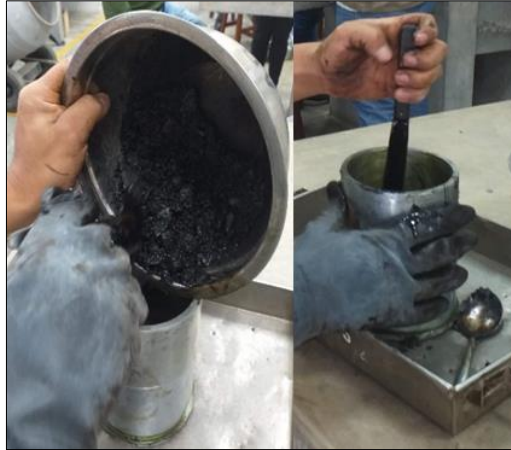
Figura N° 7: Colocar la muestra en el molde Marshall y chucear.
