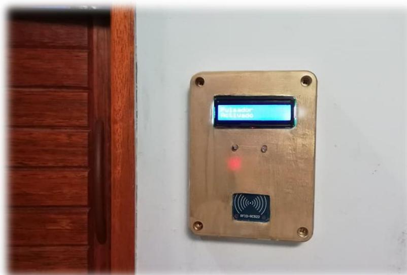
**DESCRIPCIÓN:** Como se puede apreciar nuestro prototipo fue elaborado en una caja de paso donde se observa una pantalla Led, y debajo se colocaron dos leds una Verde y otro Azul, en el que el led verde nos indicara que al insertar la tarjeta Rfid el acceso es concedido, pero si la tarjeta no se encuentra se activara el led Azul y a su vez enviara un mensaje en tiempo real indicando que el acceso esta denegado.
