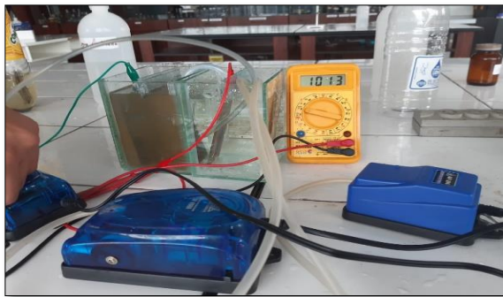
Figura A5: Medición de MiliVoltios en la celda microbiana agregando 2,097 (L/min) de oxígeno.
