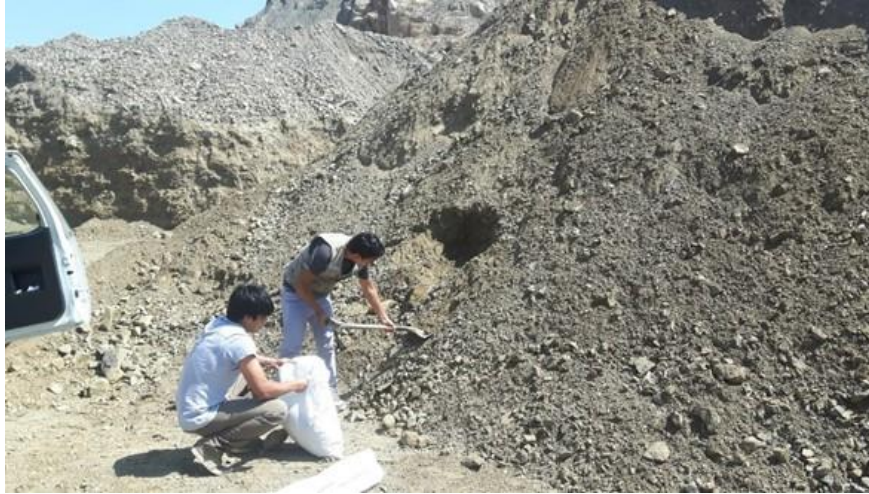
Figura 9: Muestreo de agregado combinado de la cantera Acaray Fuente: Elaboración propia
