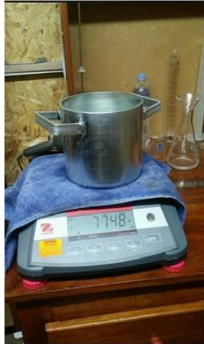
Figura 20 21: Calibración de cilindros para ensayo de peso unitario Fuente: Elaboración propia
