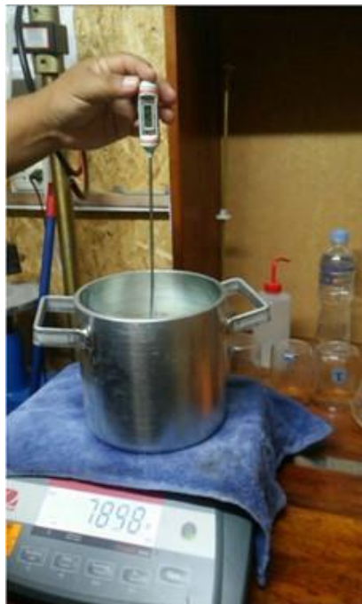
Figura 22 y 23: Calibración de cilindros para ensayo de peso unitario Fuente: Elaboración propia
