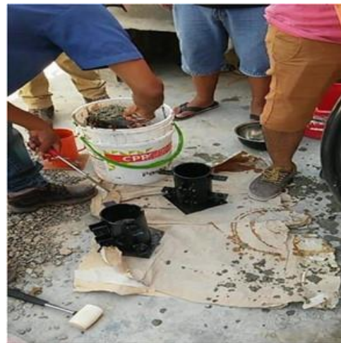
Figura 28 y 29: Elaboración probetas de concreto con de plástico PET al 3.5 %, 9.5 % y 12.5 %
