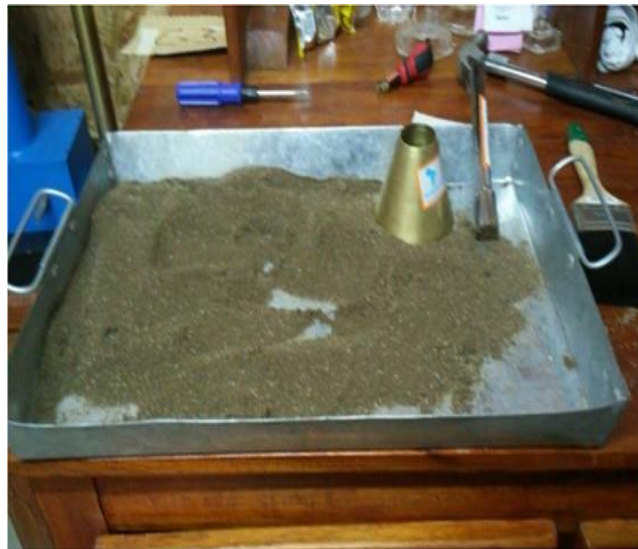
Figura 15: Secado superficial del agregado fino Fuente: Elaboración propia
