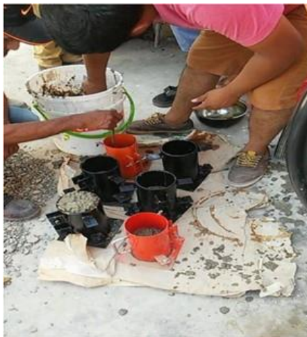
Figura 28 y 29: Elaboración probetas de concreto con de plástico PET al 3.5 %, 9.5 % y 12.5 %
