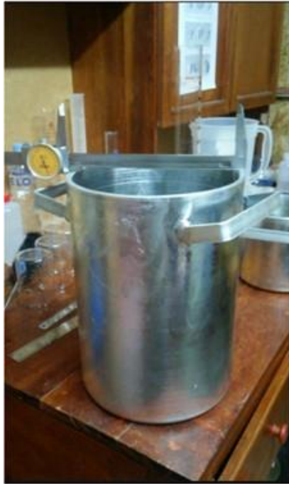
Figura 20 21: Calibración de cilindros para ensayo de peso unitario Fuente: Elaboración propia
