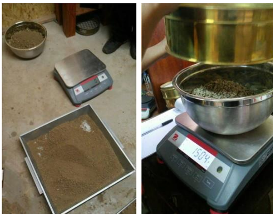
Figura 11 y 12: Ensayo granulométrico de agregado combinado de la cantera Acaray Fuente: Elaboración propia
