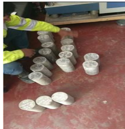
Figura 32 y 33: ensayo a la compresión de testigos cilíndricos
