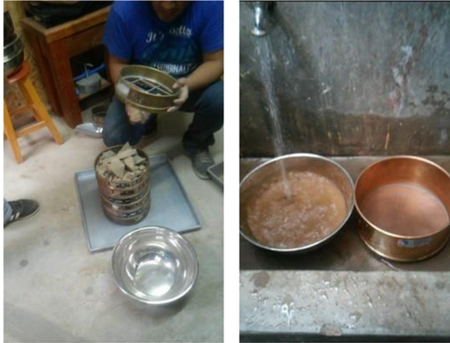
Figura 13 y 14: Ensayo granul. del agreg. grueso y lavado de agreg. fino de la pasante # 200.
