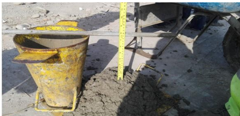
Figura 31: Ensayo de asentamiento de concreto fresco Fuente: Elaboración propia
