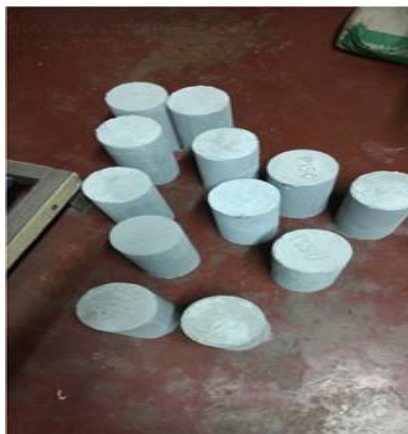
Figura 32 y 33: ensayo a la compresión de testigos cilíndricos
