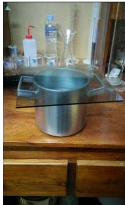
Figura 22 y 23: Calibración de cilindros para ensayo de peso unitario Fuente: Elaboración propia
