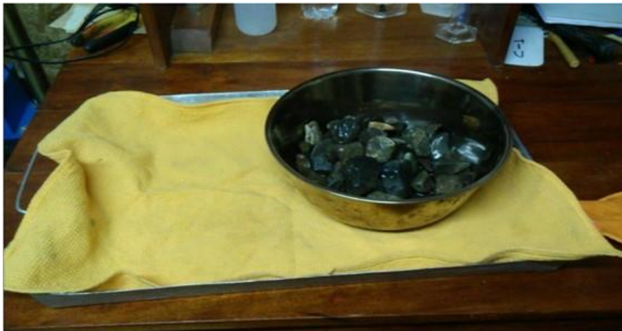
Figura 18: Secado superficial del agregado grueso Fuente: Elaboración propia
