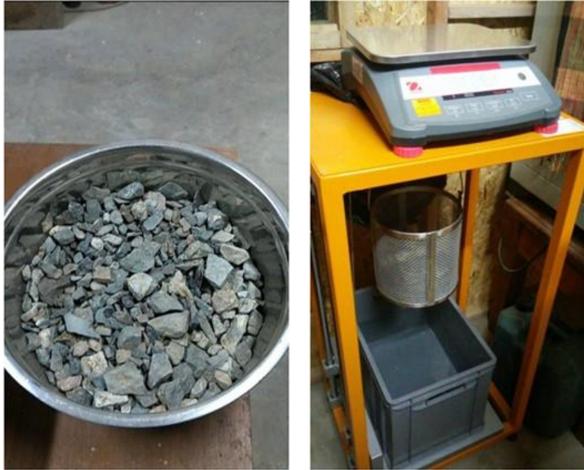
Figura 16 y 17: Ensayo de peso específico del agregado grueso Fuente: Elaboración propia
