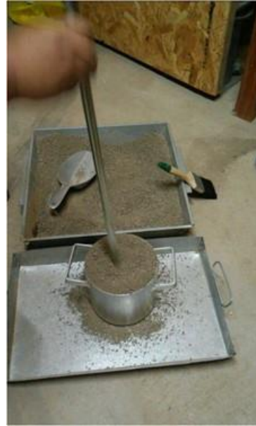
Figura 24 y 25: Ensayo de peso unitario sin varillar y varillado Fuente: Elaboración propia
