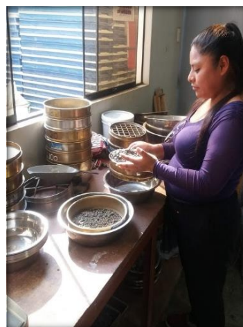
Figura 11. Cuarteo del material fresado Figura 12. Proceso de tamisado del material fresado
