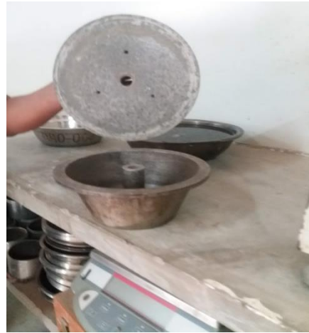
Reciente del equipo de lavado asfáltico
