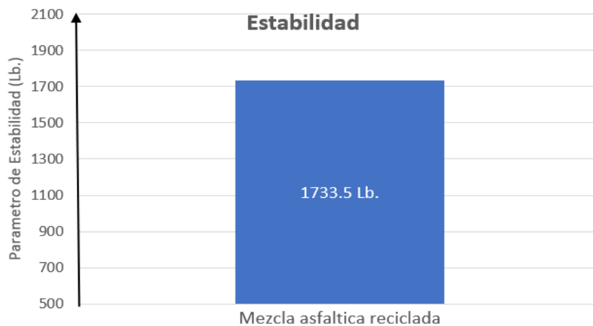
Figura 37. Estabilidad de la mezcla vs parámetro de Control
