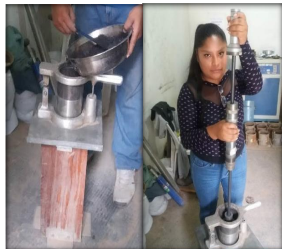
Figura 20. Compactacion de la mezcla
