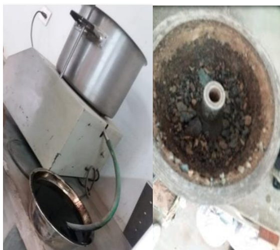
Figura 9. Equipo de lavado asfaltico
