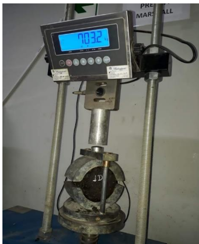
Ensayo Marshall para cada probeta para determinar sus propiedades
