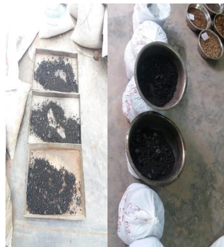
Mezclas expuestas al aire libre, para que pierdan peso por aireación
