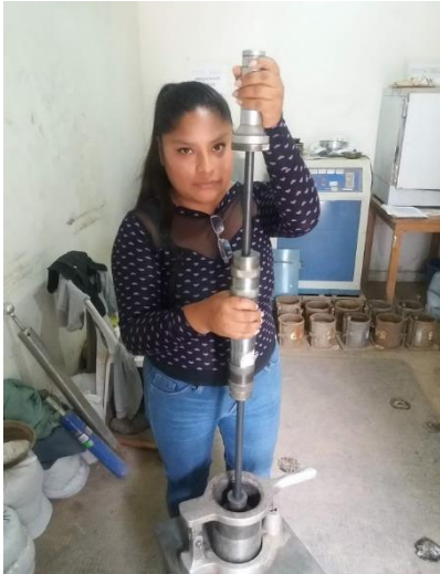
Compactación de la mezcla
