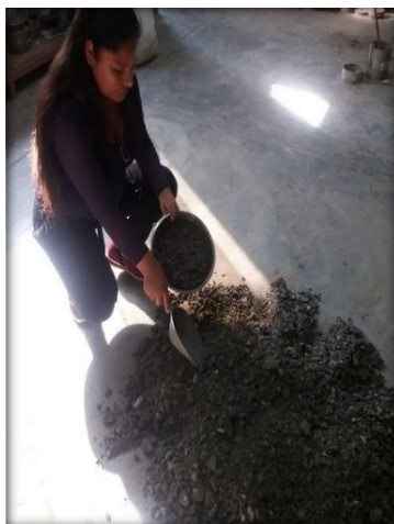
Figura 11. Cuarteo del material fresado Figura 12. Proceso de tamisado del material fresado
