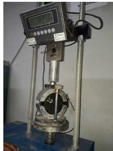
Ensayo Marshall para cada probeta para determinar sus propiedades
