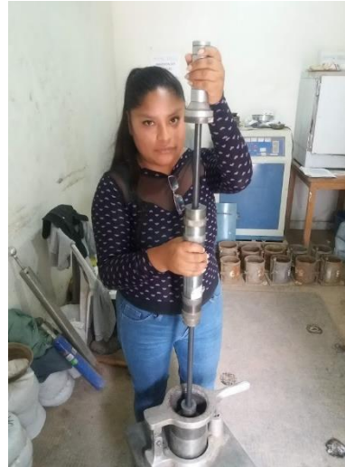
Compactación de la mezcla
