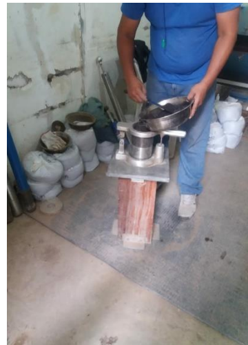
Vaciado de la mezcla al molde
