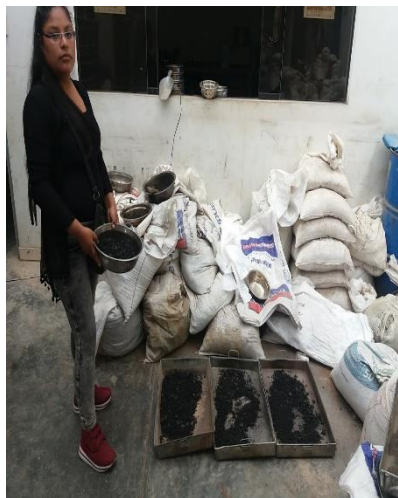
Mezclas expuestas al aire libre, para que pierdan peso por aireación
