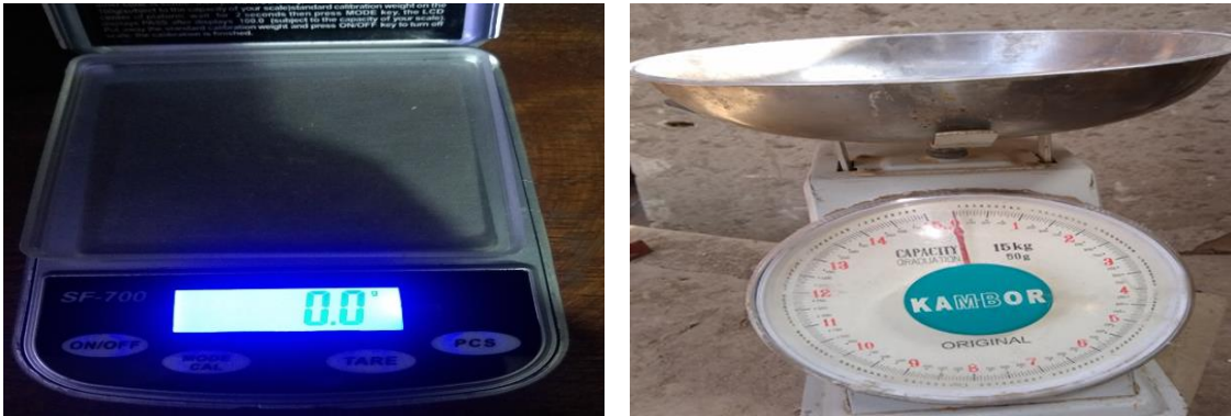
Figura 16. Balanza en gr para el peso de las perlas y balanza en kg para la arena y cemento
