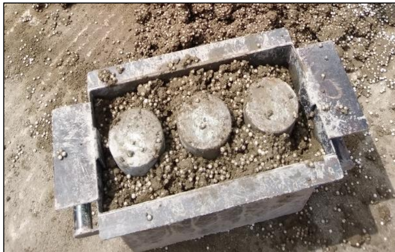
Figura 19. Compactación y llenado de concreto
