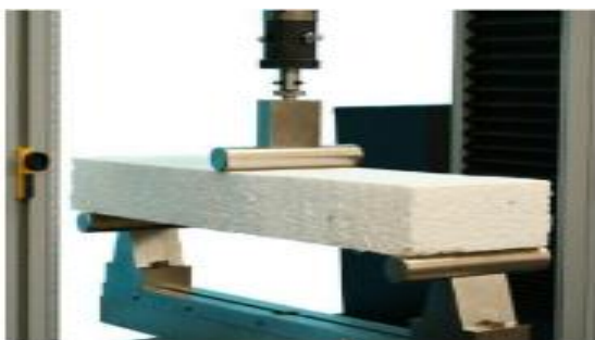
Figura 11. Ensayo de Rotura en bloque
