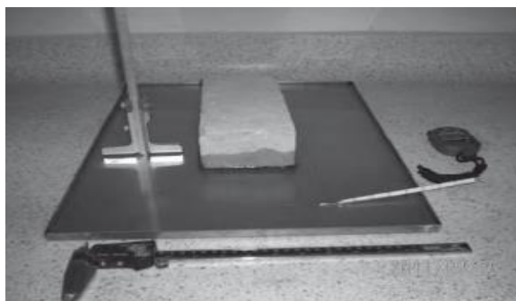
Figura 13. Bloque de concreto en la prueba de absorción
