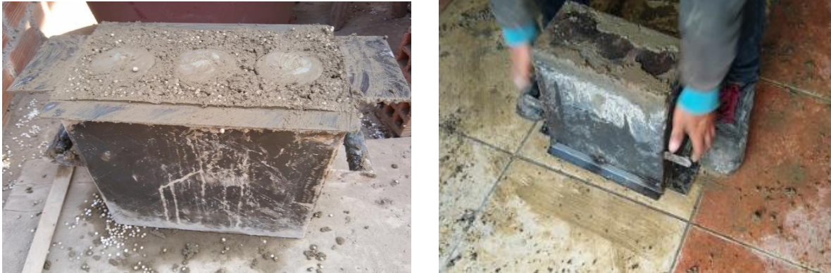
Figura 20. Compactado final del concreto ligero.
