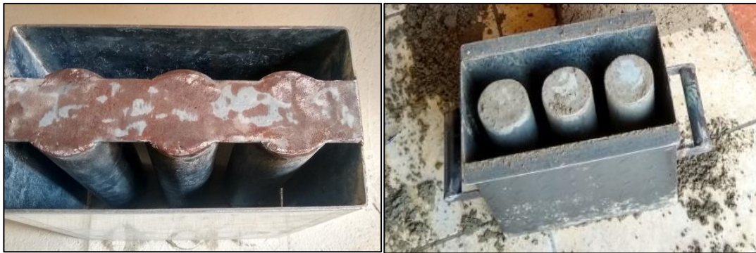
Figura 14. Molde empleado para los bloques.
