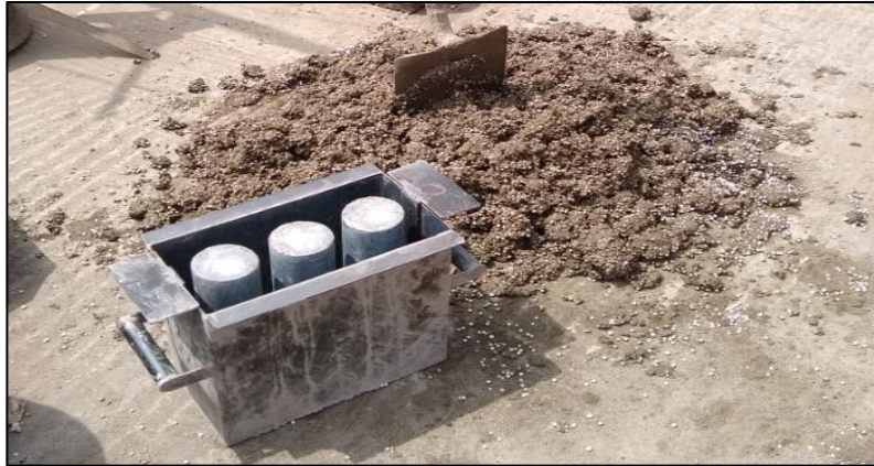
Figura 18. Llenado del molde.
