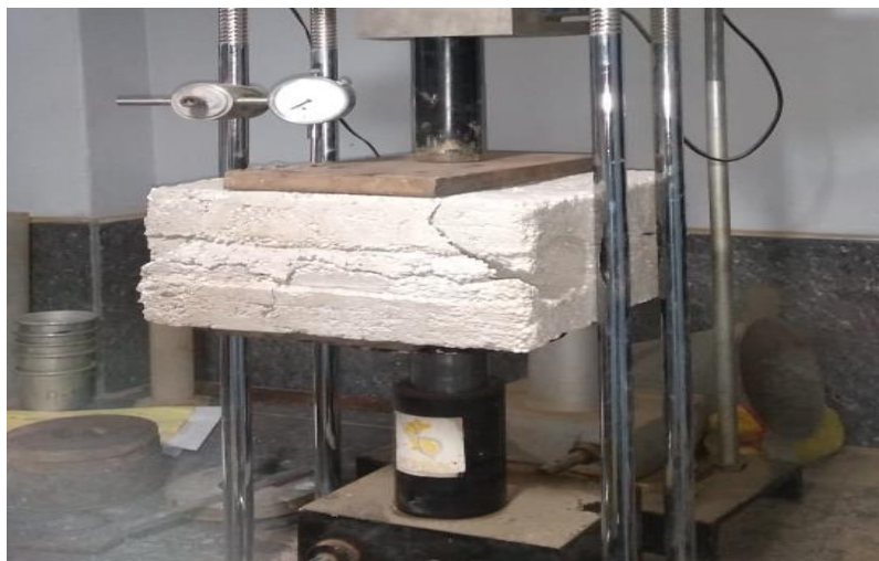
Figura 49. Bloque de concreto fracturado.
