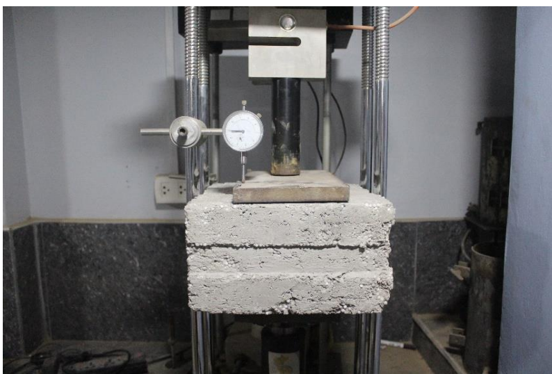
Figura 47. Bloque de concreto fracturado.
