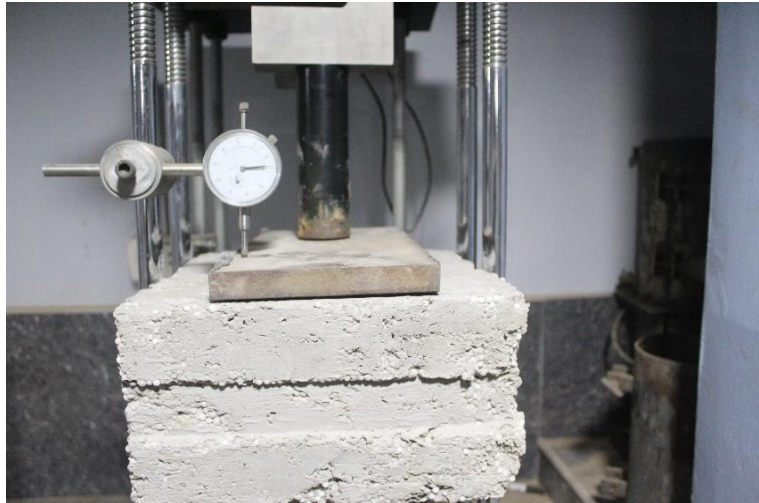
Figura 48. Ensayo de resistencia a la compresión.
