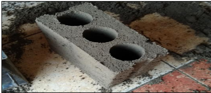
Figura 23. Bloque de concreto, con el diseño alveolar realizado con el molde fabricado.
