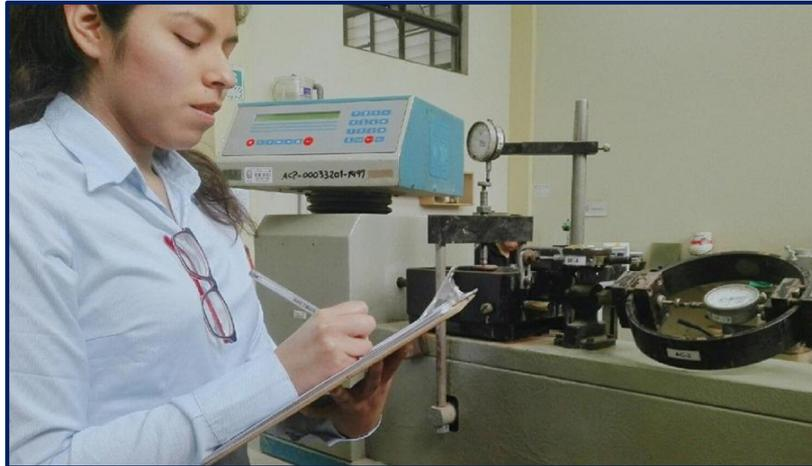
Figura 36: Ensayo de corte directo ( UNI)
