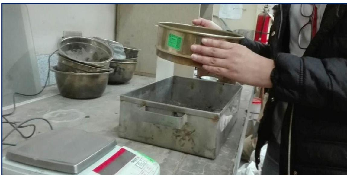
*Figura 22:* Granulometría en laboratorio (UNI)
