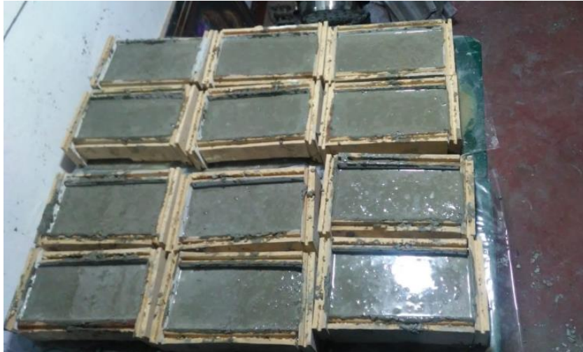
Figure 16 Adoquines de concreto en mesa vibradora mecánica
