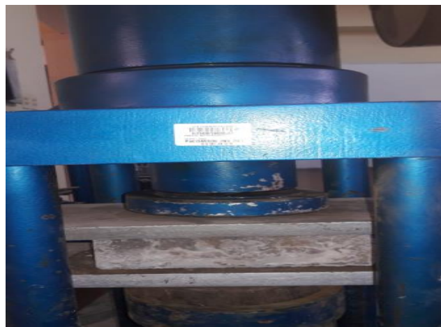
Figure 21 Adoquín sometido al ensayo de resistencia a compresión
