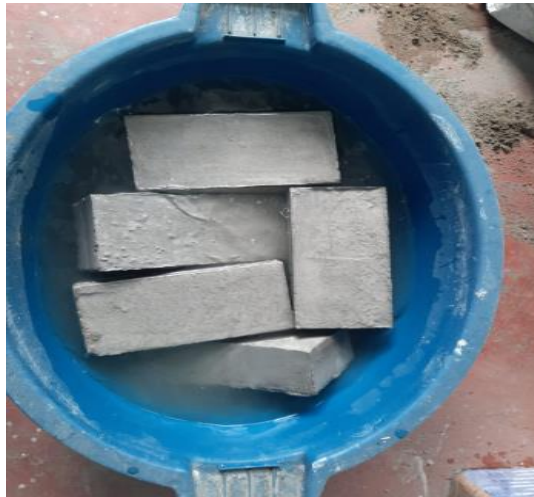
Figure 18 Curado de adoquines de concreto
