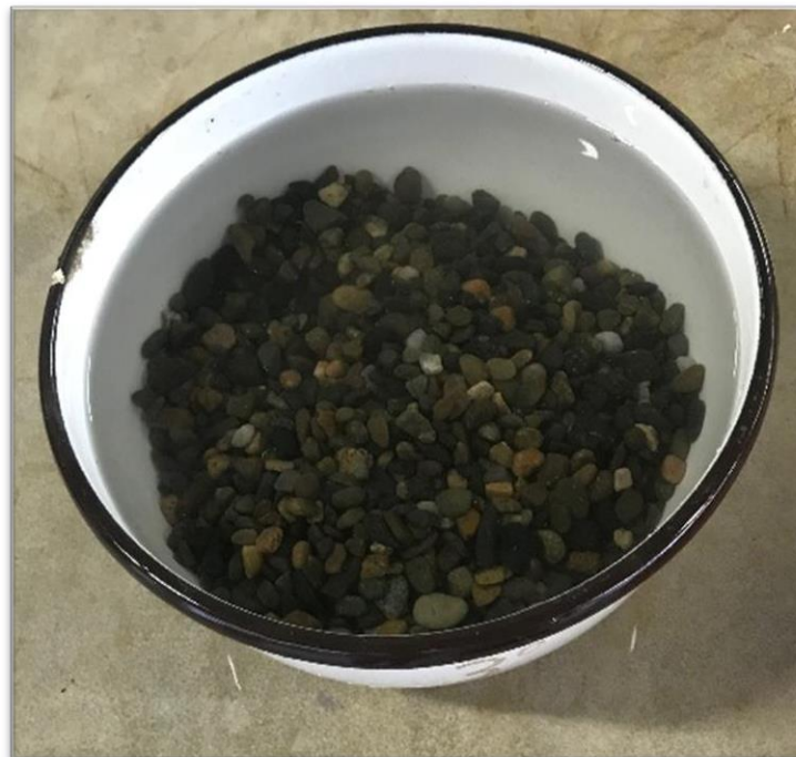
Figura 2. Lavado de agregado grueso
