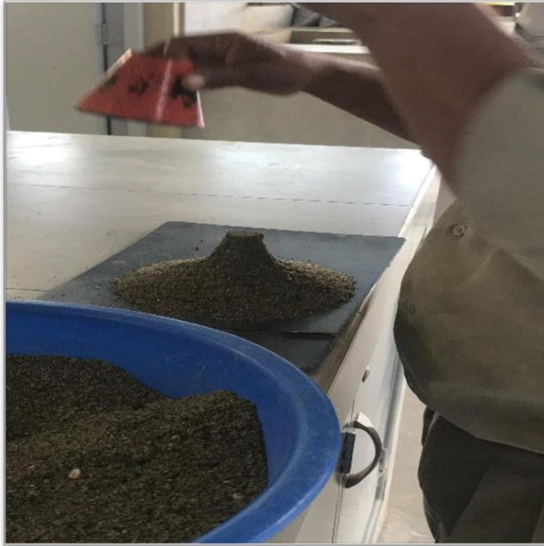
Figura 5. Método del cono para calcular las propiedades del agregado fino
