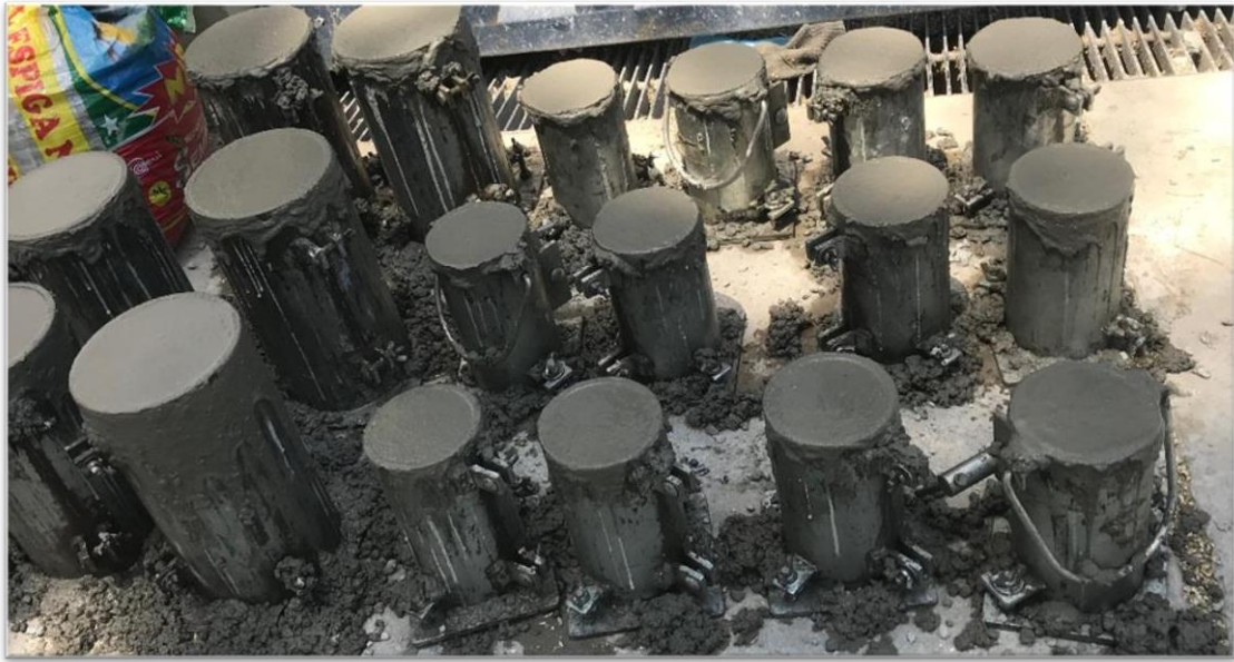
Figura 13. Probetas al 10, 20 y 30 % con reemplazo de PET
