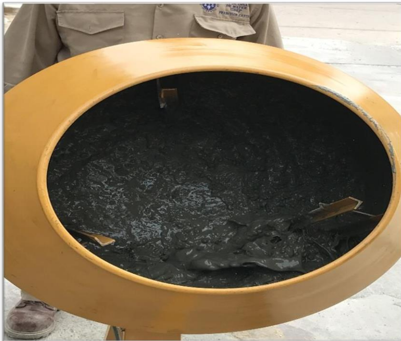
Figura 12. Mezclado en el trompo: agregado Fino, agregado Grueso, cemento, PET y agua
