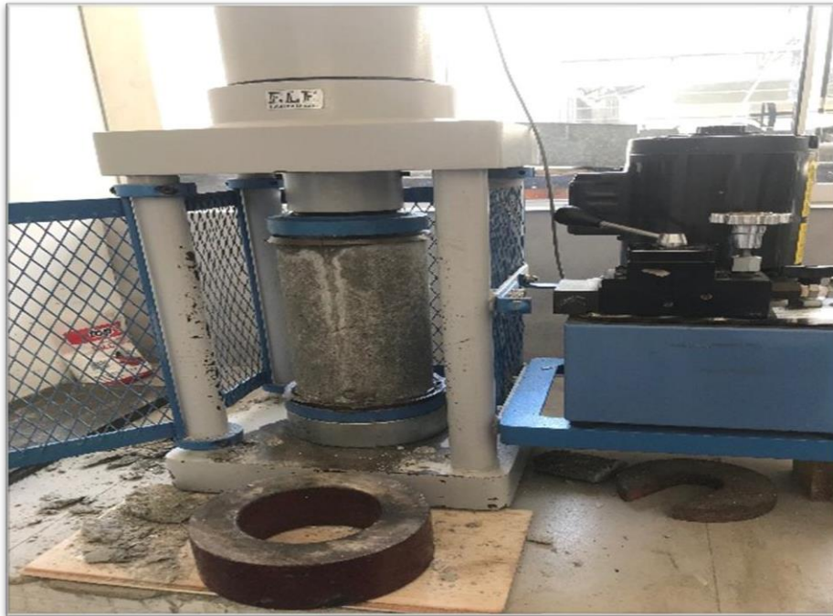
Figura 16. Ensayo a compresión de las probetas (7 días)
