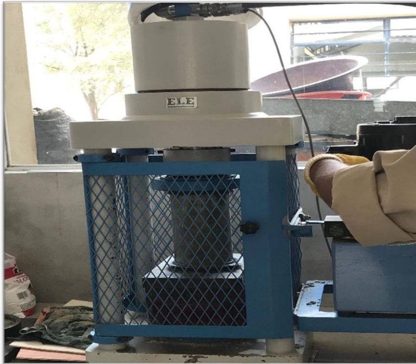
Figura 17. Ensayo a compresión de las probetas (28 días)
