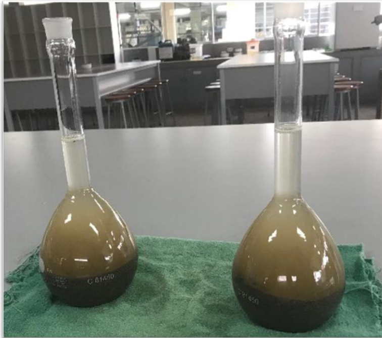
Figura 7. Llenado de Fiolas con muestra de agregado fino
