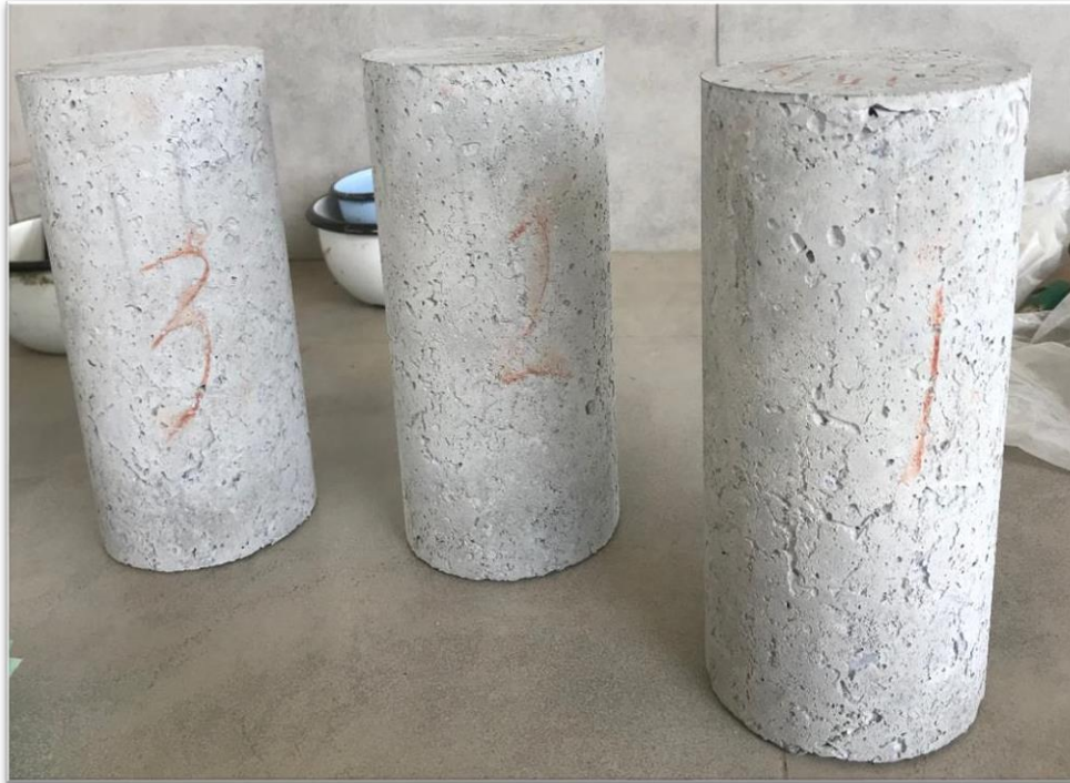
Figura 21. Probetas salidas del horno, después de su ensayo de absorción
