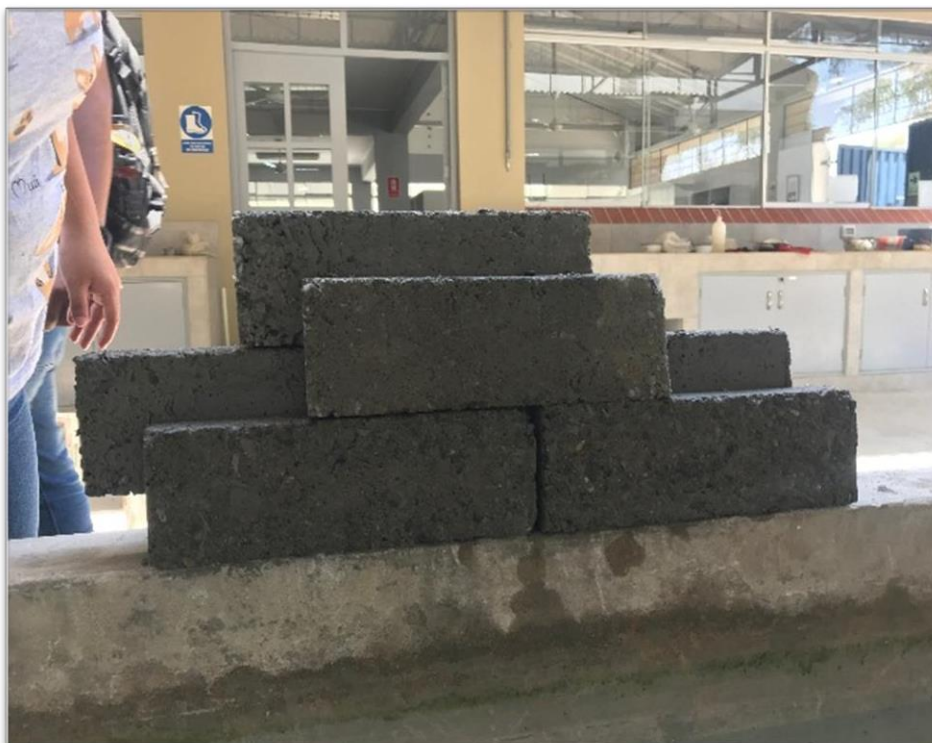
Figura 24. Muro con uso de bloqueta ecológica al 30% PET
