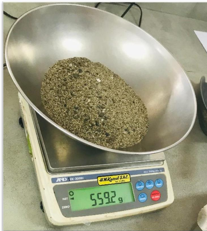
Figura 8. Peso de muestra de agregado fino
