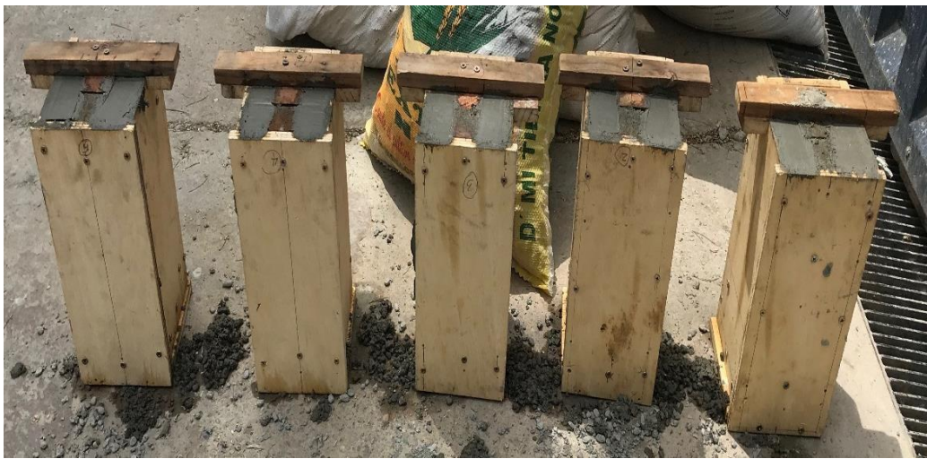
Figura 20. Llenado de moldes con la dosificación óptima de plástico PET
