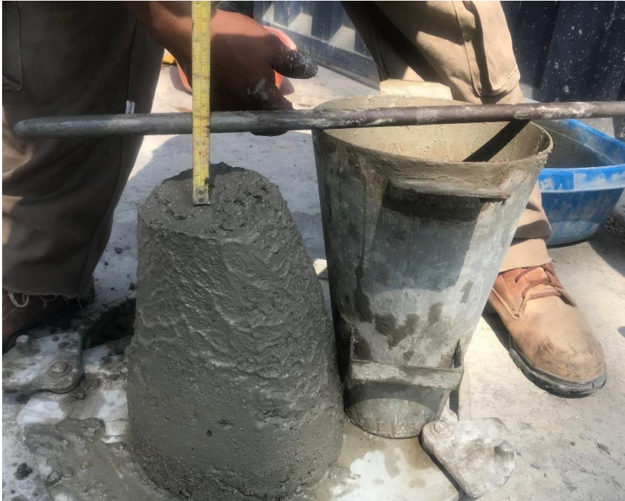
Figura 11. Medición del Slump
