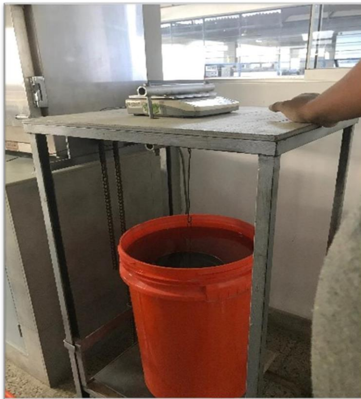
Figura 9. Peso específico del plástico Pet
