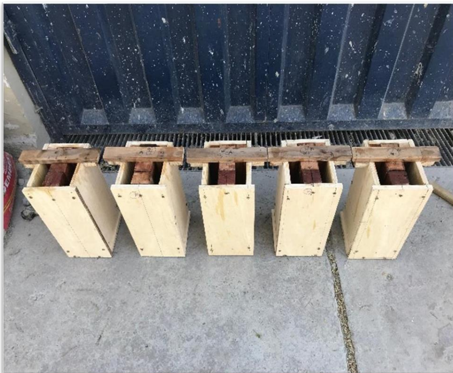
Figura 18. Moldes para las bloquetas
