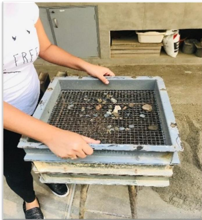
Figura 1. Tamizado de agregado grueso
