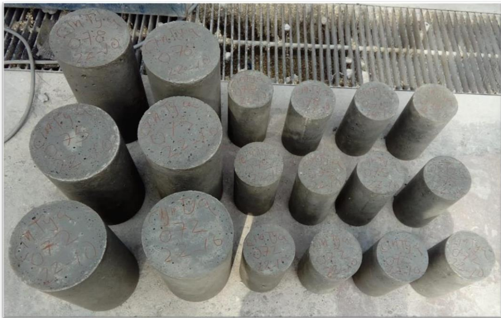
Figura 14. Probetas listas para ser introducidas a la posa de agua.
