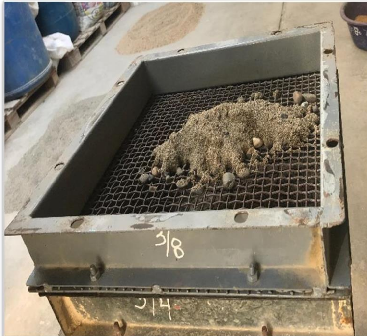
Figura 4. Tamizado de agregado grueso
