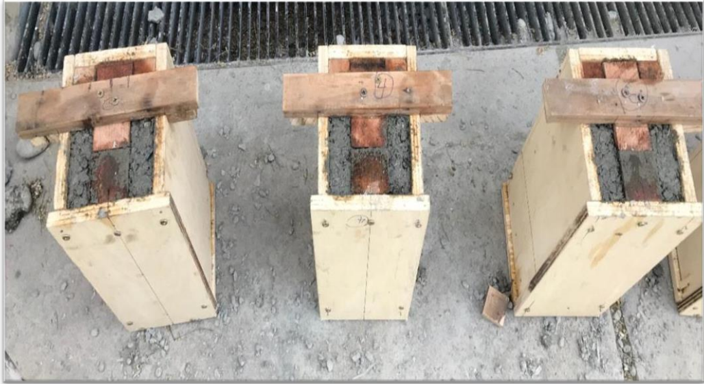
Figura 19. Vaciado de moldes para la elaboración de bloquetas ecológicas
