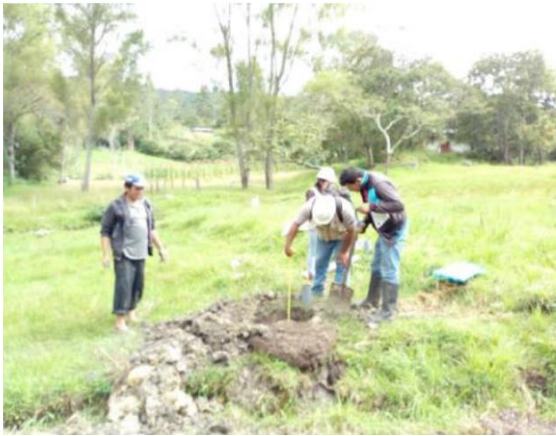
Midiendo la profundidad de calicata C-1
