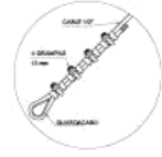
DETALLE 6 ELEMENTO DE SUJECION DE VARILLA ESCALA: 1/5
