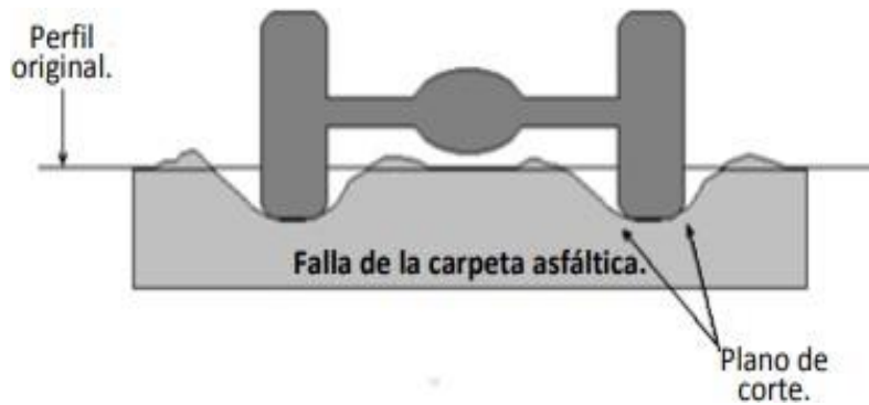
Figura 10: Ahuellamiento producido por falla de la carpeta asfáltica
