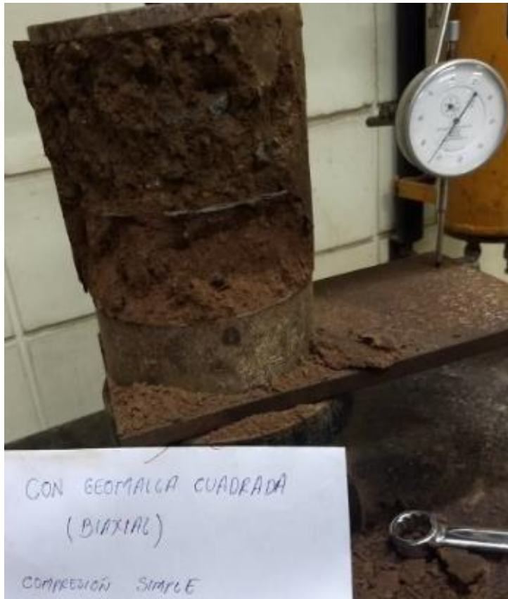
Fotografía 5. Espécimen con refuerzo de geomalla biaxial
