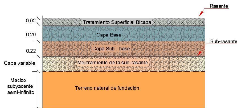
Fuente: Ramón, 2008: Sección transversal – Pavimento Flexible
