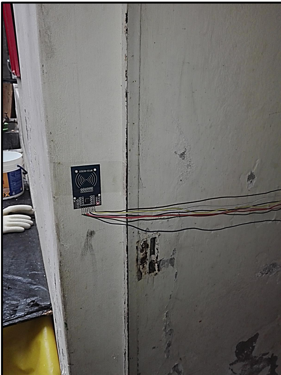
Anexo 77: evidencia 1 – módulo RFID empotrado en la entrada y salida del almacén
