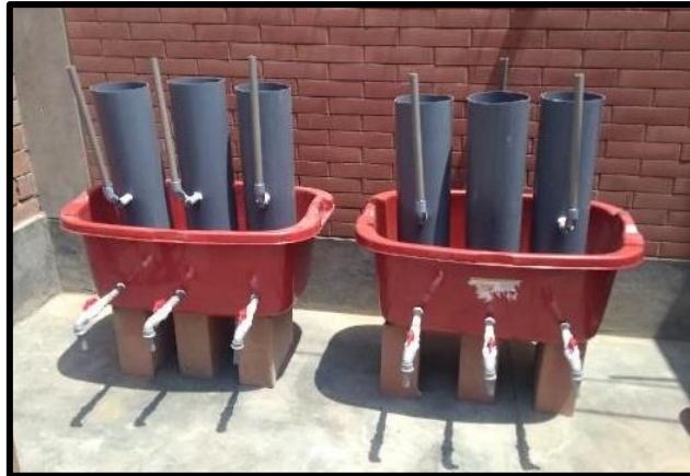
Figura 35. Ensamblado de tuberías de emisión de gases
