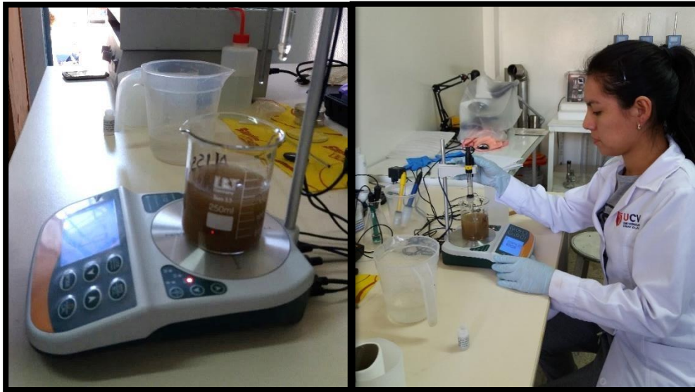
Figura 21. Medición de la conductividad eléctrica
