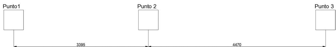
Figura 2.- Distancias entre los puntos de apoyo.
