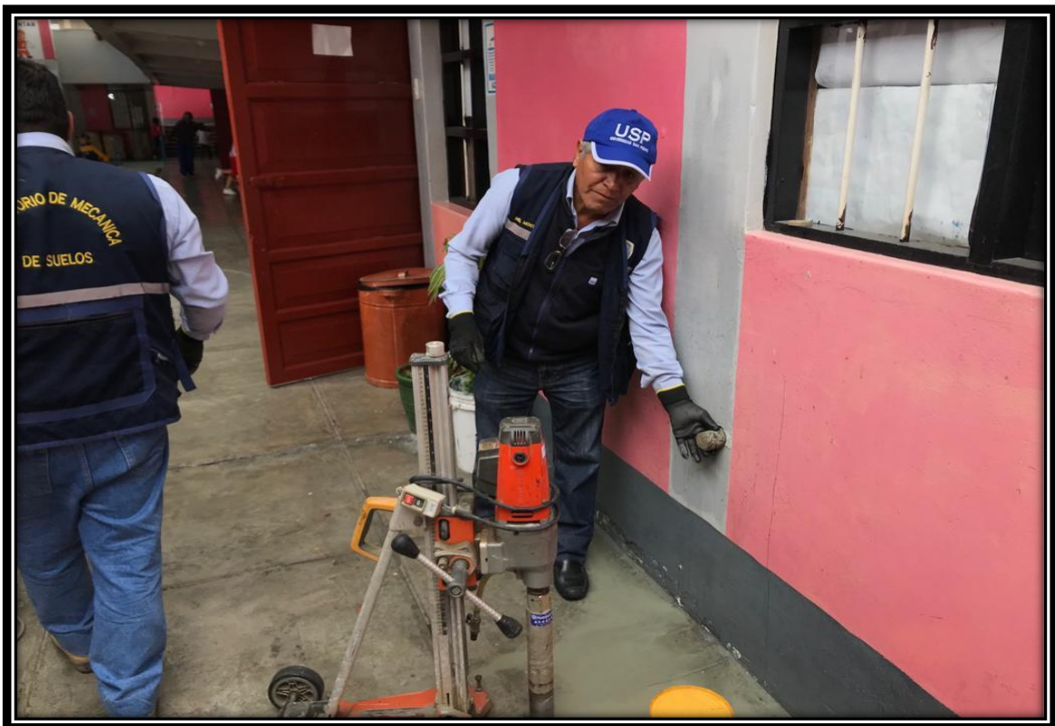
Figura 34: Prueba de diamantina Fuente: Elaboración propia
