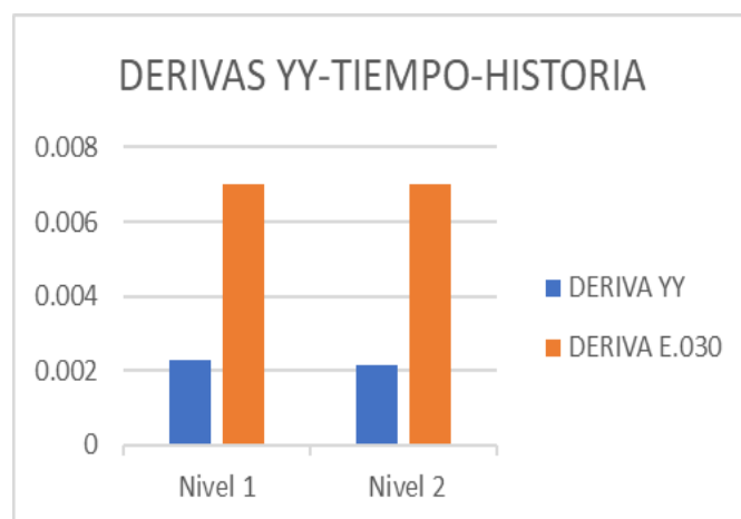
Figura 75: Derivas inelásticas-eje YY-estructura actual-análisis tiempo-historia
