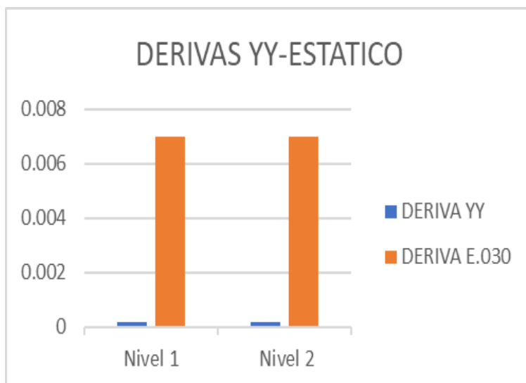
Figura 126: Derivas inelásticas-dirección YY-estructura actual -análisis estático
