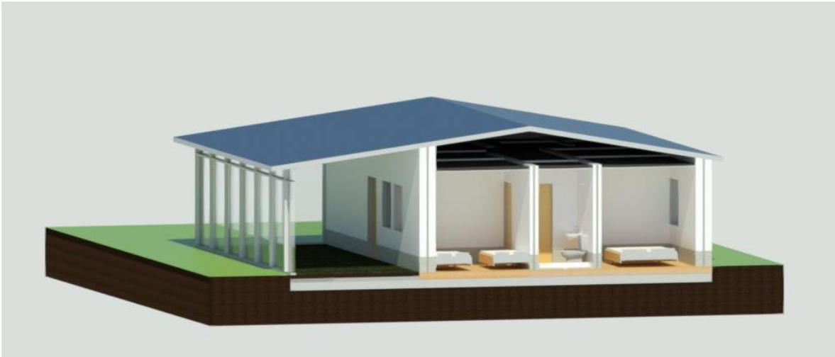
Se puede apreciar que la vivienda cuenta con un falso cielo raso para evitar las pérdidas de calor, la misma que servirá para ventilar la cocina y el baño y pasar las tuberías de sistemas eléctricos. El hacer llegar los muros hasta el falso cielo raso les genera la privacidad a cada ambiente. El piso se está trabajando con madera y en el exterior – patio se considera colocar grava debajo del terreno para sobre ella colocar la tierra apisonada y jardín.
