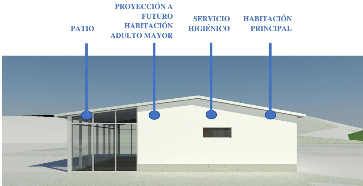
El patio está cerrado con unas paredes de vidrio podría trabajarse con un elemento local como cuero o lana para conservar el calor para los animales, éste área no tiene un falso techo pero si se ha previsto colocar paja entre las calaminas para evitar la perdidas de calor. Se está colocando solo el muro para poder hacer el cerramiento del patio esto es una proyección futura de la habitación del adulto mayor.
