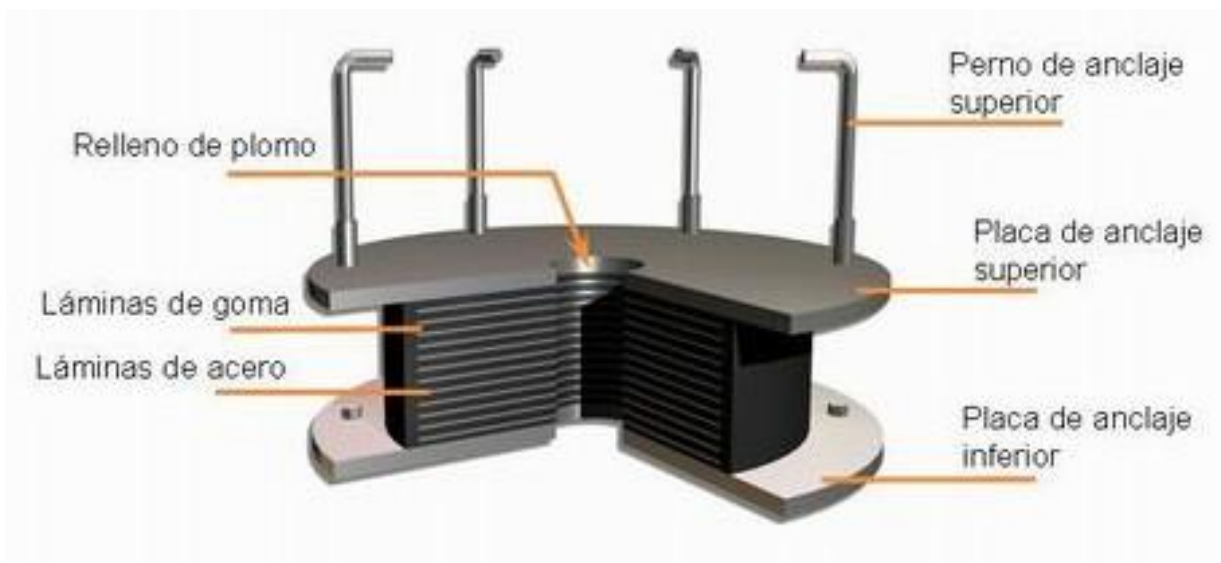
Figura 7. Aislador elastómero con núcleo de plomo (LRB)
