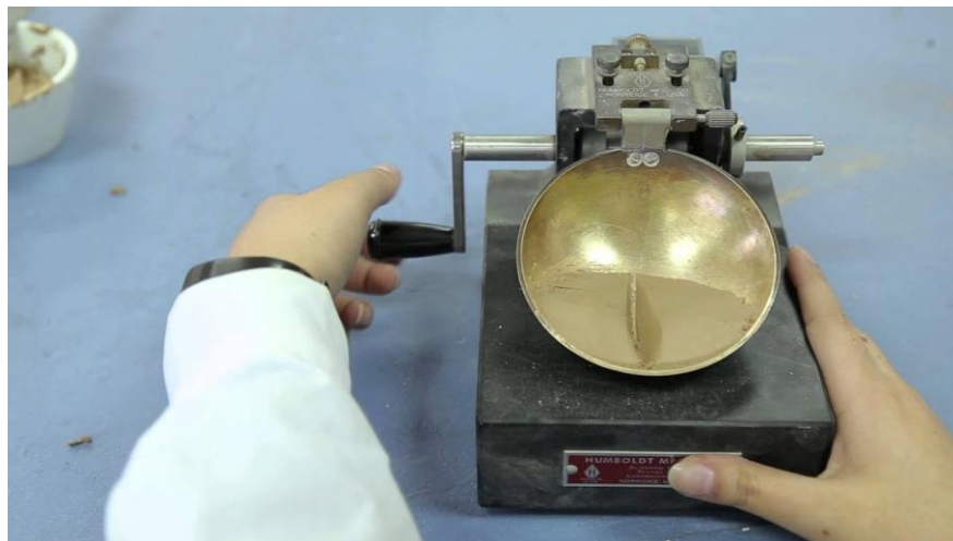
Ilustración 2. ENSAYO LÍMITES DE ATTERBERG
