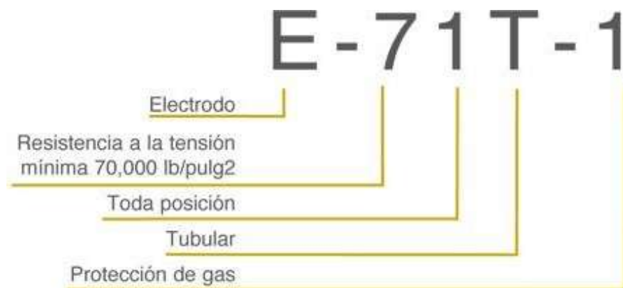
Figura 2: Clasificación de electrodos con núcleo de fundente
