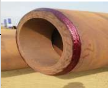
Aplicación del Penetrante J-15 A NDT Tistes Penetrantes
