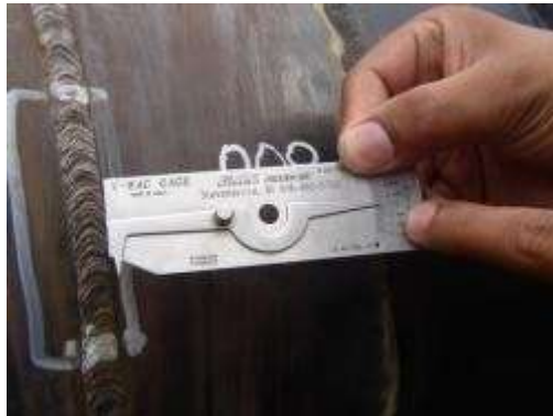
Figura 5: Inspección de juntas con uso galga
