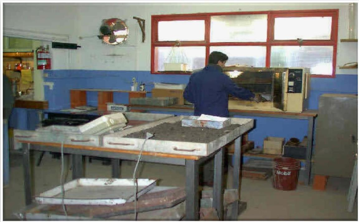
**Imagen N° 18:** Ensayo de contenido de humedad y granulometría
