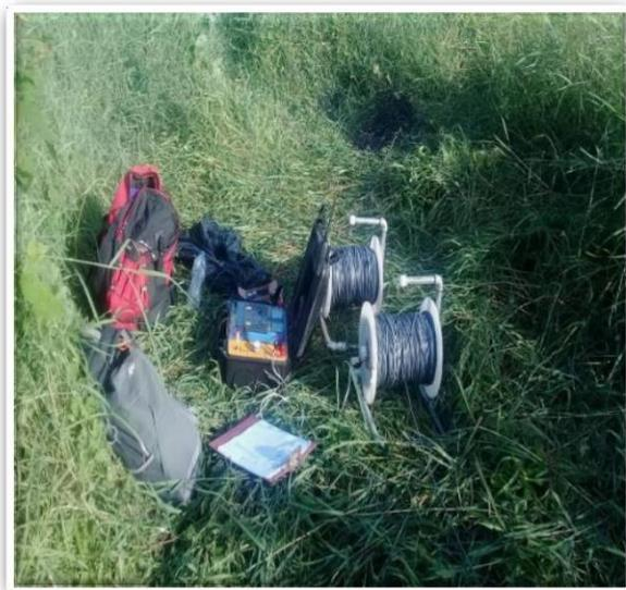
**Imagen N° 09:** Materiales para sondeos eléctricos verticales
