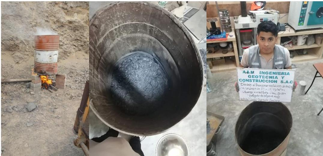
*Figura 14:* Proceso de incineración de las hojas de maíz.
