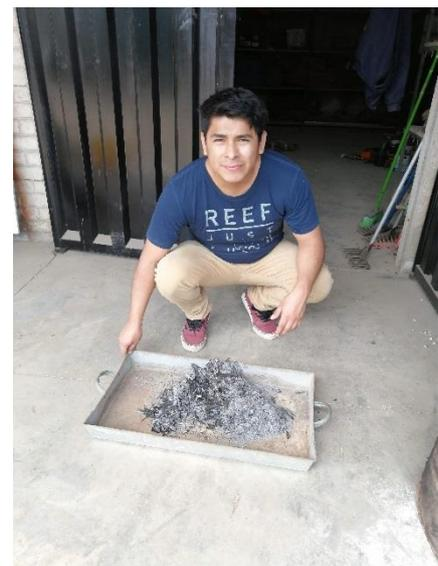
**Imagen N°13:** Una vez obtenida las cenizas de maíz se procede al pesado de esta para llevar un mejor control de nuestra investigación, posteriormente estas cenizas de maíz se tamizarán.
