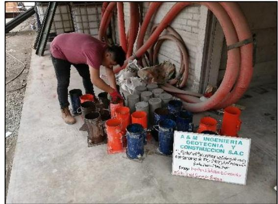
**Imagen N°56:** Una vez aceptada la mezcla de concreto patrón mediante el ensayo del slump, se procede a ensayar los especímenes cilíndricos de concreto como se puede apreciar en la imagen. Se optó sacar 03 muestras por cada edad a ensayar, es decir, para cada edad vamos a tener 03 probetas la cual el resultado será el promedio de los valores arrojados por estas probetas.
