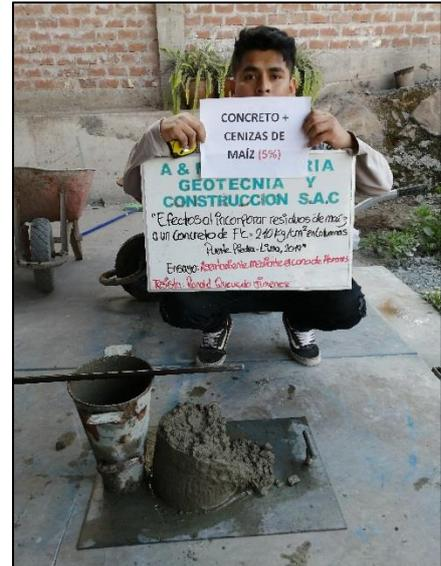
**Imagen N°50:** Se observa en la imagen el resultado de asentamiento obtenido para el concreto experimental del 5% de sustitución de cenizas de maíz por cemento es de 4.2”.
