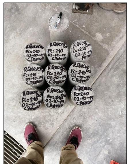
**Imagen N°58:** Una vez aceptada la mezcla del concreto experimental del 5% de sustitución de cenizas de maíz por cemento mediante el ensayo del slump, se procede a ensayar los especímenes cilíndricos de concreto como se puede apreciar en la imagen. Las edades a ensayar las probetas serán a los 07, 14 y 28 días.
