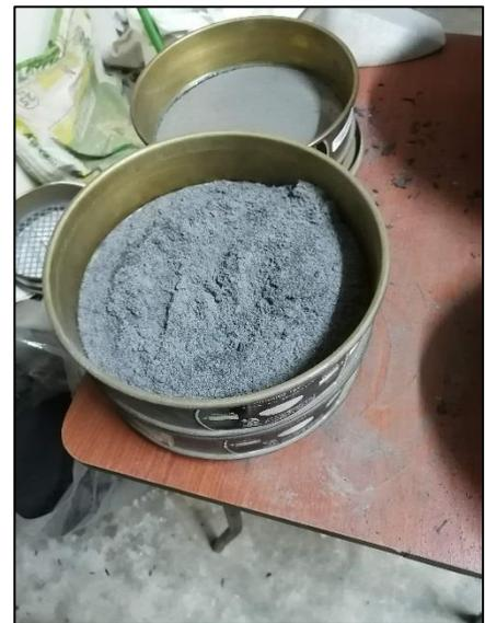
**Imagen N°27:** Una vez terminada el proceso de tamización se obtuvo las dos cantidades faltantes para la sustitución de cenizas de maíz por cemento, estas cantidades han salido de la segunda y tercera recolección. Los pesos arrojados de las cenizas de maíz son las siguientes: 800 gr, 1190 gr y 1910 gr.
