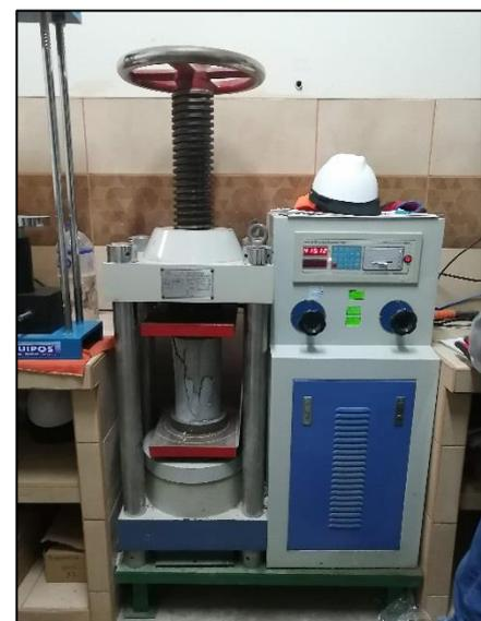
**Imagen N°82:** Se aprecia la realización del ensayo a la compresión. Se muestran las probetas que han sido ensayadas a compresión y su tipo de fallas.
