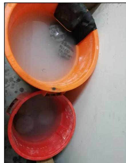
**Imagen N°67:** En la siguiente imagen podemos apreciar el curado de probetas de concreto. En esta imagen se encuentran las probetas del concreto experimental con el 5%, 7.5% y 12% de sustitución de maíz por cemento, y han sido puestas a curar al día siguiente de muestreadas e inmediatamente después de haber sido desencofradas.
