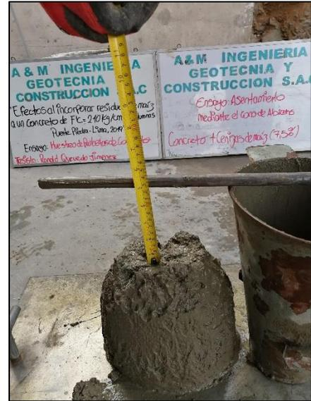
**Imagen N°53:** Una vez preparada la mezcla de concreto se procede a realizar el ensayo del asentamiento mediante el cono de Abrams. En la imagen se aprecia el ensayo de asentamiento para el concreto experimental del 12% de sustitución de cenizas de maíz por cemento.
