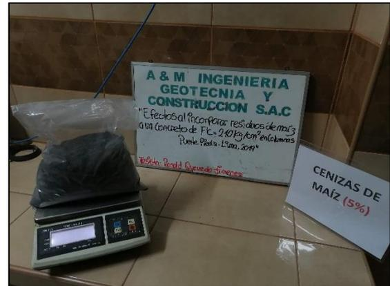
**Imagen N°44:** Para el concreto experimental con el 7.5% de sustitución de cenizas de maíz por cemento se tiene una cantidad de 1190 gr.
