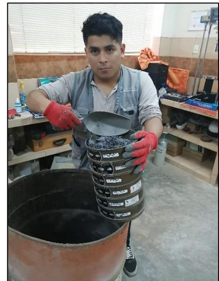
**Imagen N°24:** Una vez puesto el material en la malla principal, se pone la tapa a los tamices y se empieza con los movimientos circulares que caracterizan al tamizado.
