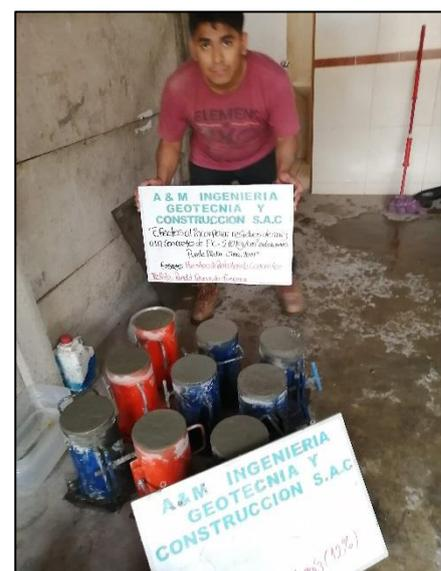
**Imagen N°61:** Se puede apreciar una imagen panorámica del muestreo de los especímenes cilíndricos de concreto. El primer muestreo que se realizó fue el del concreto patrón, luego se muestreo el concreto experimental con el 5% de sustitución de cenizas de maíz por cemento y por último se muestreo el concreto experimental con el 7.5% y 12% de sustitución de cenizas de maíz por cemento. Todos los muestreos se realizaron en días diferentes.
