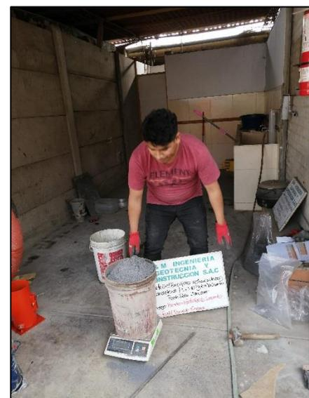
**Imagen N°49:** Una vez preparada la mezcla de concreto se procede a realizar el ensayo del asentamiento mediante el cono de Abrams. En la imagen se aprecia el ensayo de asentamiento para el concreto experimental del 5% de sustitución de cenizas de maíz por cemento.
