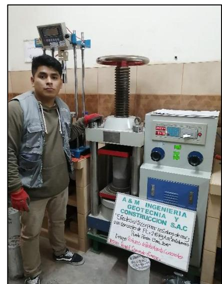
**Imagen N°76:** Se aprecia la realización del ensayo a la compresión. Una vez asegurada la probeta de concreto, procedemos a ejercer un esfuerzo de compresión constante a la probeta y se va a detener el ensayo cuando esta probeta falle, para poder determinar su  $F'c$ . Se aprecia la rotura de la probeta y el tipo de falla que tiene esta es tipo cono.
