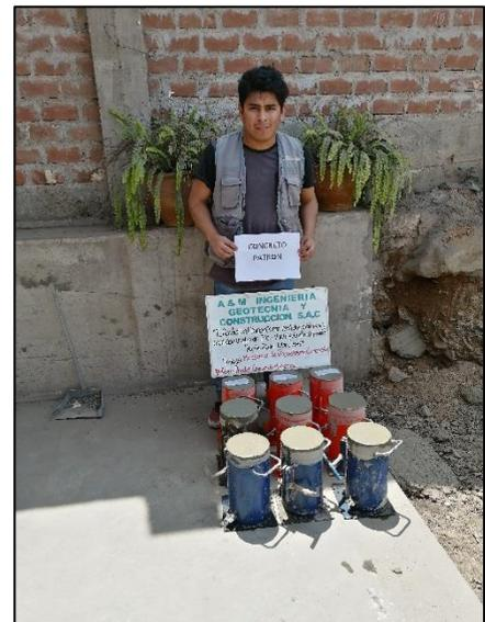
**Imagen N°57:** Podemos apreciar en la imagen 09 probetas que pertenecen al concreto patrón y han sido debidamente identificadas. Las edades a ensayar las probetas serán a los 07, 14 y 28 días, es por ello que para cada edad le pertenecen 03 probetas de concreto.
