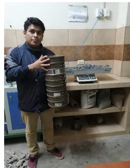
**Imagen N°19:** Una vez acabado el proceso de tamización, se procede a realizar el pesaje de las cenizas de maíz que van a ser utilizadas para la sustitución de cemento por estas cenizas. En este caso la primera recolección de hojas de maíz arrojó un valor de 455gr de cenizas.
