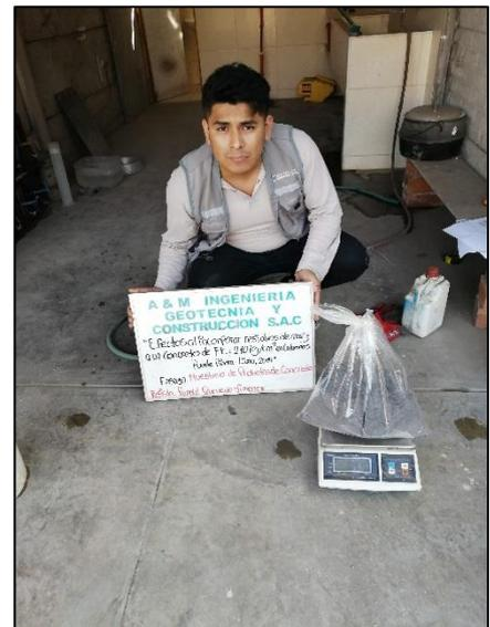
**Imagen N°45:** Para el concreto experimental con el 12% de sustitución de cenizas de maíz por cemento se tiene una cantidad de 1910 gr.
