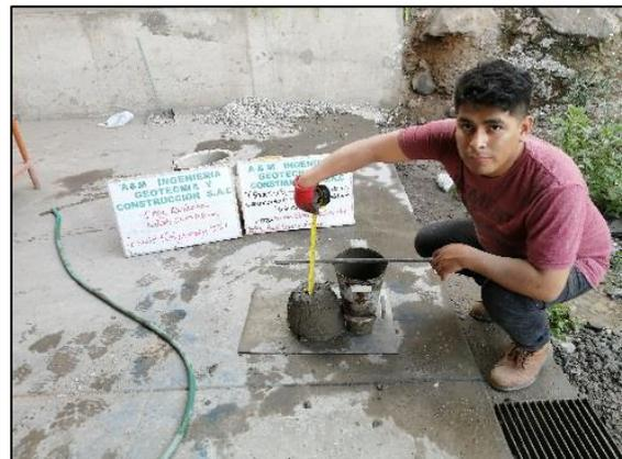
**Imagen N°54:** Se observa en la imagen el resultado de asentamiento obtenido para el concreto experimental del 12% de sustitución de cenizas de maíz por cemento es de 3.9”.
