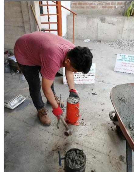
**Imagen N°65:** Continuando con los trabajos de ensayos al concreto, se muestra el proceso que se aplicó para ensayar los especímenes cilíndricos de concreto.
