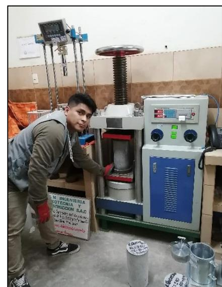
**Imagen N°73:** Se aprecia la realización del ensayo a la compresión, se comienza a asegurar la probeta de concreta.
