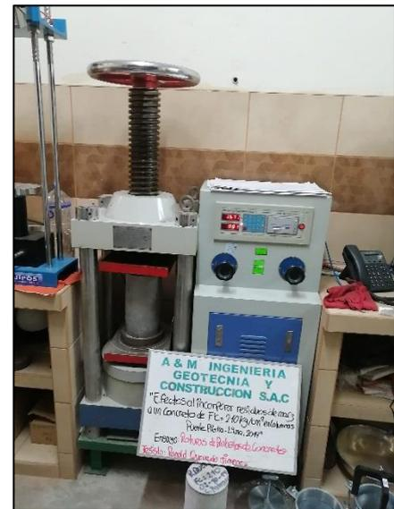
**Imagen N°78:** Se aprecia los resultados obtenidos de las resistencias a la compresión para el concreto patrón, estos valores arrojados por la prensa hidráulica están en kN, lo cual en el informe han sido convertidos a Kg/cm<sup>2</sup>.
