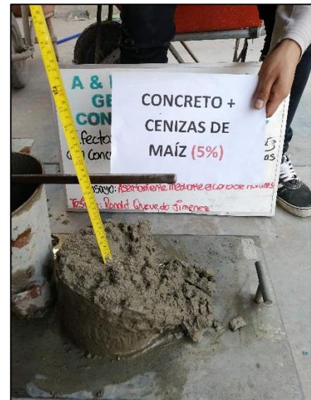
**Imagen N°51:** Una vez preparada la mezcla de concreto se procede a realizar el ensayo del asentamiento mediante el cono de Abrams. En la imagen se aprecia el ensayo de asentamiento para el concreto experimental del 7.5% de sustitución de cenizas de maíz por cemento.
