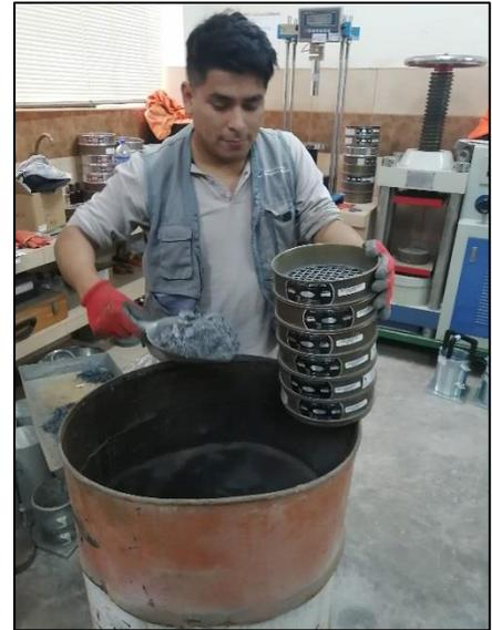
**Imagen N°23:** Se aprecia los pasos que se realizaron para el tamizado de las cenizas de maíz. En esta imagen se ve que utiliza el cucharón para sacar el material y ponerlas sobre la malla principal.
