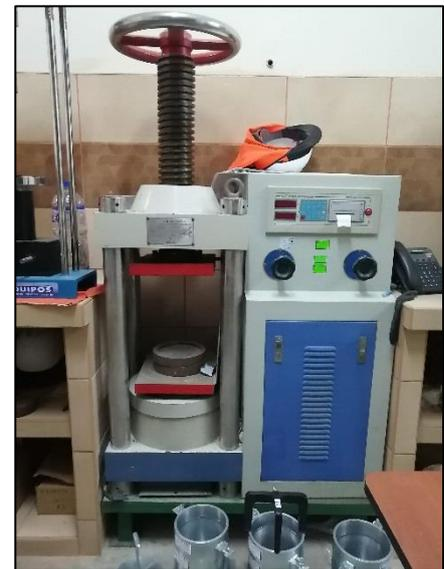
**Imagen N°69:** Continuamos con el ensayo de resistencia a la compresión para las probetas de concreto patrón, se puede observar el proceso de colocación de las bases o tapas de almohadillas de neopreno para así obtener una superficie plana en la parte superior e inferior de la probeta de concreto para poder ensayarlo.
