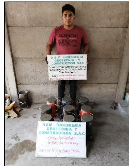
**Imagen N°60:** Una vez aceptada la mezcla del concreto experimental del 12% de sustitución de cenizas de maíz por cemento mediante el ensayo del slump, se procede a ensayar los especímenes cilíndricos de concreto como se puede apreciar en la imagen. Las edades a ensayar las probetas serán a los 07, 14 y 28 días.
