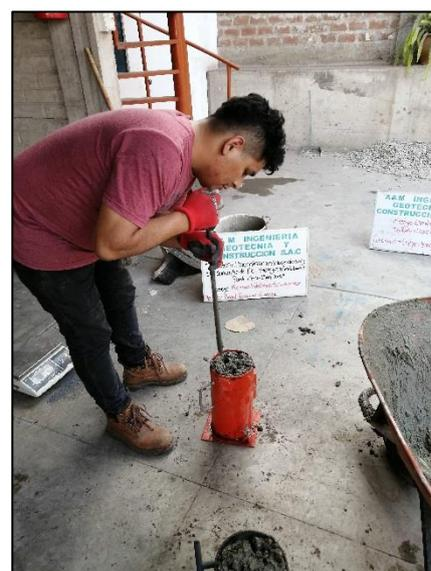
**Imagen N°64:** Continuando con los trabajos de ensayos al concreto, se muestra el proceso que se aplicó para ensayar los especímenes cilíndricos de concreto.
