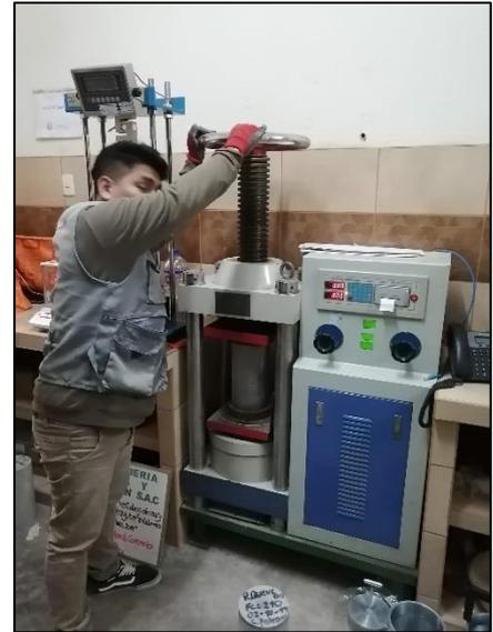
**Imagen N°74:** Se aprecia la realización del ensayo a la compresión.
