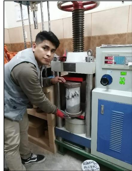
**Imagen N°77:** Se aprecia la realización del ensayo a la compresión.
