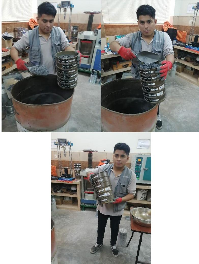
*Figura 15:* Proceso de tamizado de las cenizas de maíz
