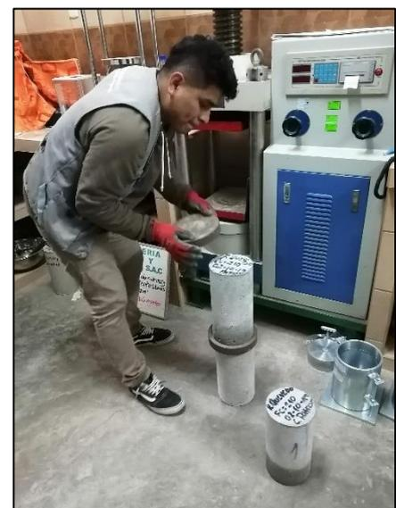
**Imagen N°70:** Se aprecia la realización del ensayo a la compresión, se termina la colocación de la tapa de almohadilla de neopreno en la parte superior de la probeta.
