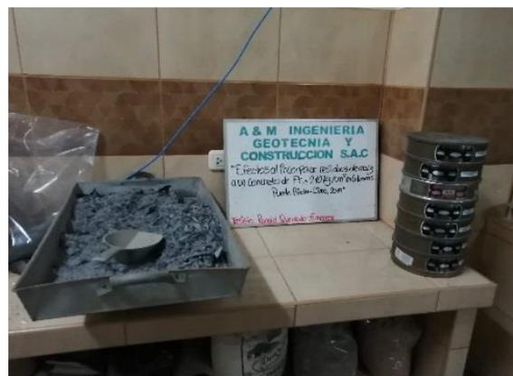
**Imagen N°16:** Se procede a realizar el tamizado de las cenizas de maíz como se puede apreciar en la imagen.
