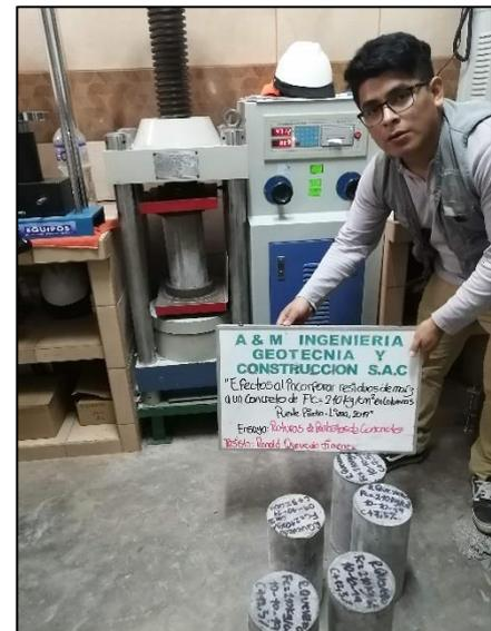
**Imagen N°81:** Se aprecia la realización del ensayo a la compresión. Podemos observar la rotura de la probeta de los concretos experimentales y el tipo de falla que tiene esta es tipo columnar.
