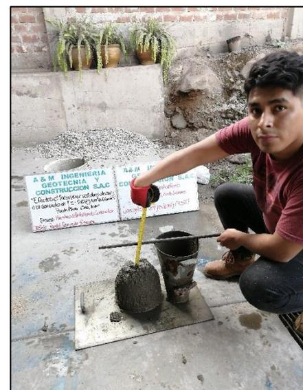
**Imagen N°52:** Se observa en la imagen el resultado de asentamiento obtenido para el concreto experimental del 7.5% de sustitución de cenizas de maíz por cemento es de 3.8”.
