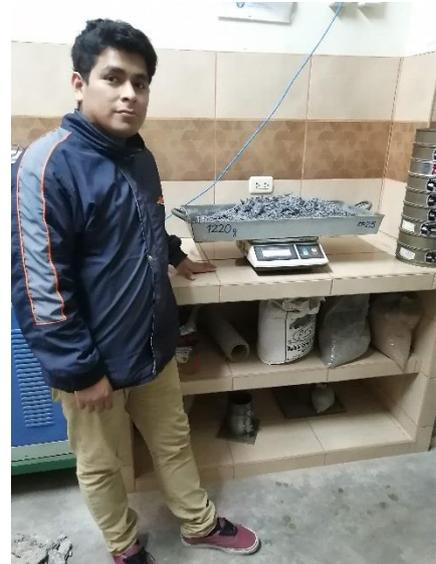
**Imagen N°15:** Se puede apreciar en la imagen las cenizas de maíz obtenidas a través del proceso de incineración y los tamices por las cuales se pasarán para así obtener un material más fino y parecido al cemento.
