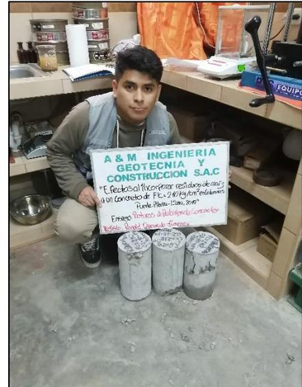
**Imagen N°80:** Se aprecia la realización del ensayo a la compresión, se comienza con las roturas de probetas de los concretos experimentales.
