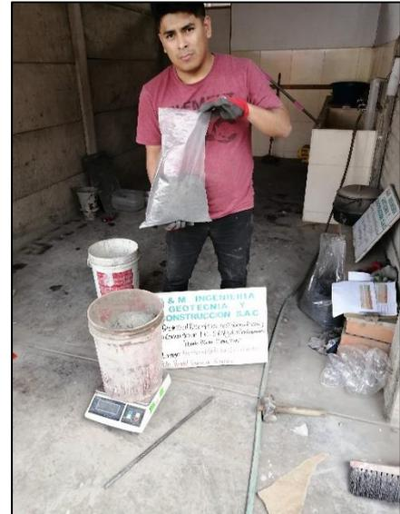
**Imagen N°47:** Se realiza la sustitución de las cenizas de maíz por cemento como se observa en la imagen, las cantidades sustituidas de cenizas de maíz están de acuerdo a lo establecido en el diseño de mezcla para cada concreto
