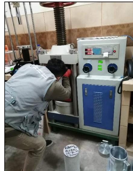
**Imagen N°72:** Se aprecia la realización del ensayo a la compresión, se toma las precauciones de caso antes de que la probeta sea ensayada, se debe procurar que la probeta esta correctamente centrada en la prensa hidráulica.
