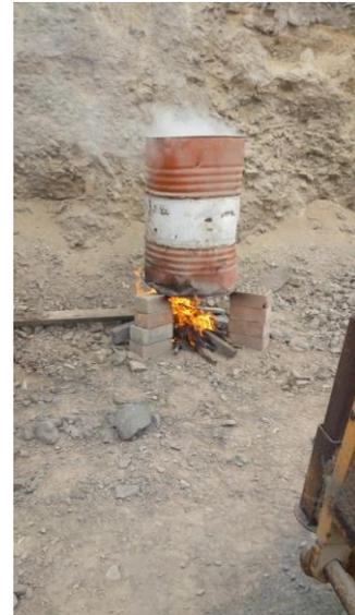
**Imagen N°12:** Una vez incinerada las hojas de maíz obtenemos las cenizas de maíz que son el objeto de estudio para nuestra investigación, ya que van a ser usadas para la sustitución del cemento por estas cenizas.
