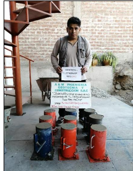
**Imagen N°59:** Una vez aceptada la mezcla del concreto experimental del 7.5% de sustitución de cenizas de maíz por cemento mediante el ensayo del slump, se procede a ensayar los especímenes cilíndricos de concreto como se puede apreciar en la imagen. Las edades a ensayar las probetas serán a los 07, 14 y 28 días.
