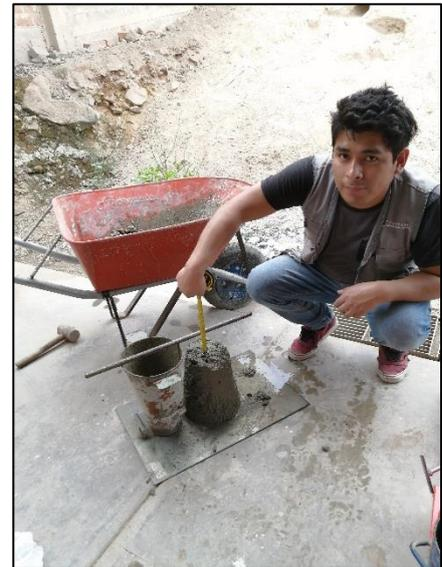
**Imagen N°42:** Se observa en la imagen el resultado de asentamiento obtenido para el concreto patrón que es de 3”.
