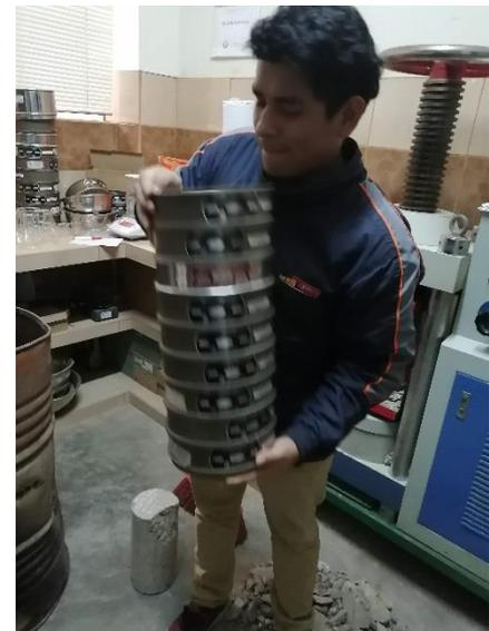
**Imagen N°18:** Se muestra una imagen panorámica del tamizado que se viene dando a las cenizas de hojas de maíz, el tamizado se realiza para hallar la malla en la que se obtiene el mayor porcentaje retenido de cenizas de maíz.
