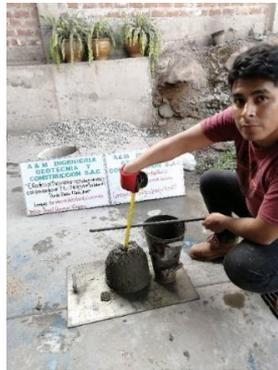
*Figura 19:* Elaboración del Ensayo del Slump
