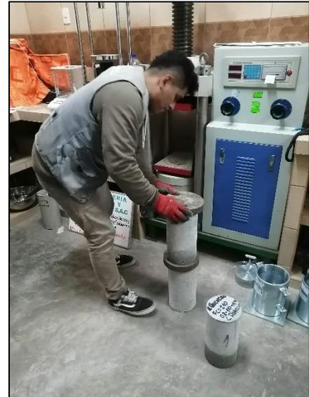
**Imagen N°71:** Se aprecia la realización del ensayo a la compresión, se procede a la colocación de la probeta de concreto a la prensa hidráulica.
