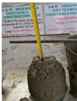
*Figura 20:* Medición del asentamiento (Ensayo del Slump)
