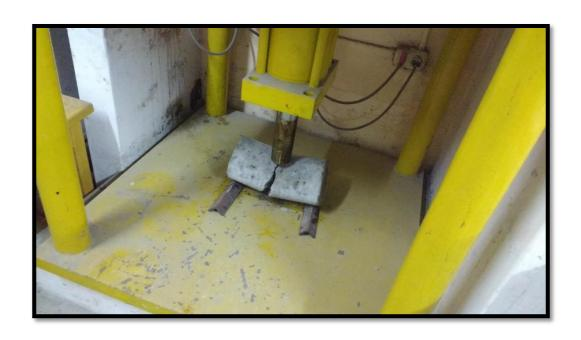
FOTO N° 14: Se Observa las probetas endurecidas por ensayar.
