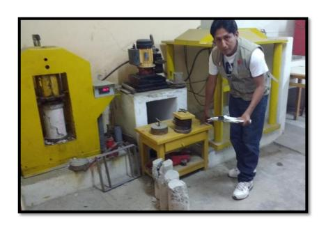
FOTO N° 12: Equipo para ensayo de durabilidad (Balde Hidráulico), La presión de agua para dicho ensayo es de 100 libras /plg2.
