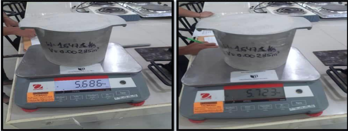
Fotografía N°9: Pesado del agregado compactado (romerillo).
