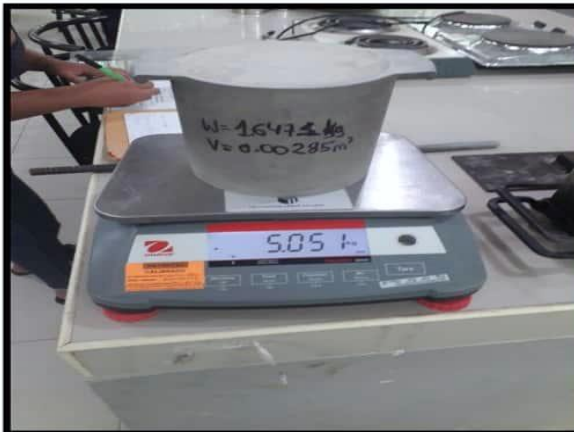
Fotografía N°8: Pesado del agregado suelto (romerillo).
