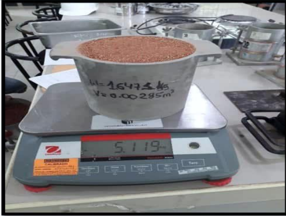
Fotografía N°11: Pesado del agregado suelto (arcilla).
