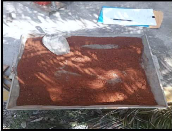
Fotografía N° 33 y 34: Se procede a Mezclar la masa con arcilla, romerillo y agua para fabricar los ladrillos.
