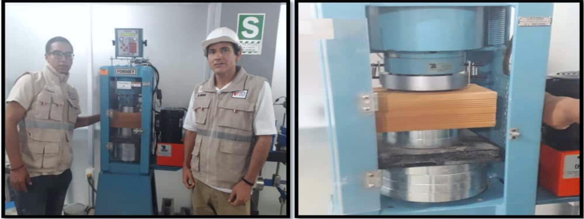
Fotografía N° 45 y 46: Rotura a los 7 y 14 días de edad.
