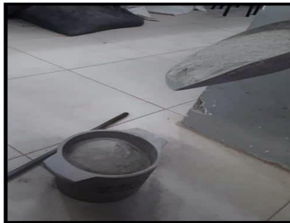
Fotografía N°4: Llenado del recipiente con el agregado (Peso Unitario Suelto).
