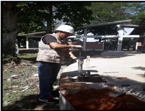
Fotografía N°35 y 36: Se realiza la Fabricación de ladrillos con la masa preparada utilizando el molde. Realizando golpes para aplanar el material; en capas delgadas para su compresión.
