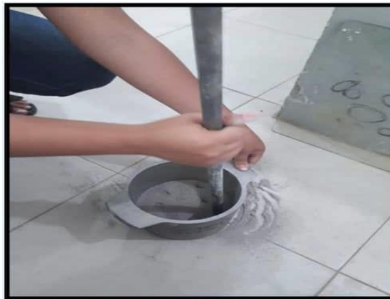
Fotografía N°6: Apisonado del Romerillo (Peso Unitario Compactado).
