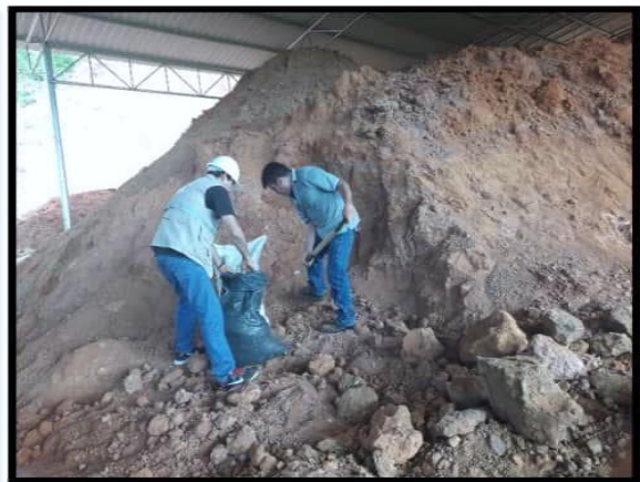
Fotografía N° 19 y 20: Extracción del material: (arcilla Roja) de la fábrica de ladrillo de arcilla Bello Horizonte Tarapoto.
