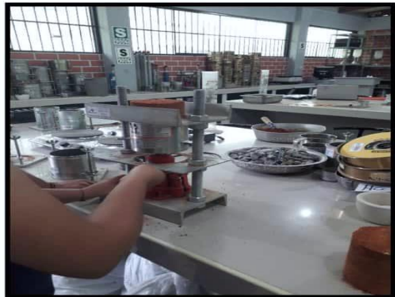
Fotografía N°14: Pesando la arcilla en la balanza y realizando el prensado
