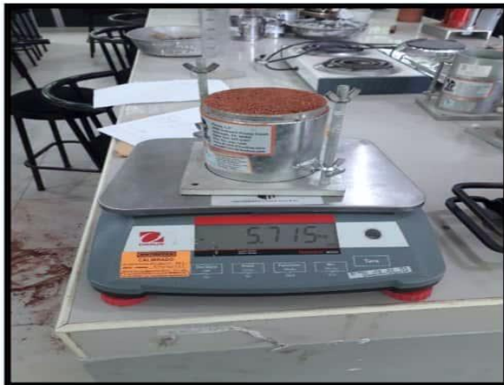
Fotografía N°14: Pesando la arcilla en la balanza y realizando el prensado
