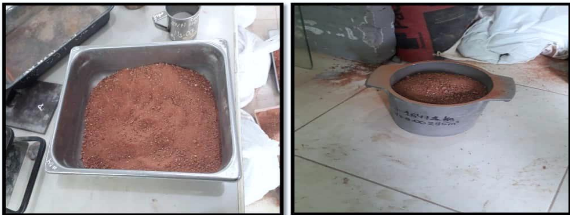
Fotografía N°10: Llenado de La arcilla en capas.
