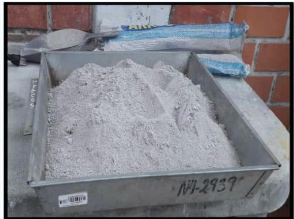
Fotografía N° 27, 28: Se procede a pesar la arcilla y romerillo según diseño de mezcla.
