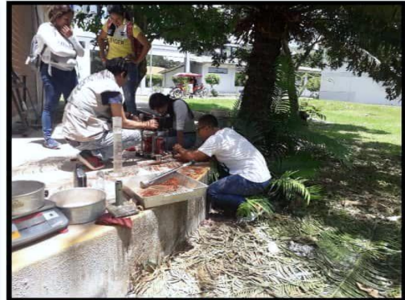
Fotografía N°35 y 36: Se realiza la Fabricación de ladrillos con la masa preparada utilizando el molde. Realizando golpes para aplanar el material; en capas delgadas para su compresión.
