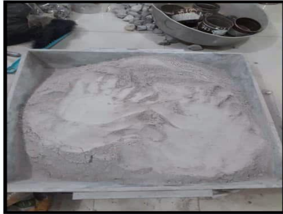
Fotografía N°1: Colocamos el material sacado del horno a enfriar.
