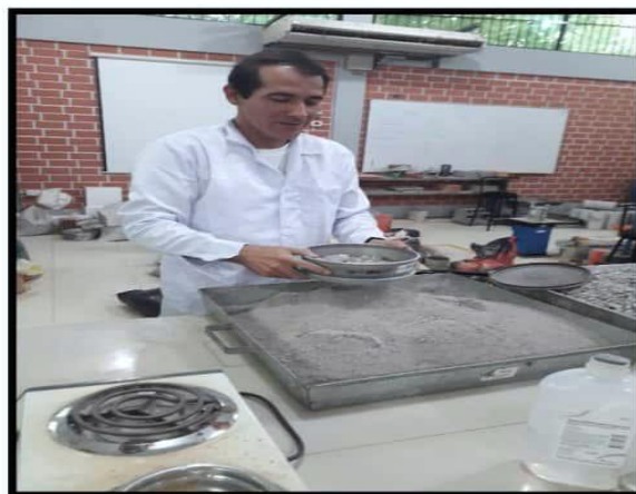
Fotografía N°2: Colocación del material y empezar a zarandear.
