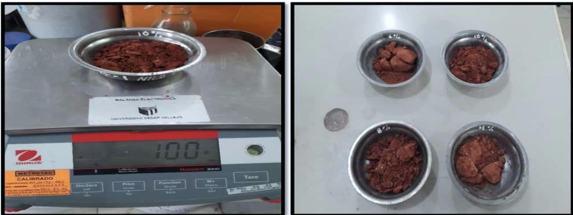
Fotografía N°16: Ensayo de peso de arcilla en la balanza.
