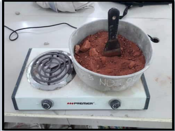
Fotografía N° 21,22, 23 ,24: Se prepara la arcilla pasando por un proceso de secado, chancado, tamizado o cernido en malla N° 30.
