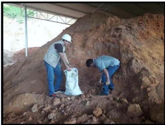
Fotografía N° 19 y 20: Extracción del material: (arcilla Roja) de la fábrica de ladrillo de arcilla Bello Horizonte Tarapoto.
