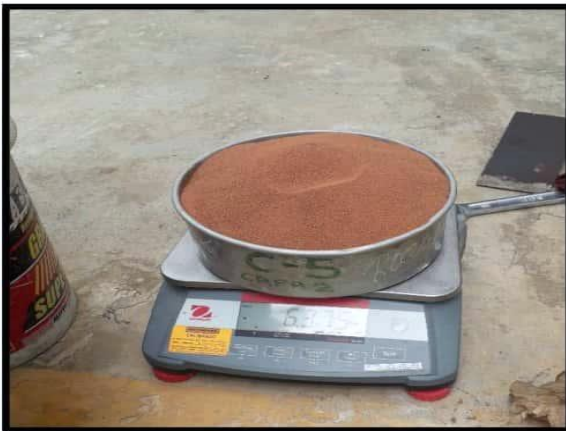
Fotografía N° 27, 28: Se procede a pesar la arcilla y romerillo según diseño de mezcla.
