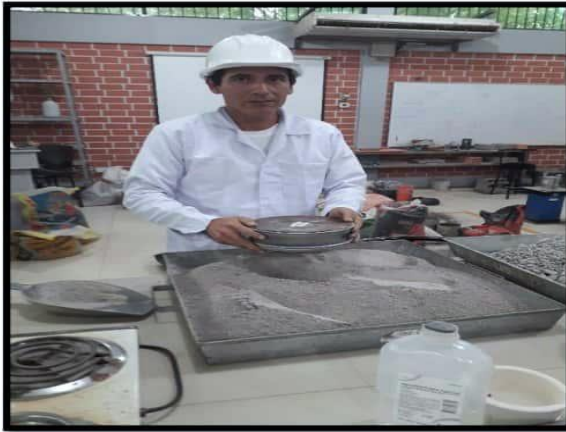
Fotografía N° 25, 26: Se prepara el mineral no metálico (romerillo) pasando por un proceso de tamizado o cernido en malla N° 30.
