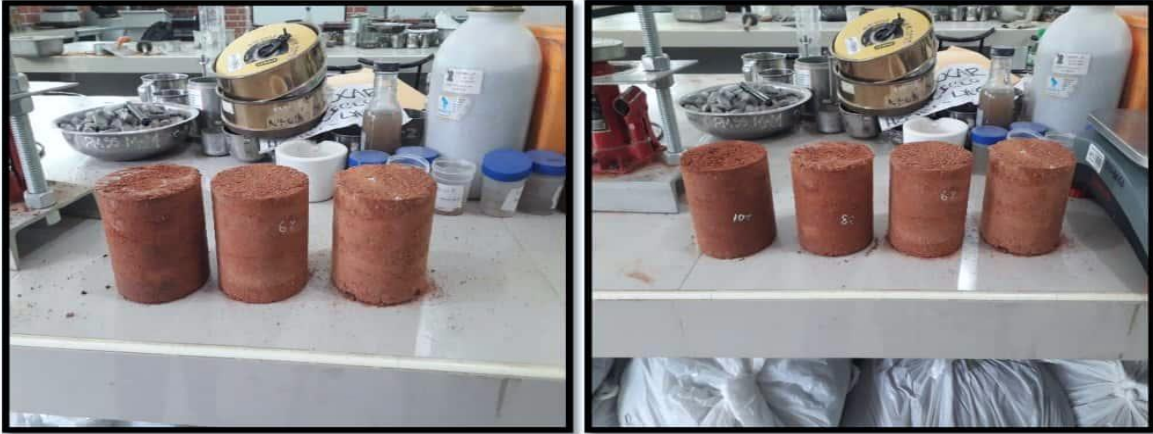
Fotografía N°15: Arcilla ya prensado para su secado
