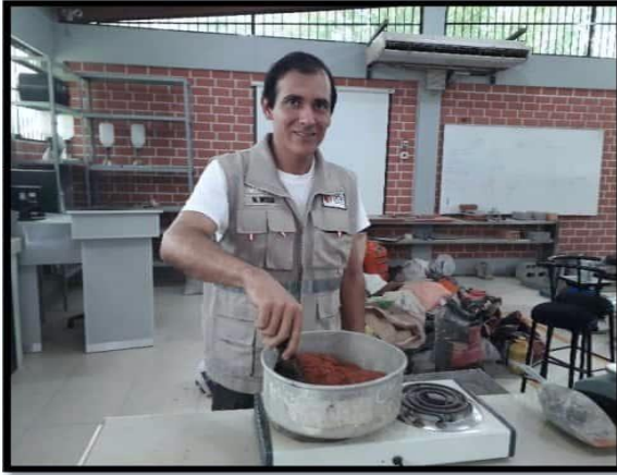
Fotografía N° 21,22, 23 ,24: Se prepara la arcilla pasando por un proceso de secado, chancado, tamizado o cernido en malla N° 30.
