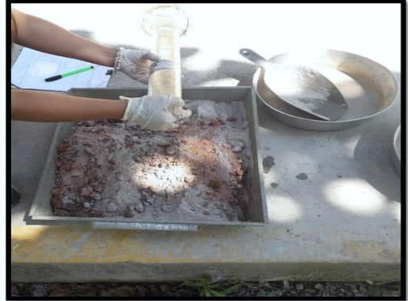
Fotografía N° 33 y 34: Se procede a Mezclar la masa con arcilla, romerillo y agua para fabricar los ladrillos.
