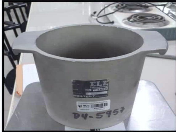
Fotografía N°3: Recipiente para hacer el ensayo de peso unitario del romerillo.
