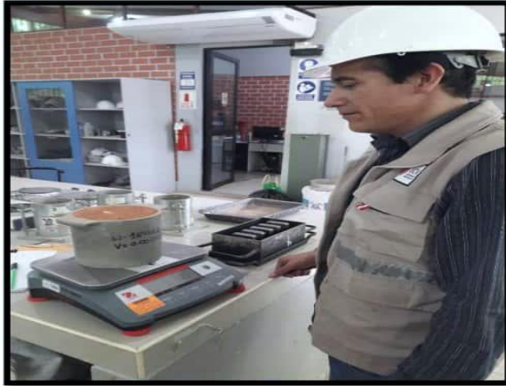
Fotografía N°13: Pesando la arcilla en la balanza
