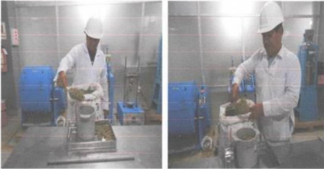
Figura N° 53 y 54: Compactación de la arcilla expandida en tres capas con 25 golpes cada uno, y el pesado del molde + material.
