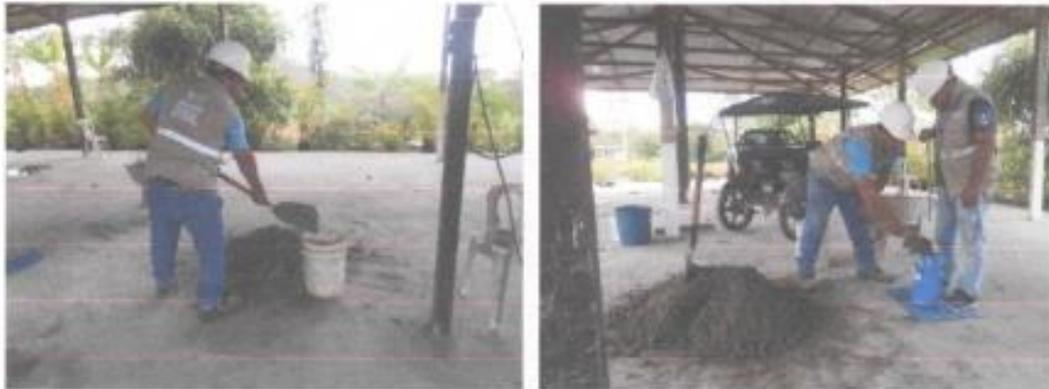
Figura N° 61 y 62: Ensayo de consistencia o Slump test.
