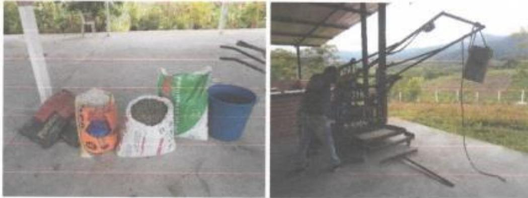
Figura N° 55 y 56: Pesaje de los materiales (Arcilla expandida, Cemento) para la elaboración del bloque de concreto.
