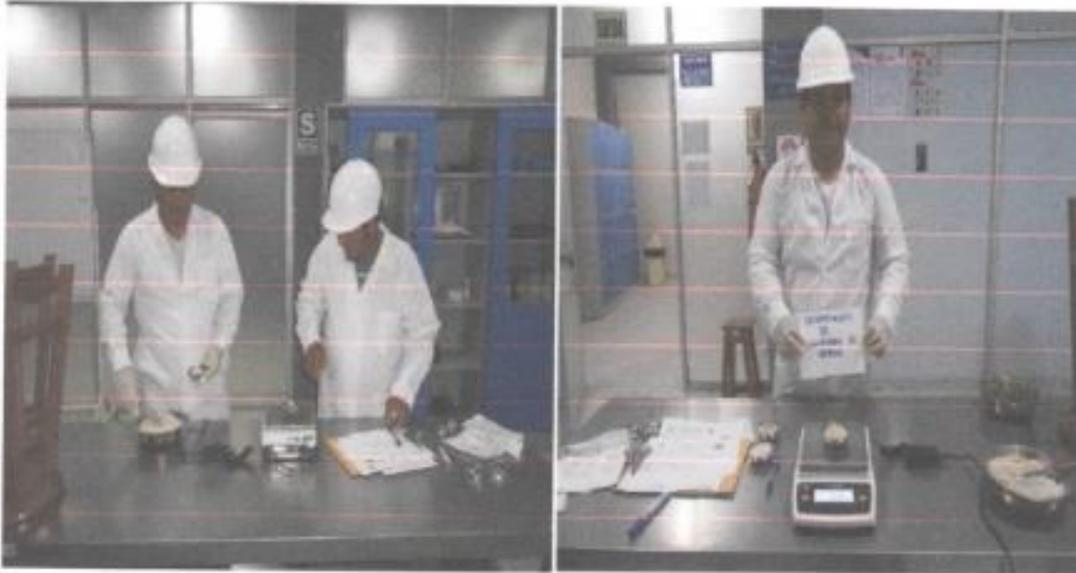
Figura N° 07 y 08: Proceso de secado del agregado fino a 110 °C, durante 24 horas.
