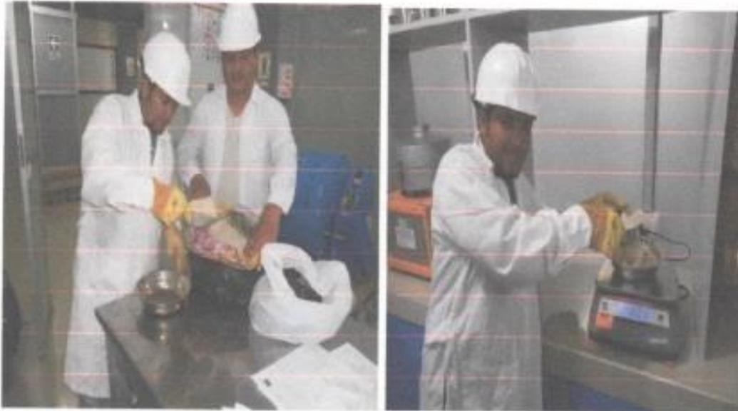
Figura N° 12 y 13: Proceso de saturación del agregado fino.
