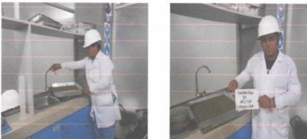
Lavado y secado del agregado fino y agregado grueso (arcilla expandida).
