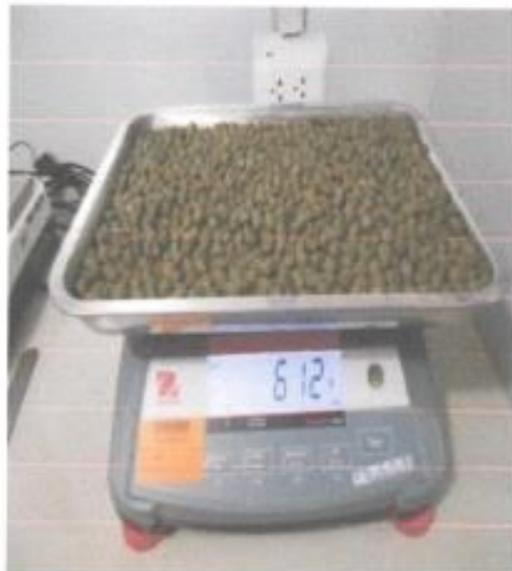
Figura N° 42 y 43: Proceso de pesado después que paso las 24 horas y posterior mente el secado del agregado grueso con papel absorbente.
