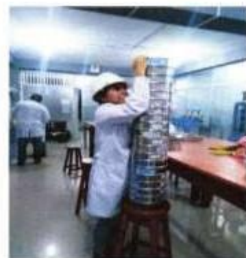
Vista N°16: Procedimiento para el ensayo de Análisis granulométrico por tamizado del agregado grueso.
