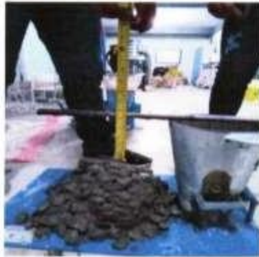
Vista N° 22: Procedimiento para el ensayo de asentamiento del cono de Abrams.
