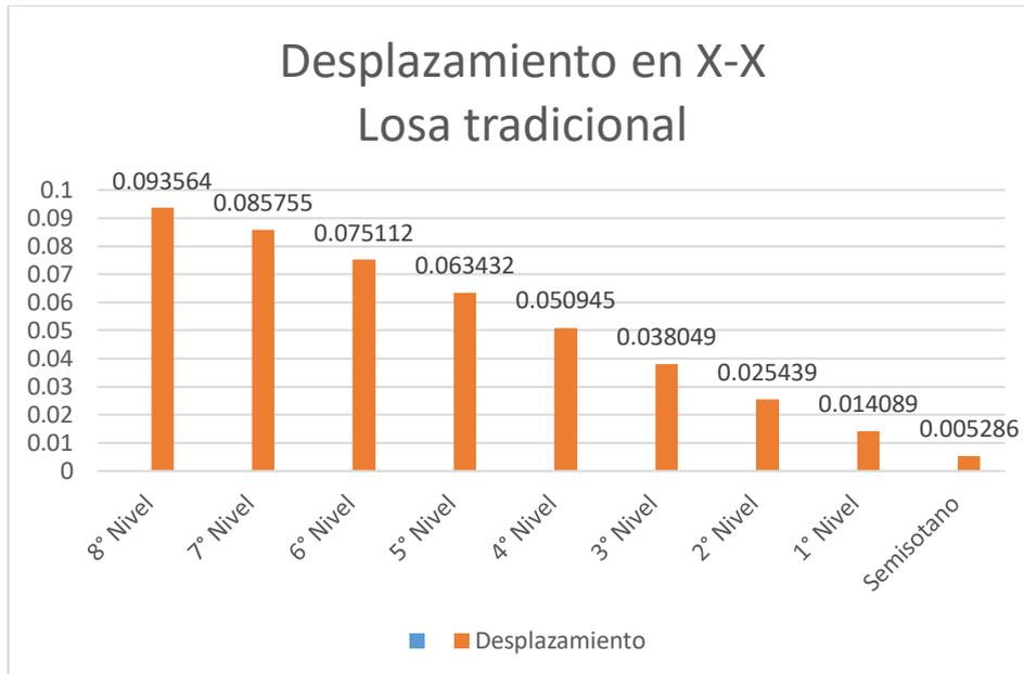
**Figura 13 Desplazamientos en X-X**
