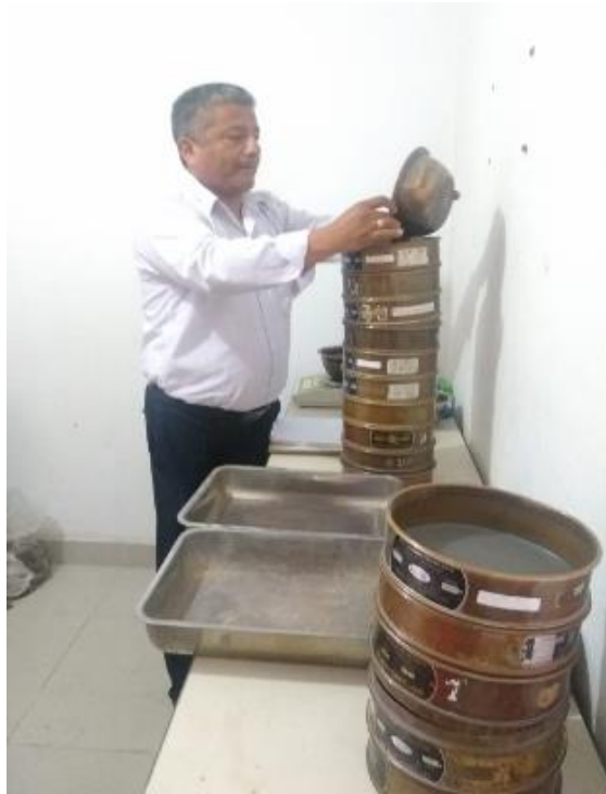
Figura 65. Material al proceso de tamización
