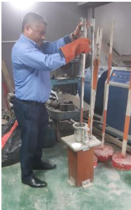
Figura 70. Golpes en la muestra de estudio con 3 capas.
