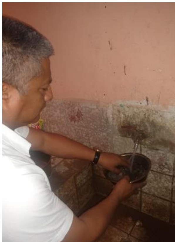
Figura 64. Material en presencia del agua para la disolución y desprendimiento
