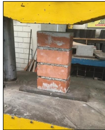
Figura 36. Montaje de pilas de k.k.18 huecos
