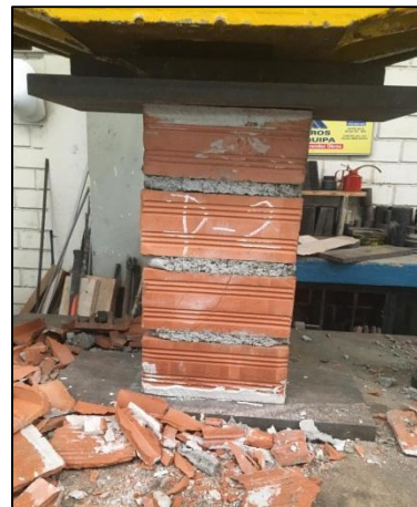
Figura 45. Montaje de pilas tubulares
