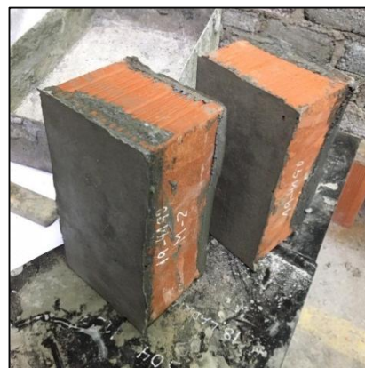
Figura 24. Refrentado terminado en unidades de k.k.18 huecos
