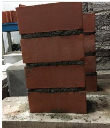
Figura 34. Pilas k.k.18 huecos
