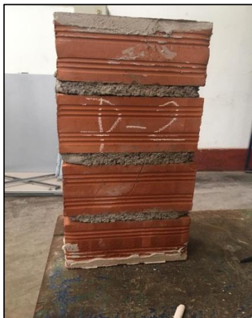
Figura 44. Refrentado en pilas tubulares
