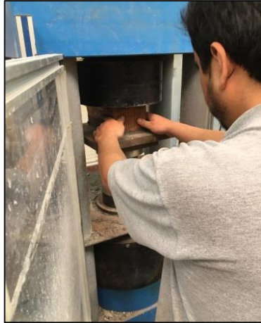
Figura 25. Colocación de las unidades antes de realizar el ensayo de compresión
