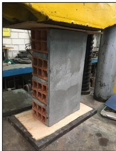
Figura 53. Montaje de pilas tubulares
