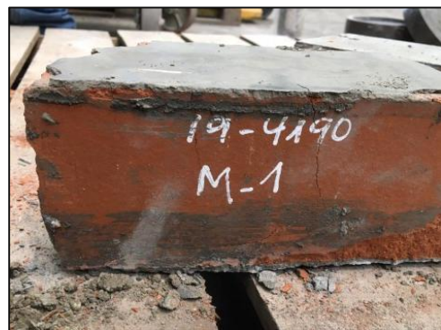
Figura 28. Falla de trituración en unidades de k.k.18 huecos
