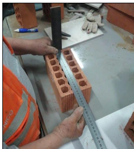
Figura 19. Variación dimensional en las unidades de k.k.18 huecos
