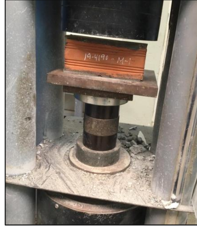
Figura 31. Ensayo de compresión axial en unidades tubulares
