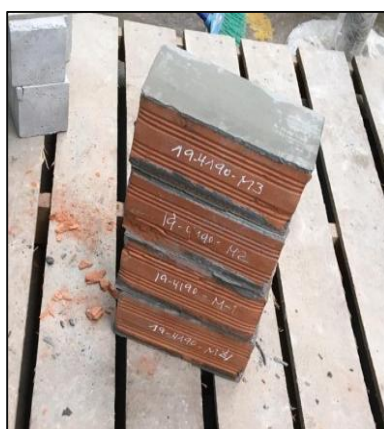
Figura 29. Refrentado en unidades tubulares
