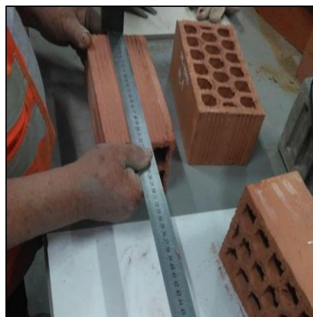
Figura 20. Variación dimensional de la unidad de albañilería tubular
