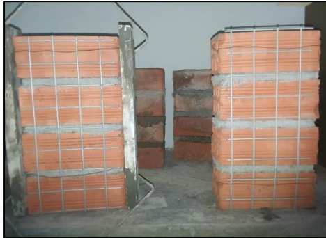
Figura 51. Reforzamiento de pilas tubulares
