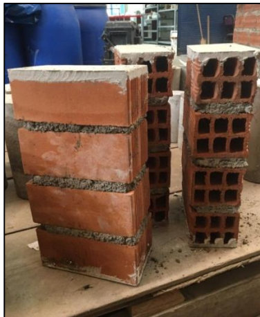
Figura 35. Refrentado en pilas
