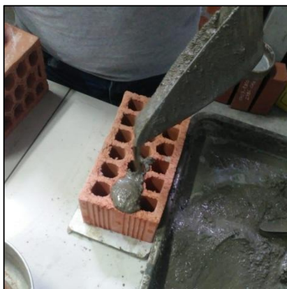
Figura 23. Refrentado inicial en unidades de k.k.18 huecos
