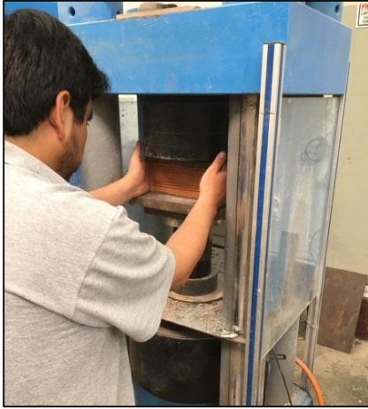
Figura 30. Colocación de las unidades antes de realizar el ensayo de compresión
